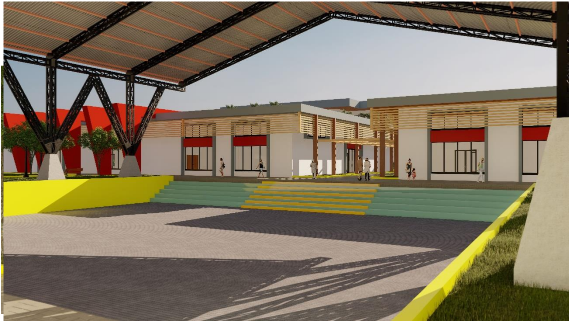
Vista 3D. Exteriores CANCHA DEPORTIVA CON DADOS DE MORTERO ARMADO Y ACERO INOXIDABLE TRIANGULAR PARA EL ZOPORTE ESTRUCTURAL DE LA COBERTURA
