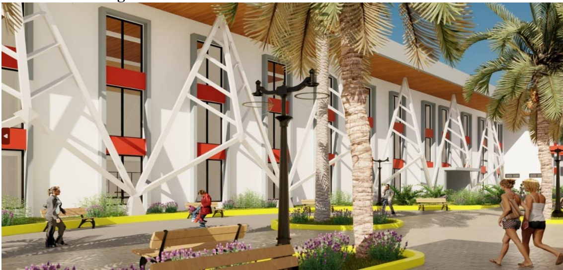
Figura 163. Protectores Solares en Fachadas Laterales.
