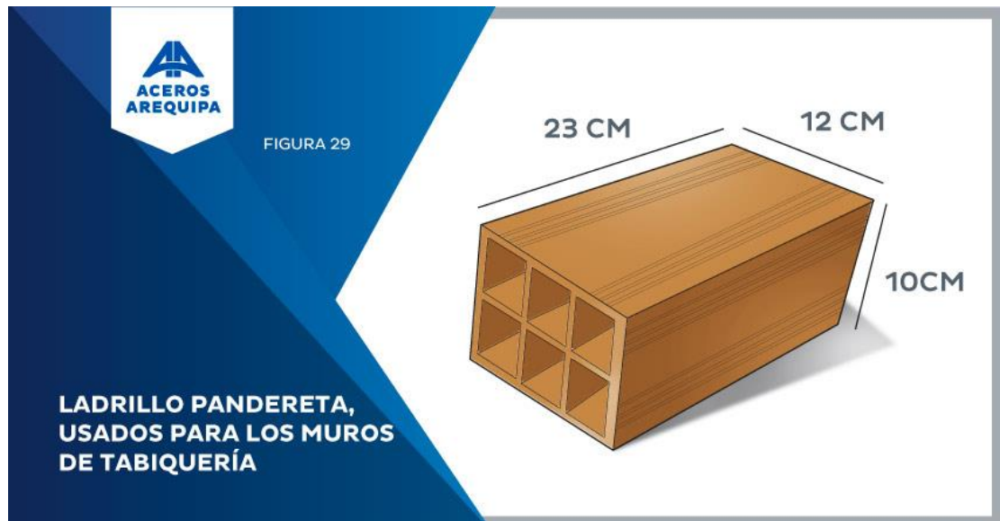
Gráfico 23.- Dimensiones del ladrillo pandereta. Fuente: https://acerosarequipa.com
