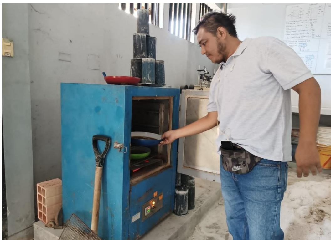
Imagen 3 Secado del agregado fino en la estufa.
