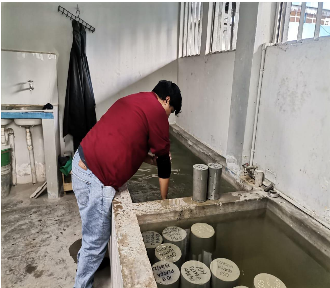
Imagen 8 Extracción de los especímenes de concreto del proceso de curado.
