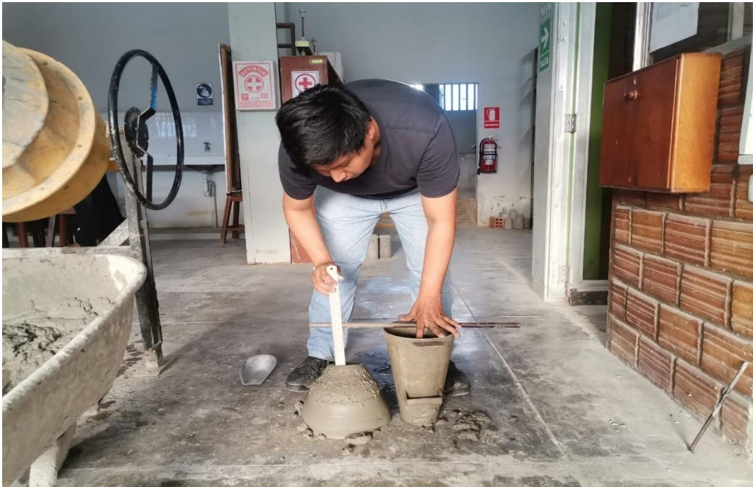
Imagen 6 Prueba de consistencia o (SLUMP)
