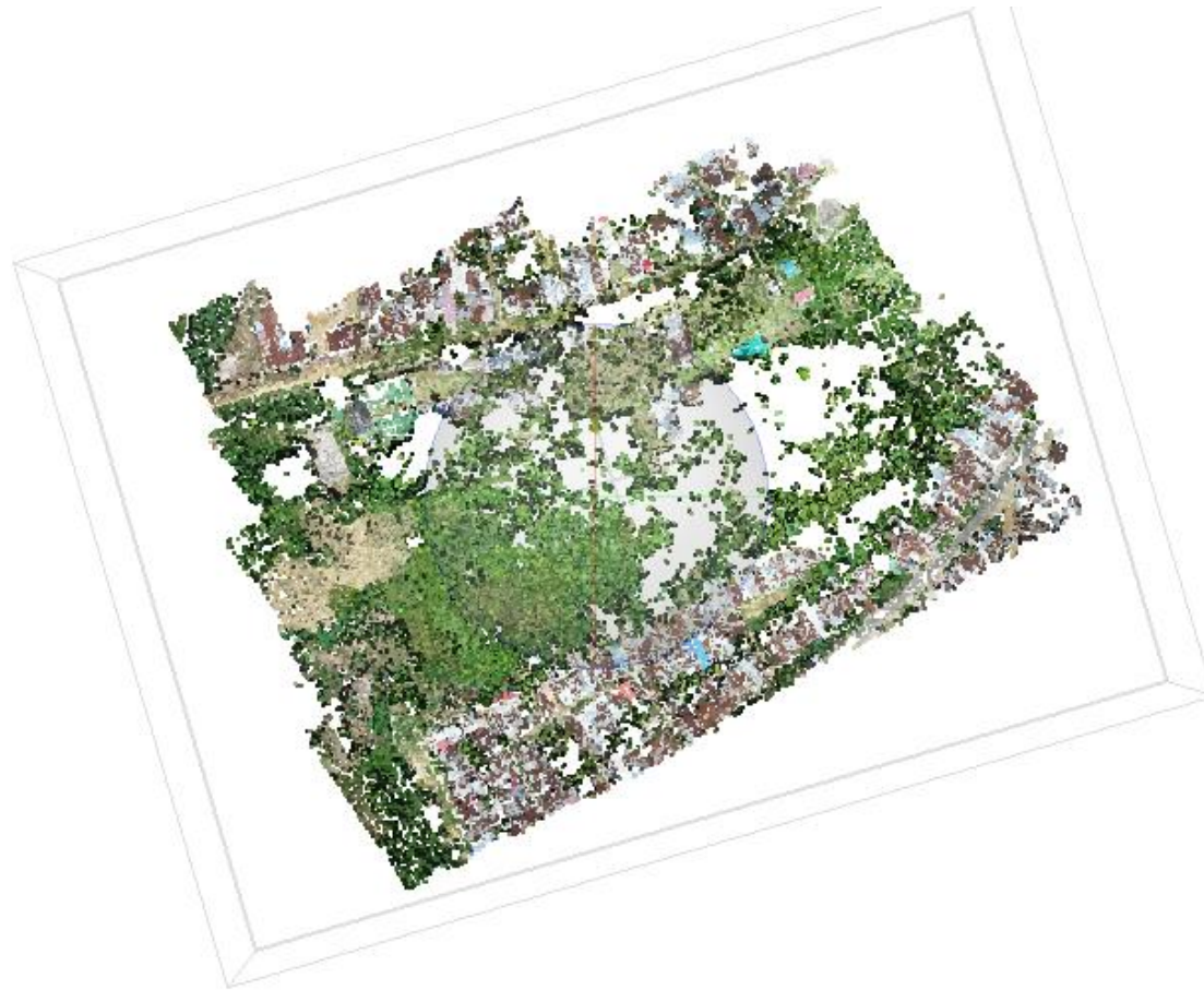
Gráfico 6:- Nube de puntos obtenidas con el drone
