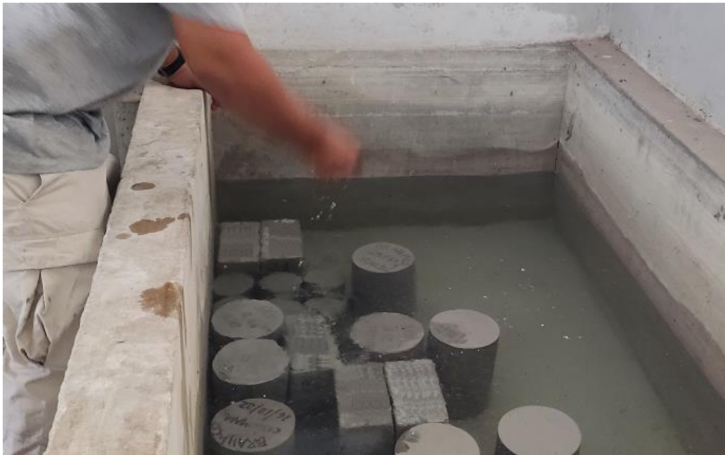
Foto N° 31 : Ensayos de Absorción de los Ladrillos, en Laboratorio de Mecánica de Suelos y Ensayo de Materiales de la UCP.
