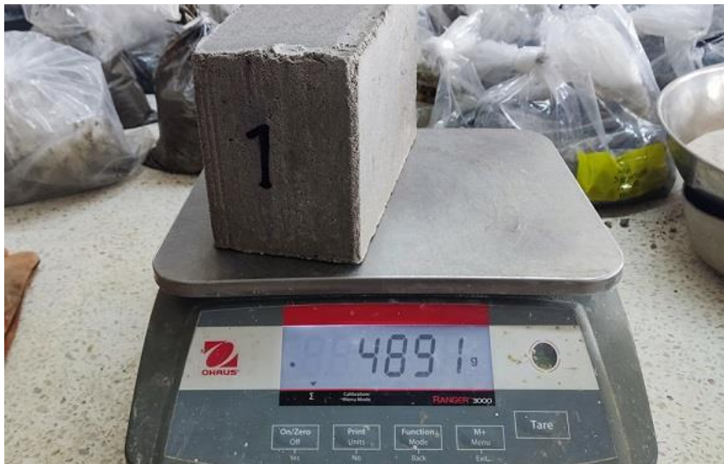
Foto N° 33 : Pesaje de los Ladrillos, realizados en Laboratorio de Mecánica de Suelos y Ensayo de Materiales de la UCP.
