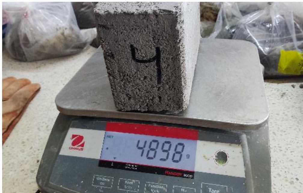
Foto N° 34 : Pesaje de los Ladrillos, realizados en Laboratorio de Mecánica de Suelos y Ensayo de Materiales de la UCP.
