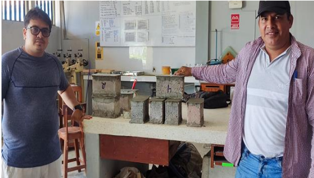
Foto N° 35 : Ladrillos Preparados para el Ensayo de Compresión en Laboratorio de Mecánica de Suelos y Ensayo de Materiales de la UCP.
