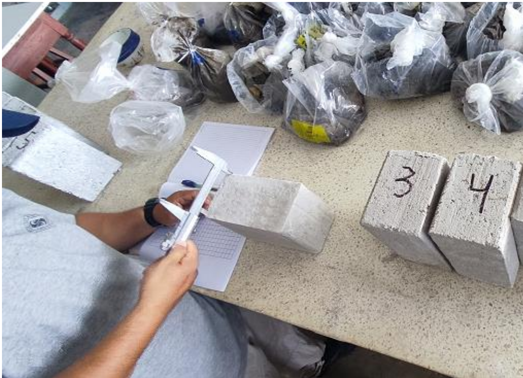
Foto N° 27 : Medición de los Ladrillos Fabricados; Laboratorio de Mecánica de Suelos y Ensayo de Materiales de la UCP.
