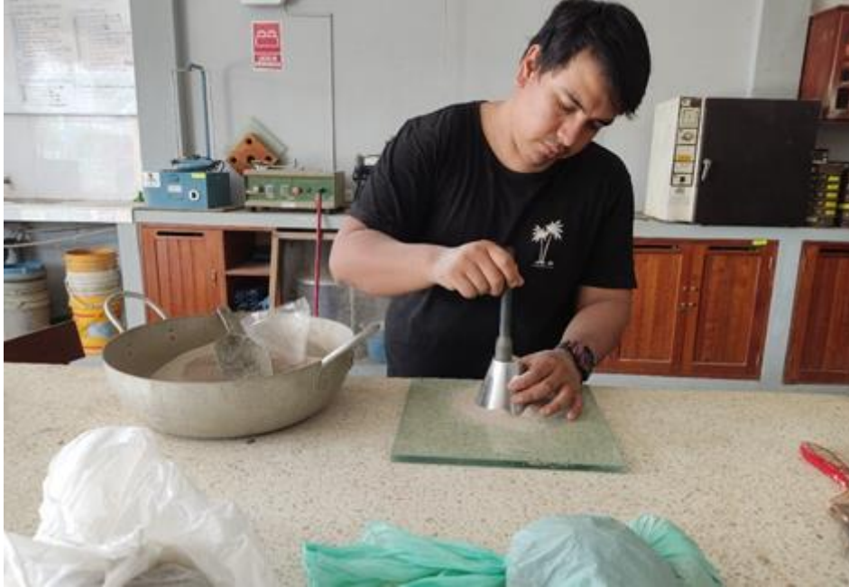
Foto N° 05 : Ensayo en Laboratorio de la UCP – Gravedad Especifica y Absorción del Agregado Fino para la Elaboración del Ladrillo.
