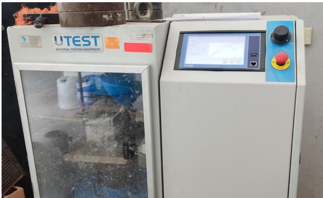
Foto N° 38 : Equipo de Prueba de Rotura de Ladrillos para el Ensayo de Compresión en Laboratorio de Mecánica de Suelos y Ensayo de Materiales de la UCP.
