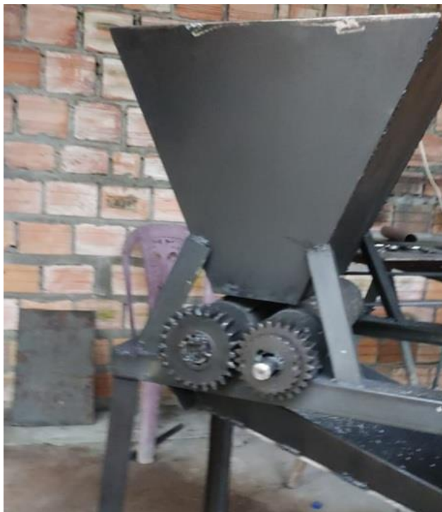
Foto N° 15 : Trituradora de Mandíbula para la obtención de los residuos de tarrajeo al tamaño óptimo, para la Elaboración del Ladrillo.
