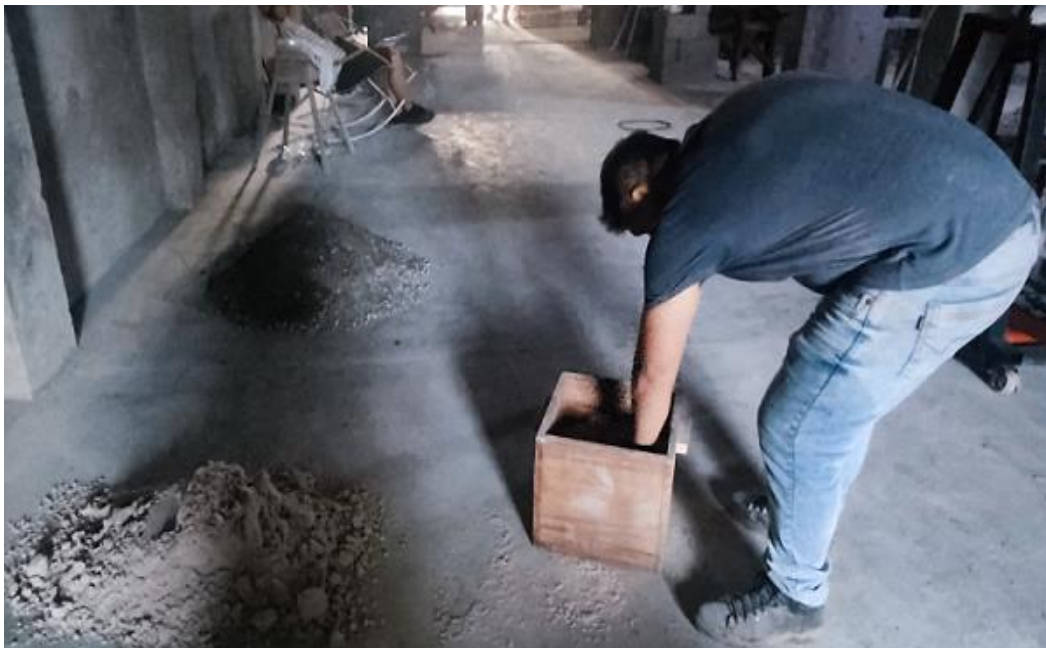
Foto N° 08 : Medición y Proporcionalidad del Agregado Fino para la Elaboración del Ladrillo Convencional de Mortero.
