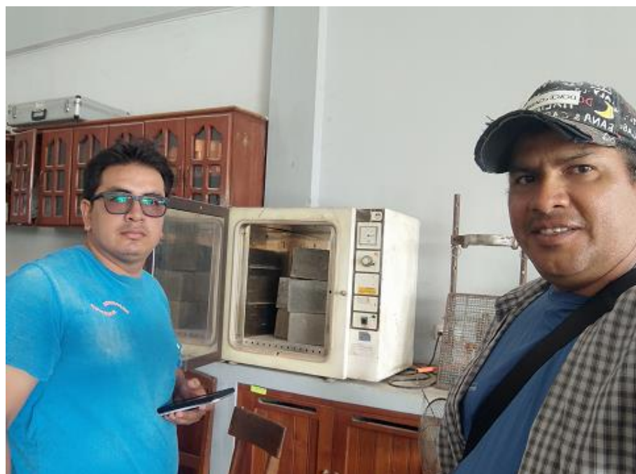
Foto N° 24 : Secado en el Horno de los Ladrillos de Mortero y Ladrillos con Residuos de Tarrajeo.
