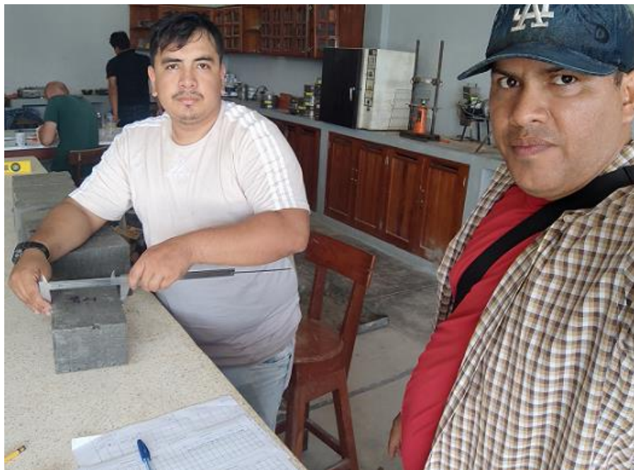
Foto N° 26 : Medidas de los Ladrillos, realizados en Laboratorio de Mecánica de Suelos y Ensayo de Materiales de la UCP.
