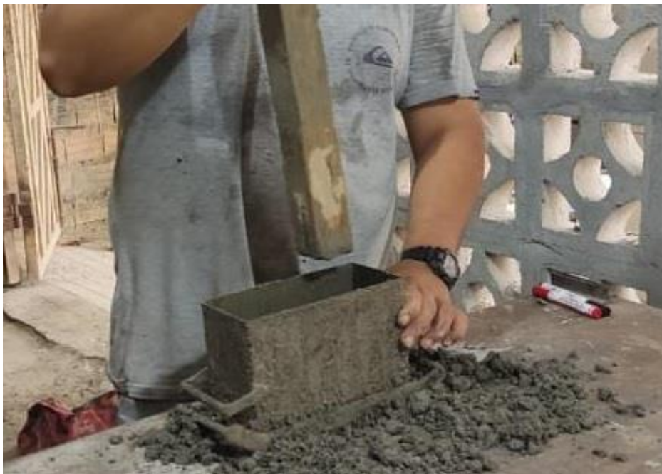
Foto N° 12 : Moldes Usados: Llenado de Moldes y chuceo de la Mezcla para la Elaboración del Ladrillo Convencional de Mortero.
