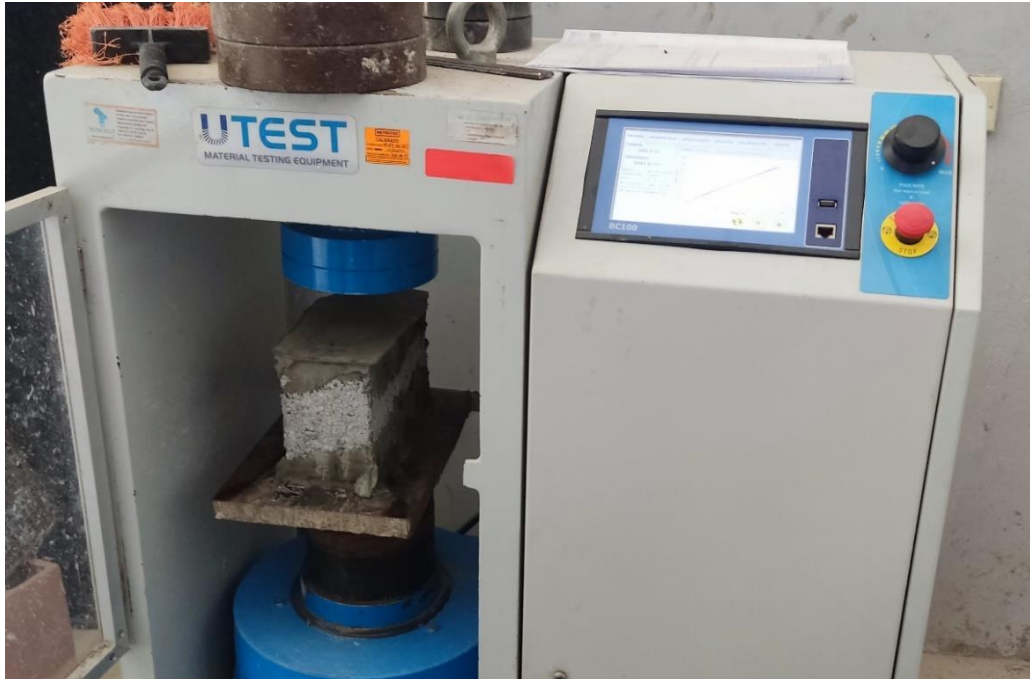
Foto N° 37 : Equipo de Prueba de Rotura de Ladrillos para el Ensayo de Compresión en Laboratorio de Mecánica de Suelos y Ensayo de Materiales de la UCP.
