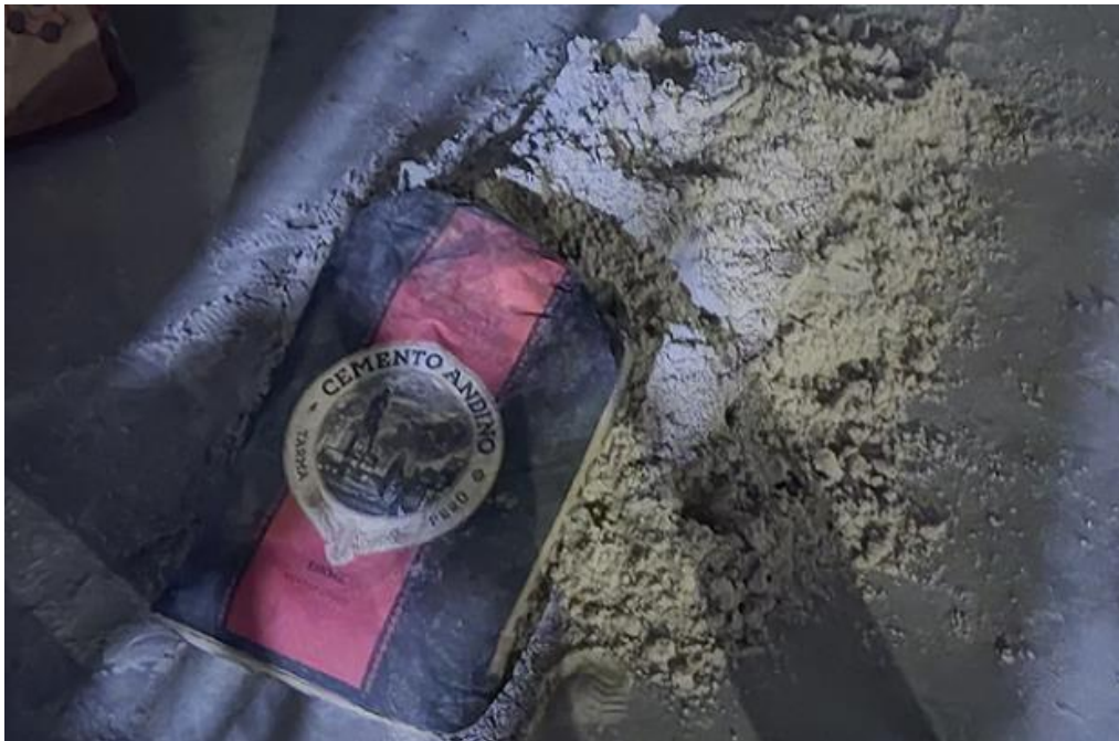
Foto N° 09 : Materiales: Cemento y Agregado Fino para la Elaboración del Ladrillo Convencional de Mortero.
