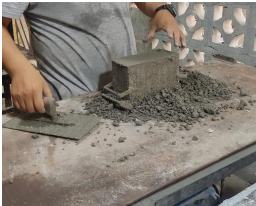
Foto N° 20 : Moldes Usados: Llenado de Moldes y vibrado de la Mezcla para la Elaboración del Ladrillo de Concreto.
