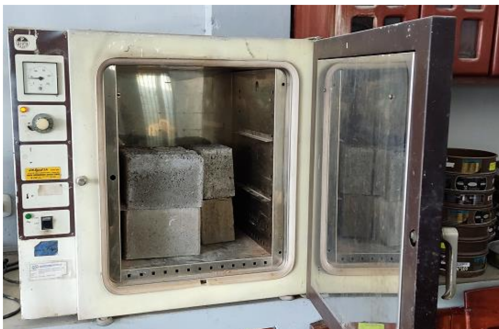
Foto N° 23 : Secado en el Horno de los Ladrillos Convencional de Mortero y Ladrillos de Concreto con Residuos de Tarrajeo.
