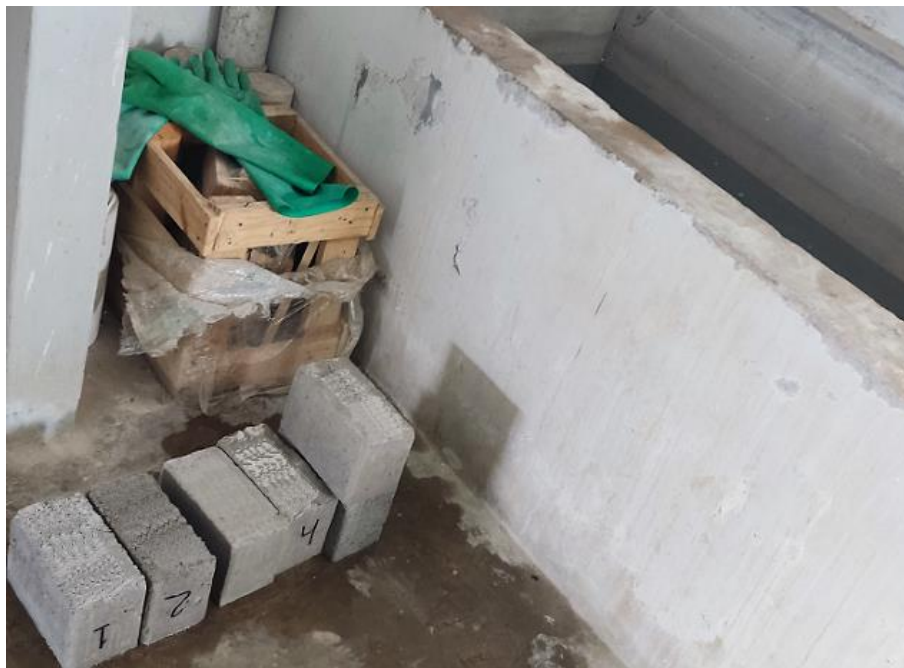
Foto N° 32 : Ensayos de Absorción de los Ladrillos, en Laboratorio de Mecánica de Suelos y Ensayo de Materiales de la UCP.
