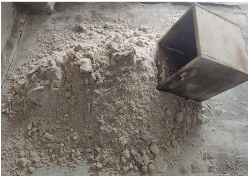
Foto N° 06 : Materia Prima – Agregado Fino – Arena Blanca, para la Elaboración del Ladrillo Convencional de Mortero.
