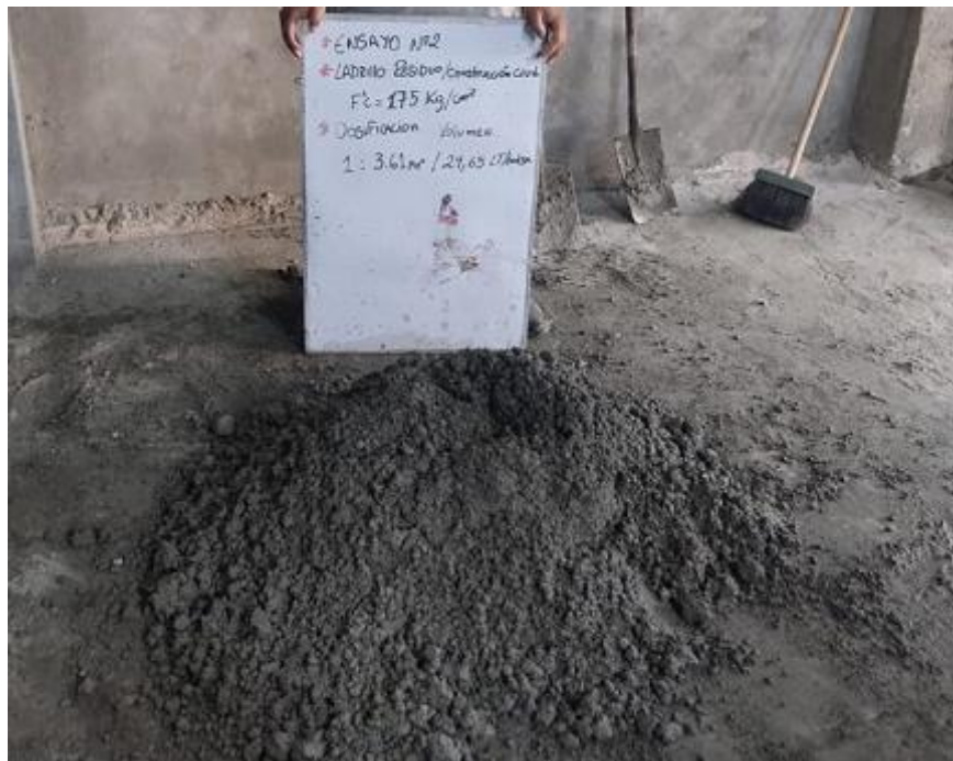
Foto N° 19 : Dosificación de Cemento y Residuos de Tarrajeo, Mezcla para la Elaboración del Ladrillo de Concreto.
