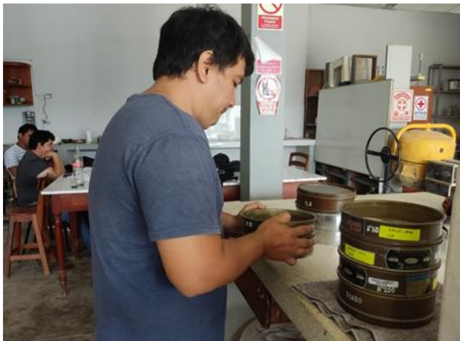
Foto N° 04 : Ensayo en Laboratorio de la UCP – Análisis Granulométrico, Tamizado de Agregado Fino para la Elaboración del Ladrillo.
