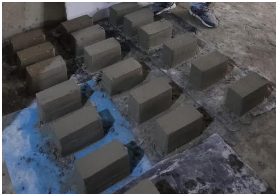
Foto N° 14 : Ladrillos convencionales de Mortero, para orearse y el secado a temperatura ambiente.
