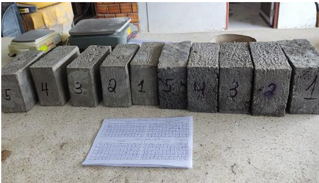
Foto N° 28 : Selección de los Ladrillos Fabricados; Laboratorio de Mecánica de Suelos y Ensayo de Materiales de la UCP.
