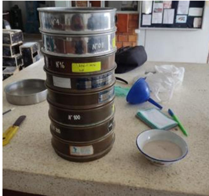
Foto N° 03 : Ensayo en Laboratorio de la UCP – Análisis Granulométrico, Tamizado de Agregado Fino para la Elaboración del Ladrillo.
