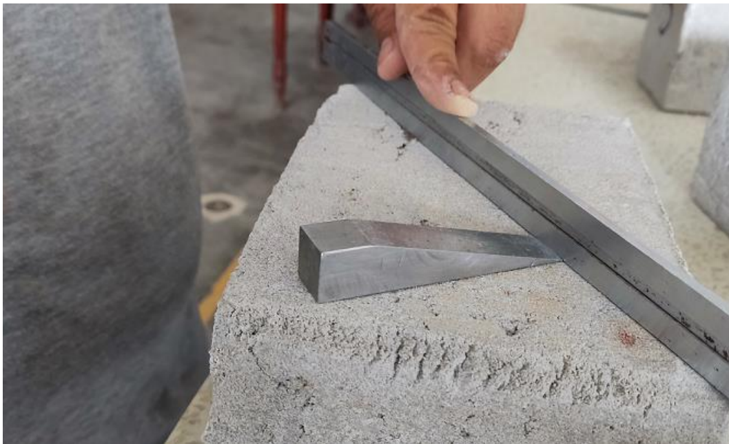
Foto N° 30 : Medición de Alabeo a los Ladrillos, en Laboratorio de Mecánica de Suelos y Ensayo de Materiales de la UCP.
