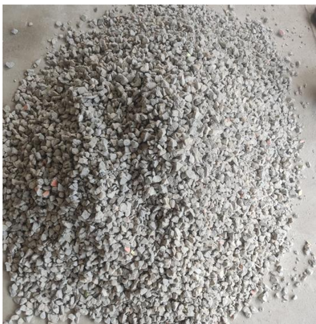
Foto N° 16 : Materia Prima – Residuos de Tarrajeo para la Elaboración del Ladrillo de Concreto.
