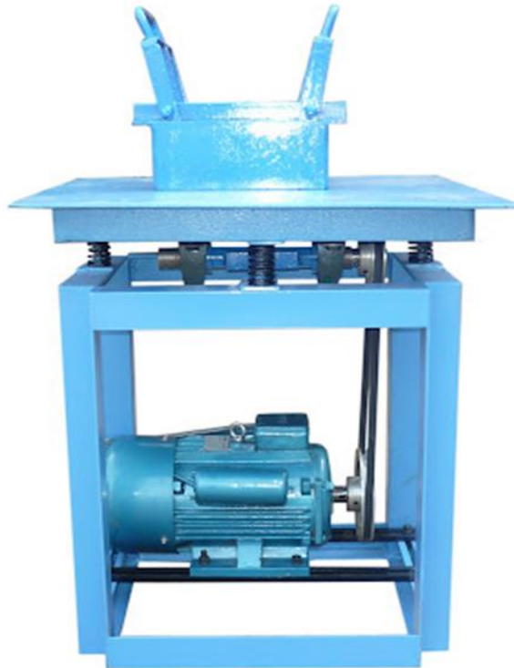
Figura N° 04 : Equipo de Fabricación del Ladrillo de Concreto
