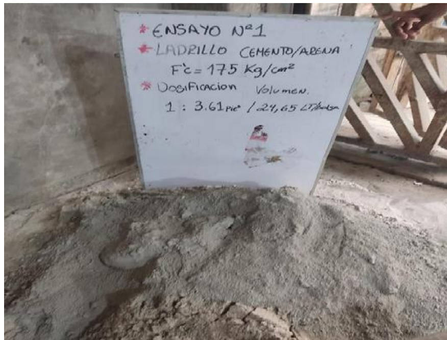
Foto N° 11 : Materiales: Dosificación de Cemento y Agregado Fino para la Elaboración del Ladrillo de Mortero.
