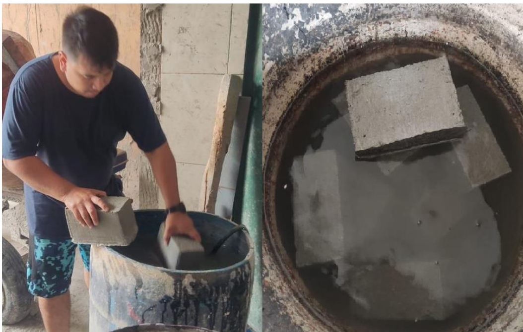
Foto N° 22 : Proceso de Curado de los Ladrillos.
