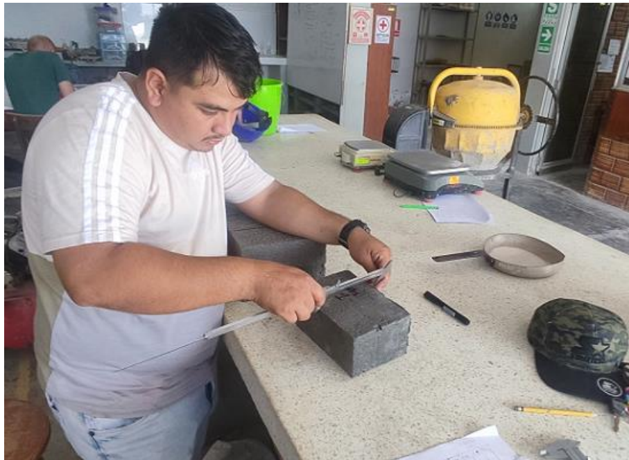
Foto N° 25 : Medidas de los Ladrillos, realizados en Laboratorio de Mecánica de Suelos y Ensayo de Materiales de la UCP.
