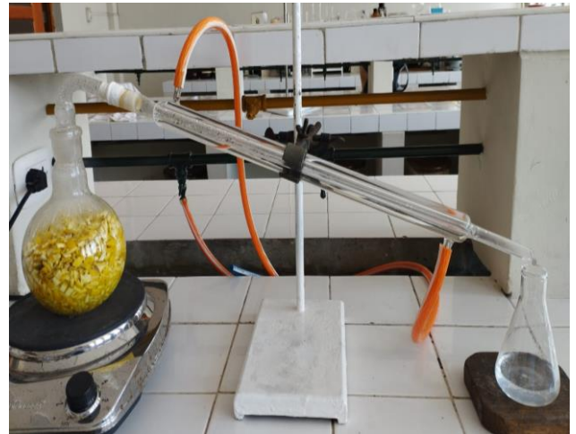
Fig. 2.2. Extracción de aceite esencial mediante la hidrodestilación.
