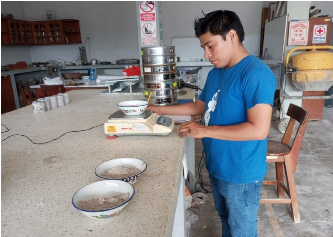
Imagen 3: Pesado del agregado fino.
