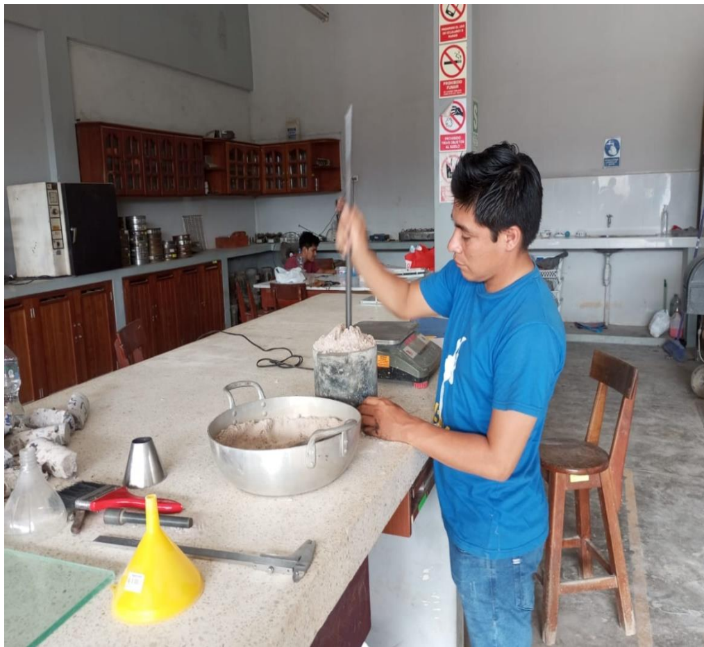
Imagen 2: Compactación de los agregados.
