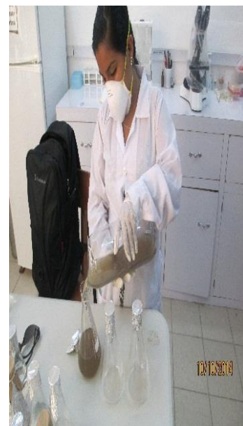
Figura 14. Filtración del lixiviado.
