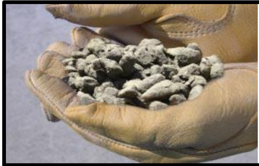
Ilustración 2: Ejemplos de concretos permeables con diferentes contenidos de agua, formados en una pelota: (a) muy poca agua, (b) cantidad de agua adecuada, (c) Mucha agua.
