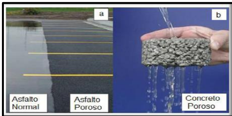
Ilustración 3: a) asfalto normal y poroso, b) concreto poroso
