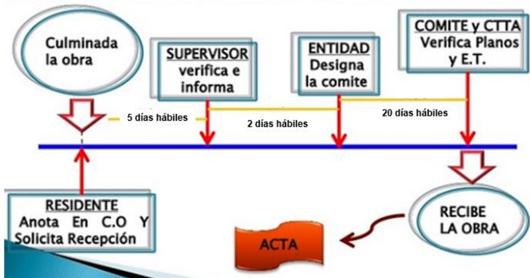
Gráfico N° 09: Recepción de Obra y Plazos (Sin Observaciones)
