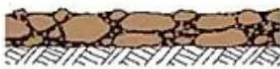
Ilustración 5: Sección Transversal Otta Seal Simple
