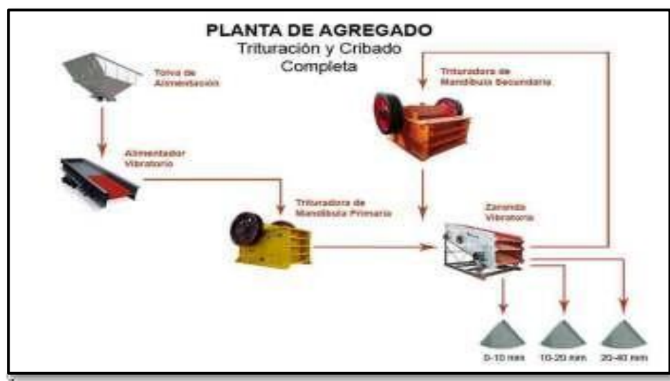
Ilustración 1: Esquema de funcionamiento Planta de Agregado.
