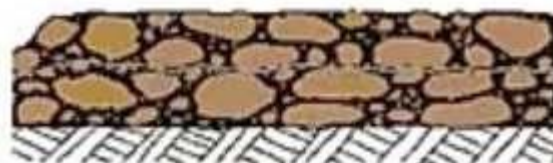
Ilustración 6: Sección Transversal Otta Seal Doble
