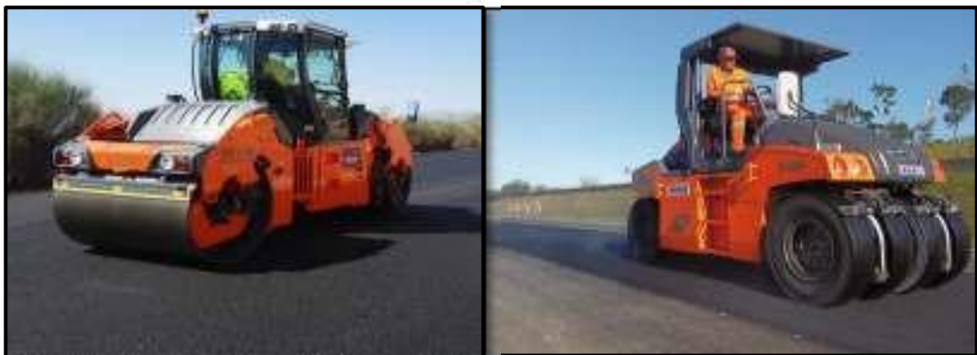
Ilustración 4: Equipos de Compactación
