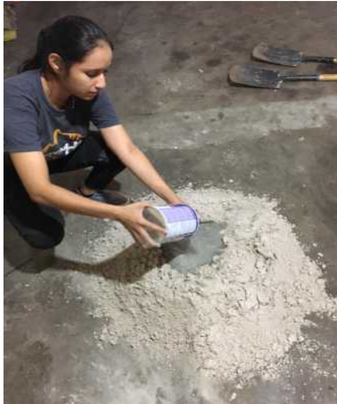
Preparación de mezcla para probetas
