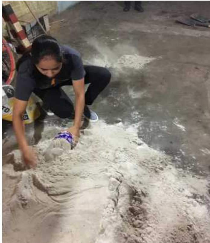
Preparación de los testigos de mortero
