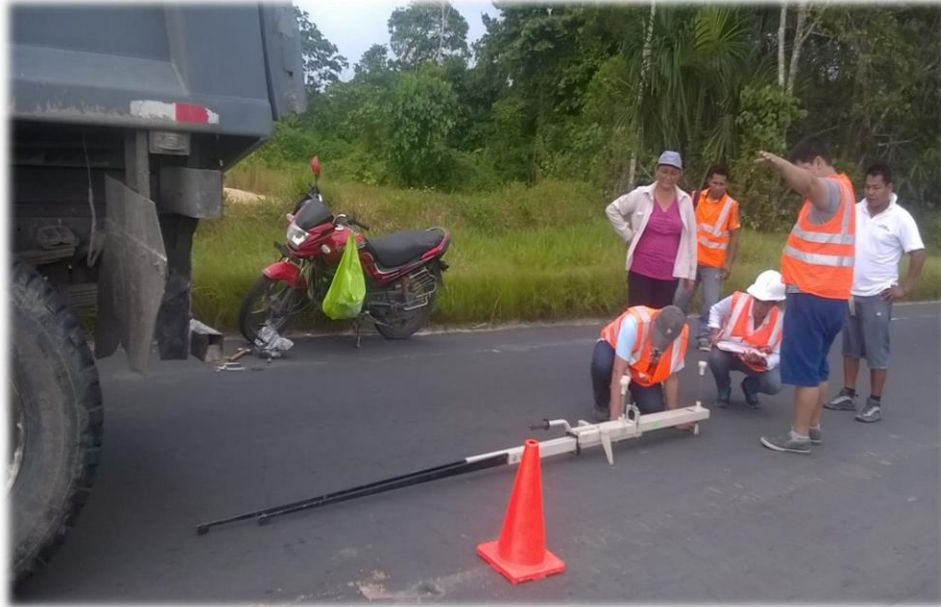
Foto N°13 : Marcha del Camión y Toma de lecturas , Elaboración Propia
