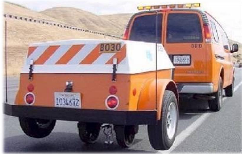
Foto N°16 Dynaflect. Fuente: Análisis Comparativo De La Evaluación De Pavimentos Por Medio De La Viga Benkelman Y El Deflectómetro De Impacto (Falling Weight Deflectometer, Fwd) , Escobar, Kerin (2007)
