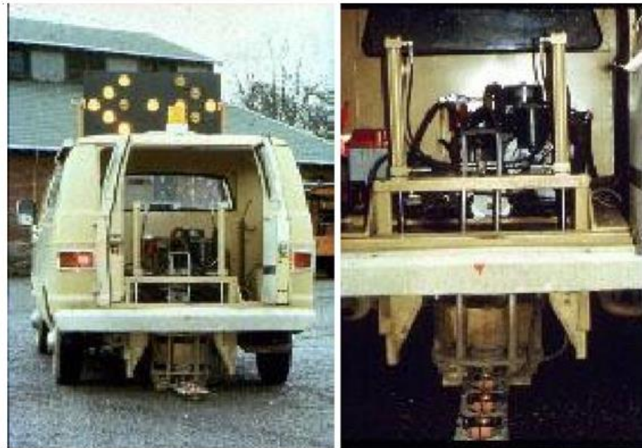
Foto N°17 Road Rater (electro-hidráulico).. Fuente: Análisis Comparativo De La Evaluación De Pavimentos Por Medio De La Viga Benkelman Y El Deflectómetro De Impacto (Falling Weight Deflectometer, Fwd) , Escobar, Kerin (2007)
