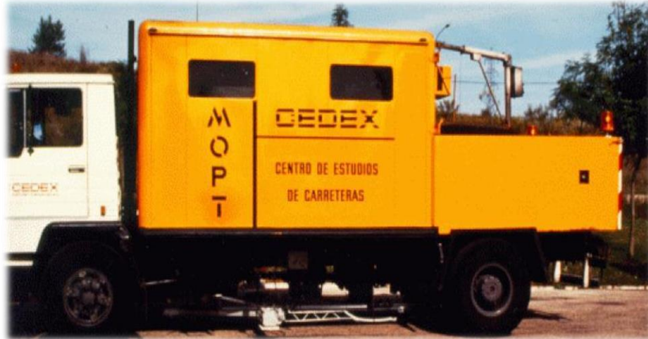
Foto N°15 : Deflectógrafo tipo Lacroix, Equipo semicontinuo.
