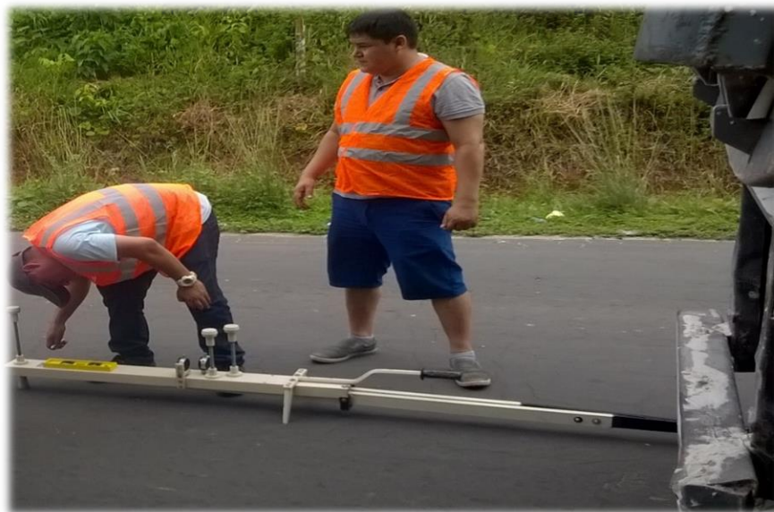
Foto N°12 : Verificación de los Diales antes de la Marcha del Camión, Elaboración Propia
