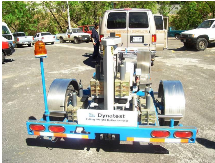
Foto N°18 Deflectómetro de Impacto Dynatest FWD 8000. Fuente: Análisis Comparativo De La Evaluación De Pavimentos Por Medio De La Viga Benkelman Y El Deflectómetro De Impacto (Falling Weight Deflectometer, Fwd), Escobar, Kerin (2007)
