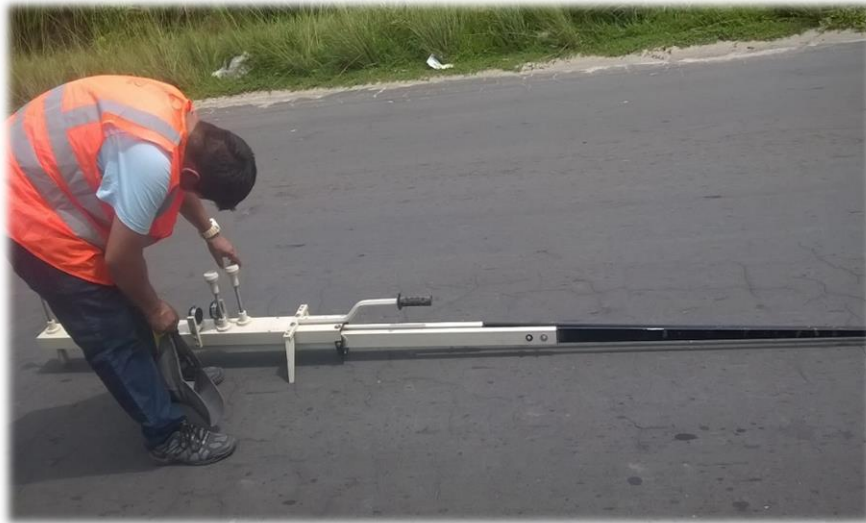
Foto N°11 : Ajustes de Tornillos para el contacto del Dial, Elaboración Propia
