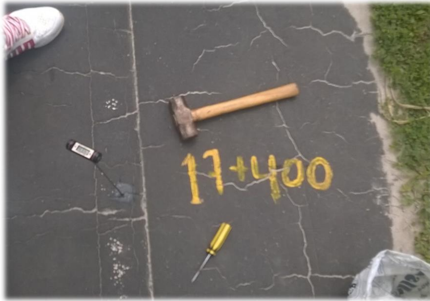
Foto N°14 : Toma de Temperatura del pavimento, Elaboración Propia
