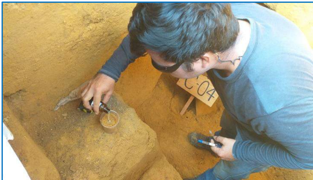
FOTO N° 08. Verificando la reacción del suelo, frente al Ácido Clorhídrico.
