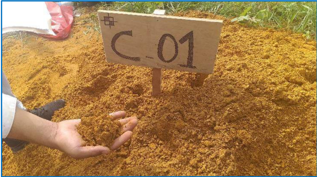
FOTO N° 05. Verificando la angulosidad de las partículas gruesas.
