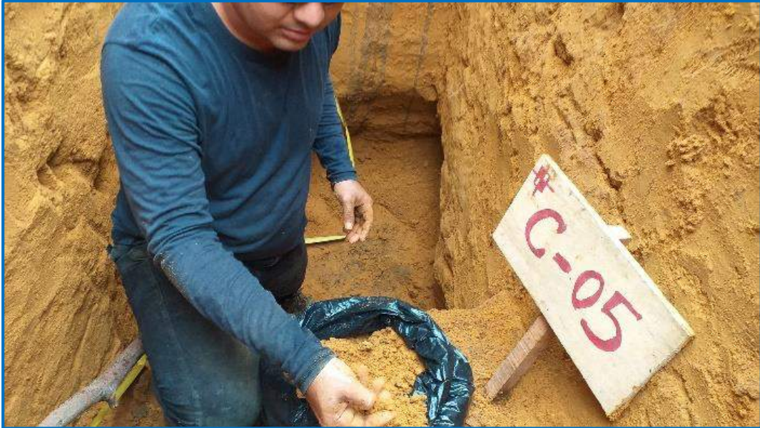
FOTO N° 12. Comprobación de la resistencia en seco del suelo.
