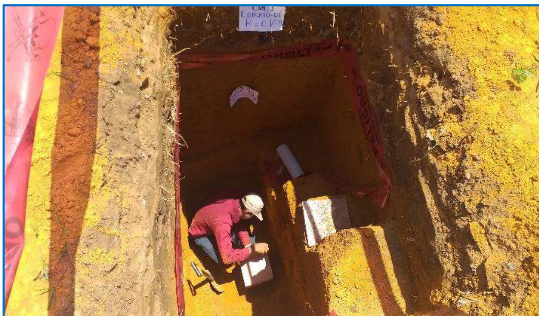
FOTO N° 14. Extracción Muestra para análisis en laboratorio.
