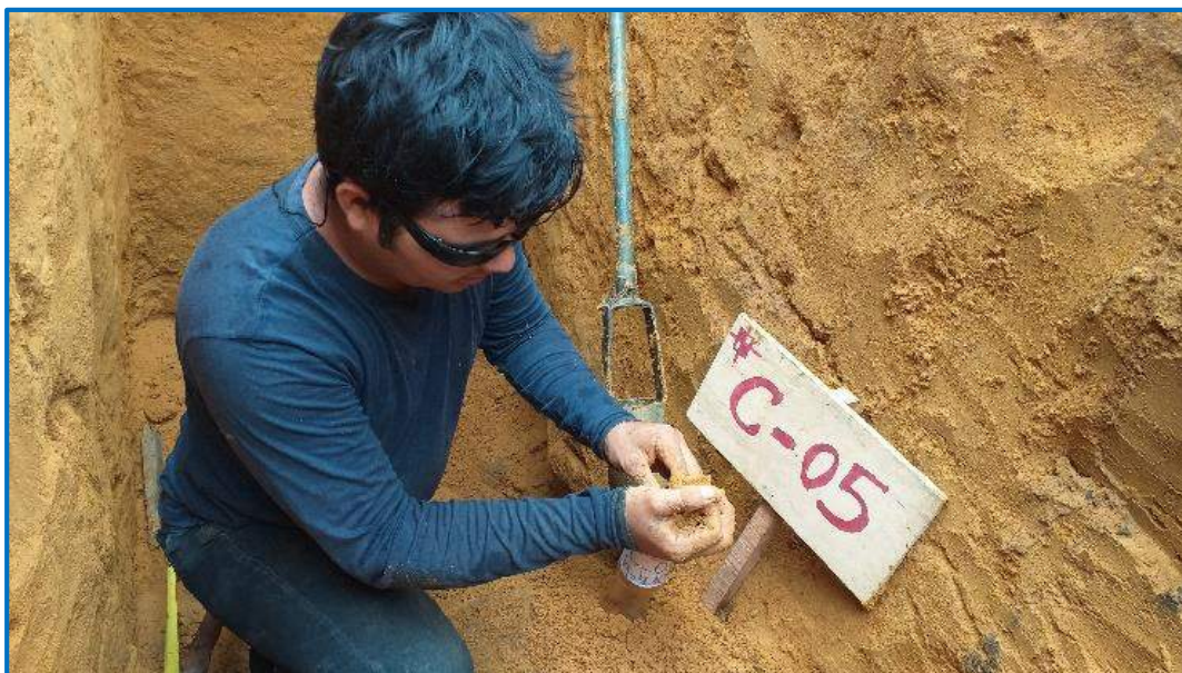
FOTO N° 13. Muestra para identificar presencia de finos del suelo.
