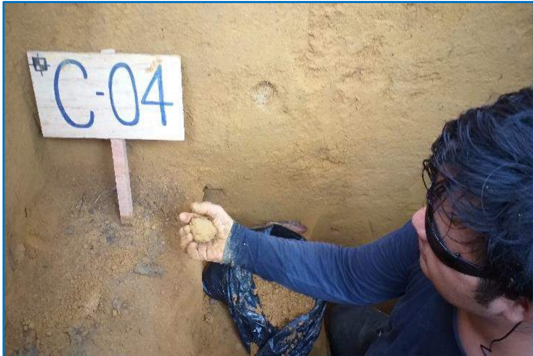
FOTO N° 07. Verificando el contenido de humedad del suelo.
