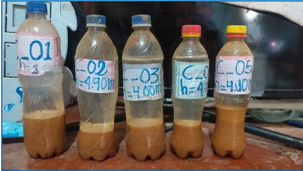
FOTO N° 15. Muestra para verificar presencia de finos en el suelo.
