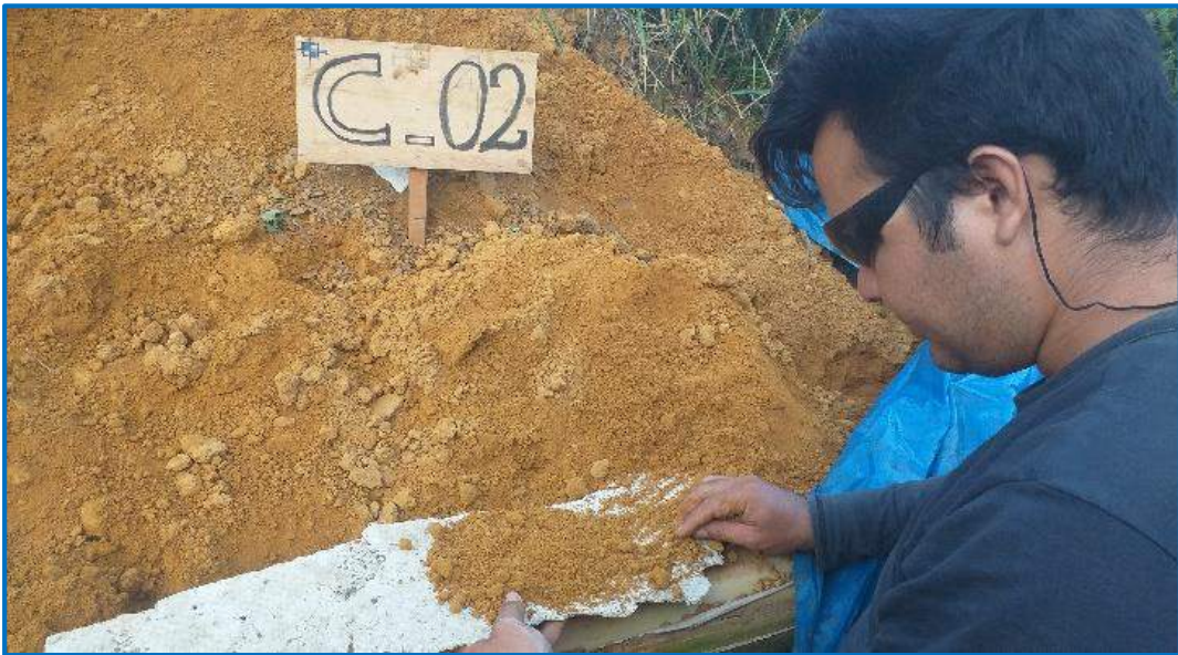
FOTO N° 10. Verificando la cementación del suelo.
