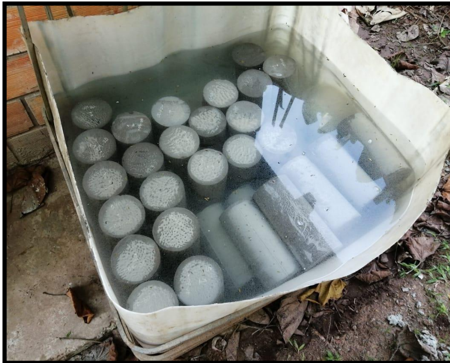
FOTOGRAFÍA N° 28 - VISTA FOTOGRÁFICA DONDE SE MUESTRA EL CURADO DE PROBETAS DE CONCRETO.
