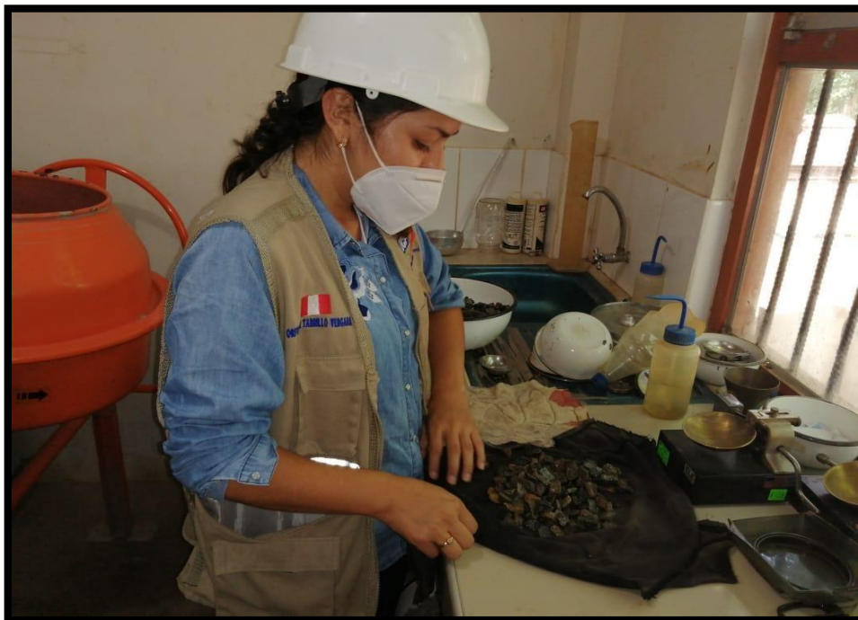
FOTOGRAFÍA N° 12-VISTA FOTOGRÁFICA DEL SECADO SUPERFICIAL DEL AGREGADO GRUESO
