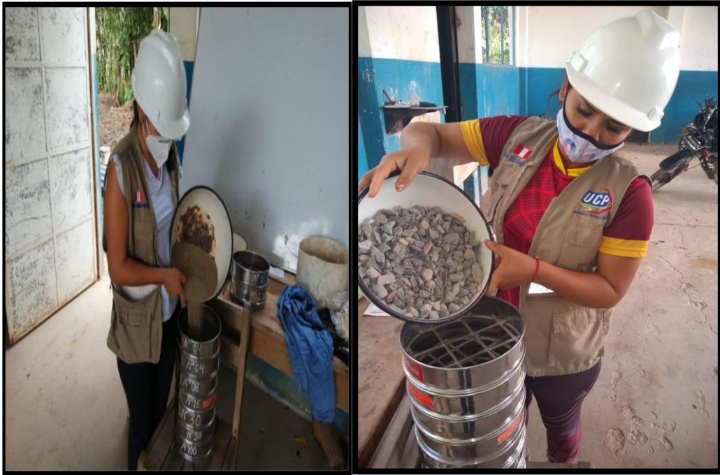
FOTOGRAFÍA N° 07-VISTA FOTOGRÁFICA DONDE SE MUESTRA EL TAMIZADO DEL AGREGADO FINO Y GRUESO.
