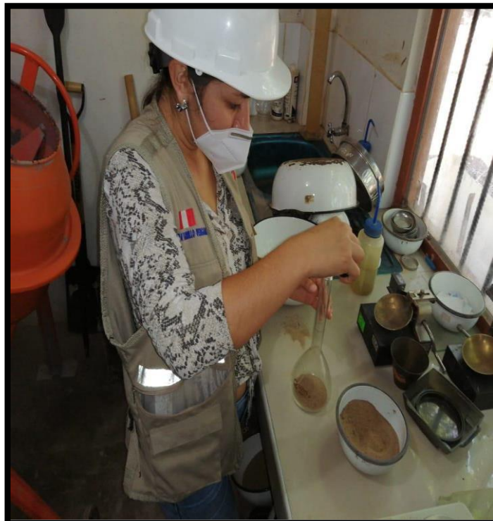
FOTOGRAFÍA N° 16 - VISTA FOTOGRÁFICA DONDE SE MUESTRA LA COLOCACIÓN DEL AGREGADO FINO EN LA FIOLA.
