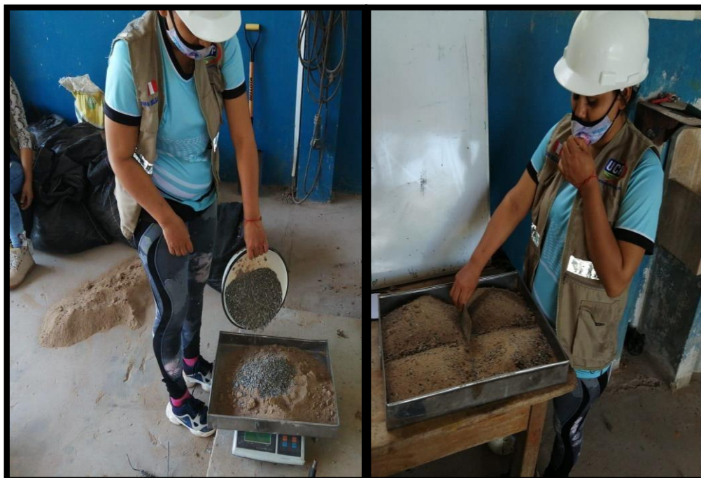
FOTOGRAFÍA N° 19- VISTA FOTOGRÁFICA DONDE SE MUESTRA LA MEZCLA Y CUARTEO DE LA ARENA TRITURADA CON ARENA NATURAL.
