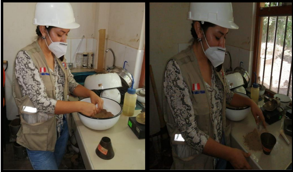
FOTOGRAFÍA N° 15 - VISTA FOTOGRÁFICA DONDE SE MUESTRA EL ENSAYO DE PESO ESPECÍFICO DEL AGREGADO FINO
