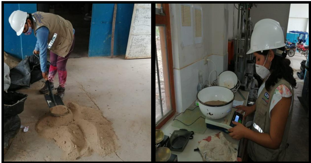
FOTOGRAFÍA N° 04. VISTA FOTOGRÁFICA DONDE SE MUESTRA EL CUARTEO Y PESO DEL AGREGADO FINO
