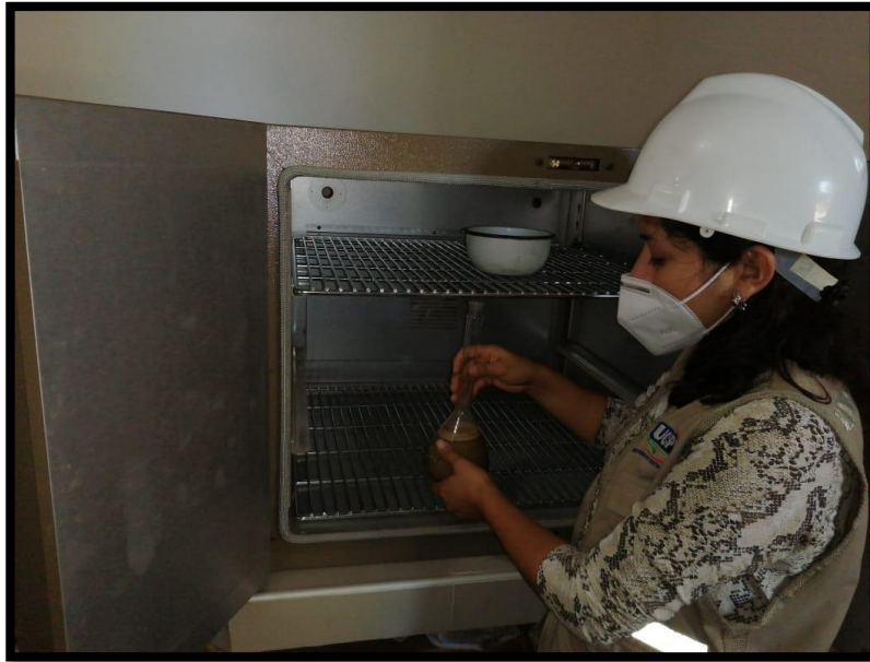
FOTOGRAFÍA N° 17 - VISTA FOTOGRÁFICA DONDE SE MUESTRA LA COLOCACIÓN DEL AGREGADO FINO EN HORNO
