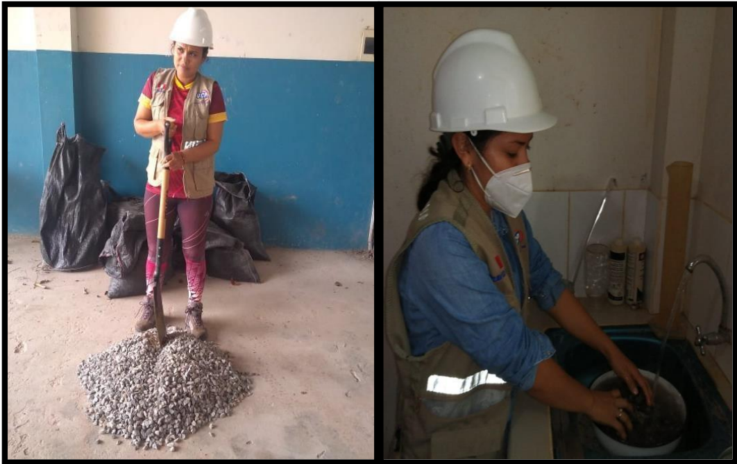
FOTOGRAFÍA N° 11-VISTA FOTOGRÁFICA DEL CUARTEO DEL AGREGADO GRUESO Y EL MATERIAL SUMERGIDO EN AGUA POR 24 HORAS.
