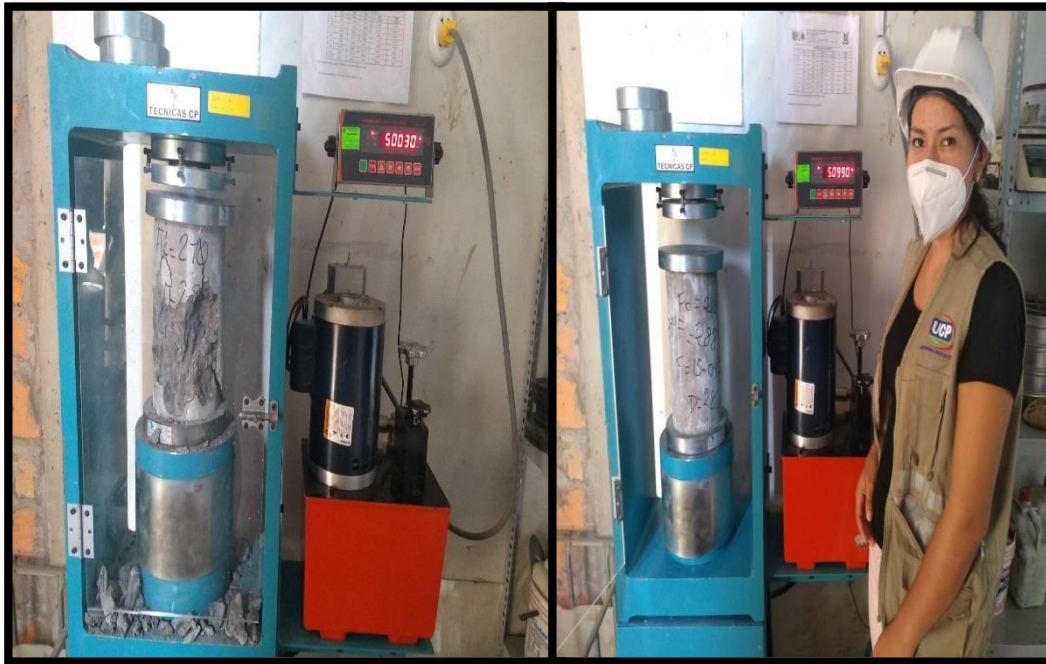
FOTOGRAFÍA N° 31 - VISTA FOTOGRÁFICA DONDE SE MUESTRA LA ROTURA DE PROBETAS A LA COMPRESIÓN DEL CONCRETO
