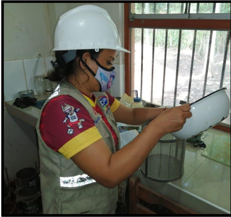
FOTOGRAFÍA N° 13- VISTA FOTOGRÁFICA DONDE SE MUESTRA LA COLOCACIÓN DEL AGREGADO GRUESO EN LA CANASTILLA
