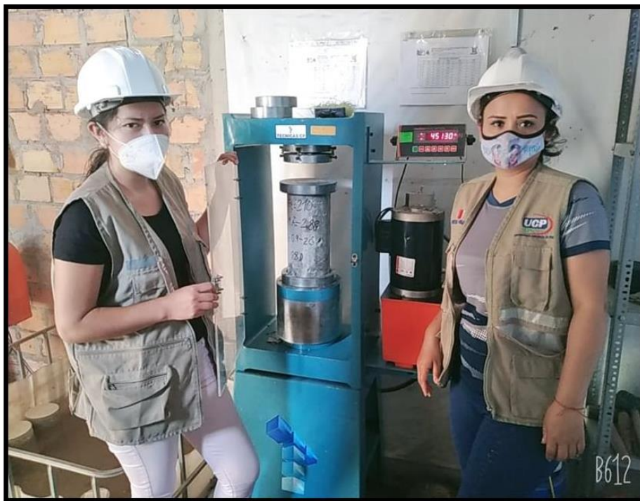
FOTOGRAFÍA N° 32 - VISTA FOTOGRÁFICA DONDE SE MUESTRA LOS ENSAYOS DE RESISTENCIA A LA COMPRESIÓN DEL CONCRETO.
