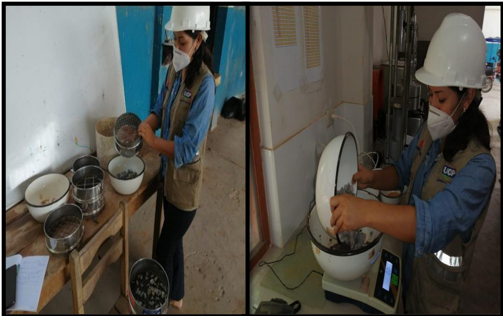
FOTOGRAFÍA N° 08 -VISTA FOTOGRÁFICA DONDE SE MUESTRA EL TAMIZADO Y PESAMOS EL MATERIAL RETENIDO EN CADA TAMIZ DE AGREGADO GRUESO.
