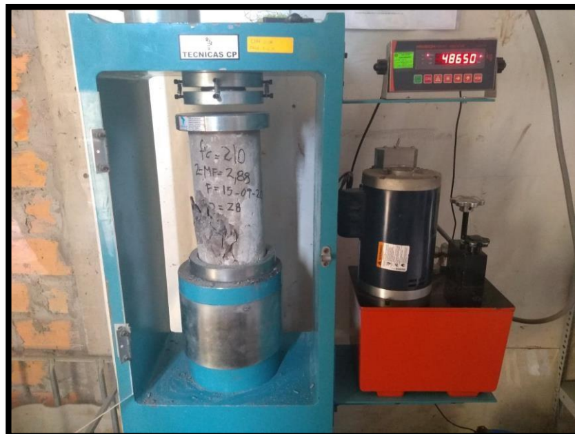
FOTOGRAFÍA N° 30- VISTA FOTOGRÁFICA DONDE SE MUESTRA LA ROTURA DE PROBETAS A LA COMPRESIÓN DEL CONCRETO
