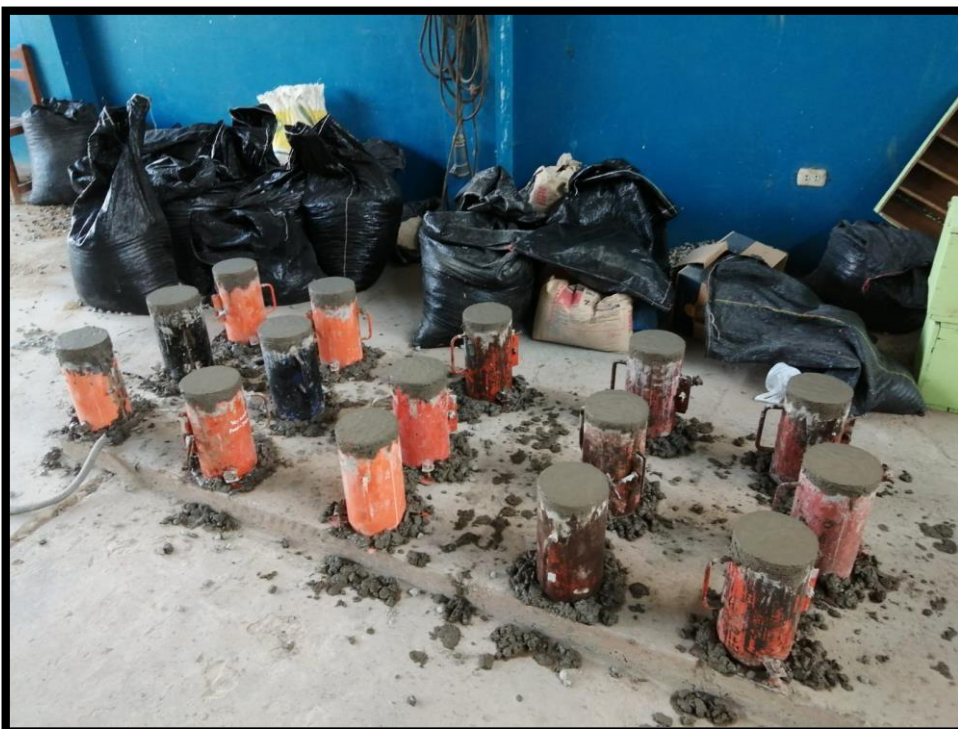
FOTOGRAFÍA N° 26 - VISTA FOTOGRÁFICA DONDE SE MUESTRA LA PROBETAS REALIZADA DE CONCRETO.
