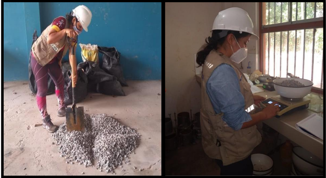
FOTOGRAFÍA N° 03. VISTA FOTOGRÁFICA DONDE SE MUESTRA EL CUARTEO Y PESO DEL AGREGADO GRUESO
