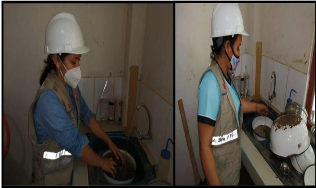
FOTOGRAFÍA N° 05- VISTA FOTOGRÁFICA DONDE SE MUESTRA EL LAVADO DE LOS AGREGADOS FINO Y GRUESO.
