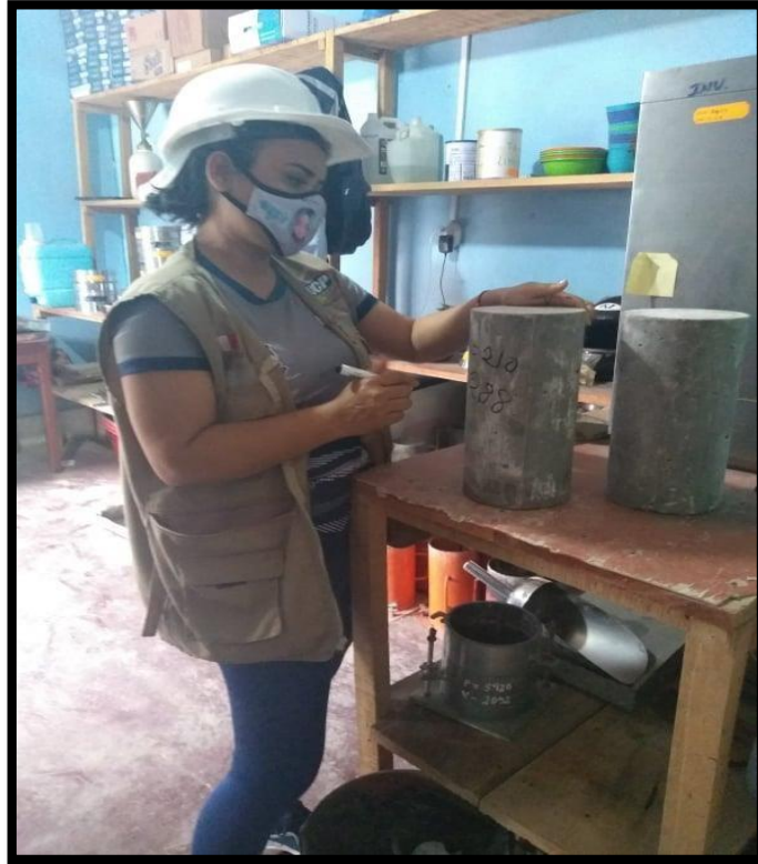
FOTOGRAFÍA N° 29- VISTA FOTOGRÁFICA DONDE SE MUESTRA EL ROTULADO DE LAS PROBETAS.
