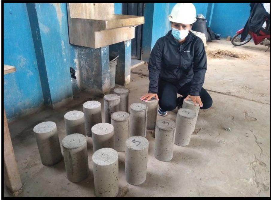
FOTOGRAFÍA N° 27 - VISTA FOTOGRÁFICA DONDE SE MUESTRA EL FRAGUADO DE LAS PROBETAS DESPUES DE 24 HORAS.
