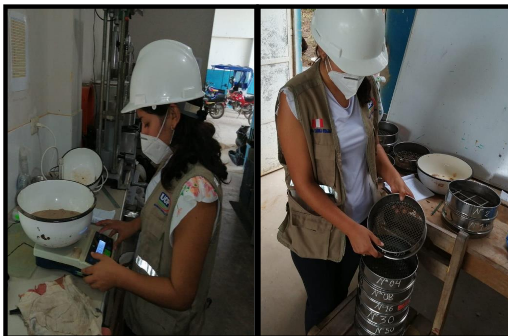
FOTOGRAFÍA N° 20- VISTA FOTOGRÁFICA DONDE SE MUESTRA EL PESO Y TAMIZADO DE LA ARENA TRITURADA CON ARENA NATURAL.
