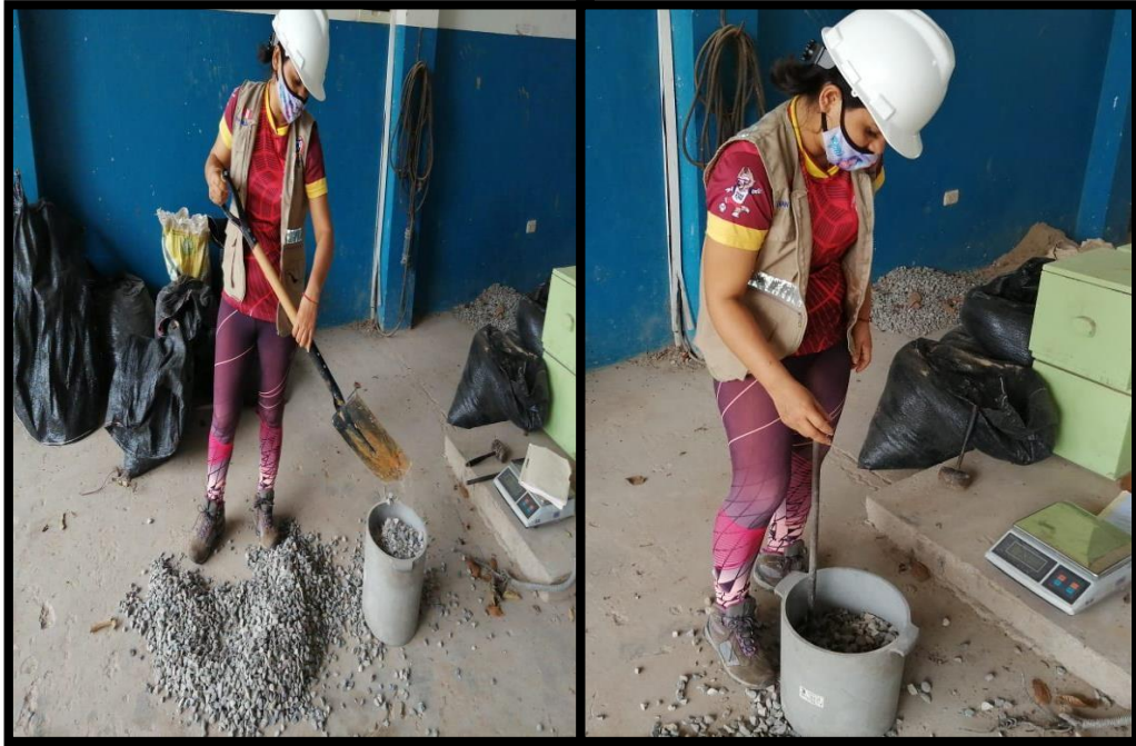
FOTOGRAFÍA N° 09-VISTA FOTOGRÁFICA DONDE SE MUESTRA EL ENSAYO DE PESO UNITARIO SUELTO Y COMPACTADO DEL AGREGADO GRUESO
