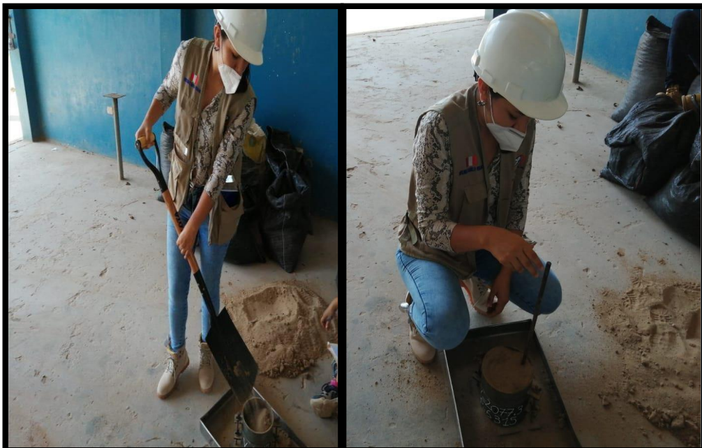
FOTOGRAFÍA N° 10-ENSAYO DE PESO UNITARIO SUELTO Y COMPACTADO DEL AGREGADO FINO.
