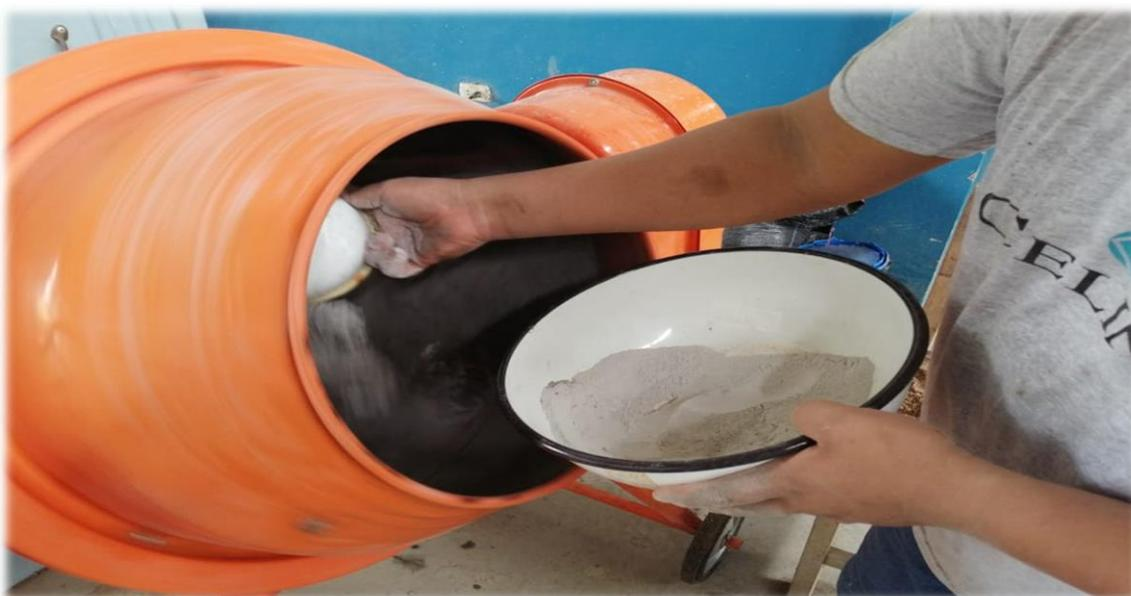
**FOTOGRAFÍA N° 08: SE MUESTRA EL INSUMO VIDRIO MOLIDO SIENDO COLOCADO EN LA MEZCLADORA DE CONCRETO.**
