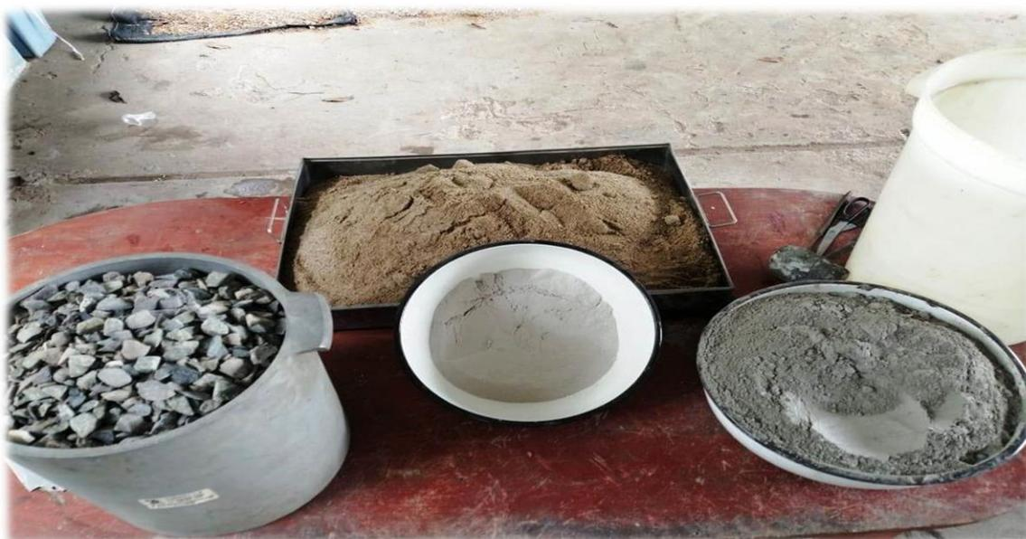
**FOTOGRAFÍA N° 07: SE MUESTRA LOS INSUMOS DEBIDAMENTE PESADOS PARA ELABORAR LA MEZCLA DE CONCRETO.**
