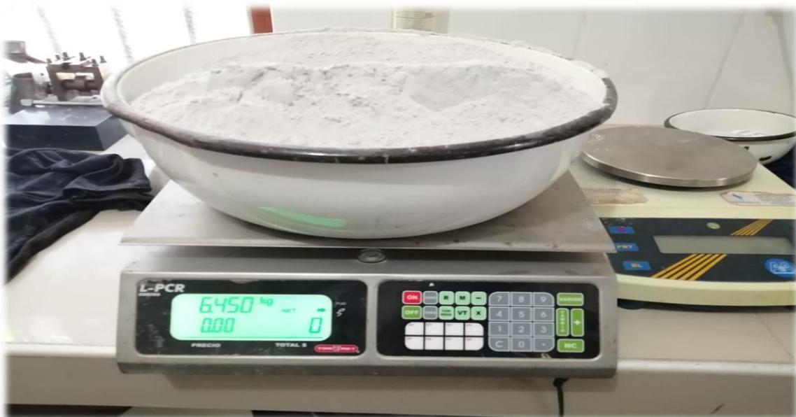
**FOTOGRAFÍA N° 06: REALIZANDO EL PROCEDIMIENTO DE PESADO DEL VIDRIO MOLIDO EN EL LABORATORIO.**
