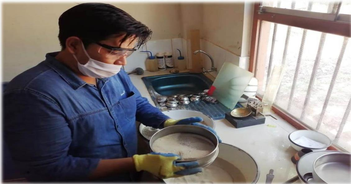
**FOTOGRAFÍA N° 01: REALIZANDO LOS RESPECTIVOS PROCEDIMIENTOS AL AGREGADO FINO EN EL LABORATORIO DE ACUERDO A LA NORMATIVA VIGENTE.**
