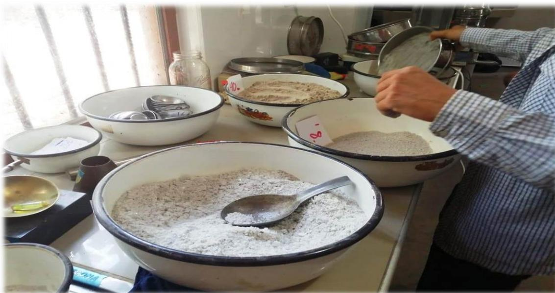
**FOTOGRAFÍA N° 02: REALIZANDO EL TAMIZADO CON LAS MALLAS AL VIDRIO MOLIDO EN EL LABORATORIO DE ACUERDO A LA NORMATIVA VIGENTE.**
