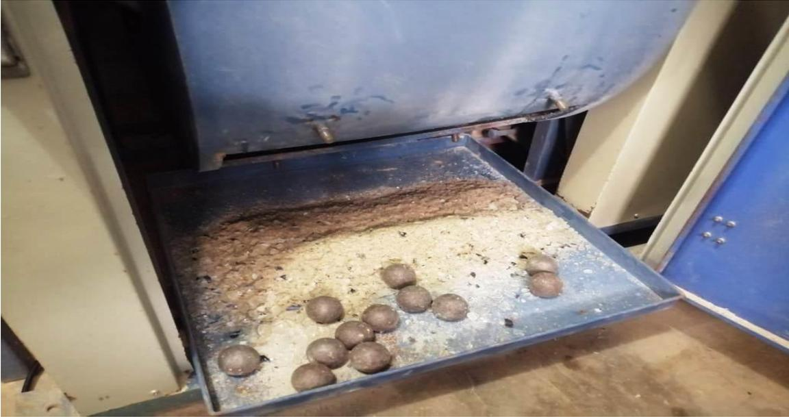
**FOTOGRAFÍA N° 03: REALIZANDO LOS RESPECTIVOS PROCEDIMIENTOS PARA OBTENER EL VIDRIO MOLIDO EN EL LABORATORIO.**
