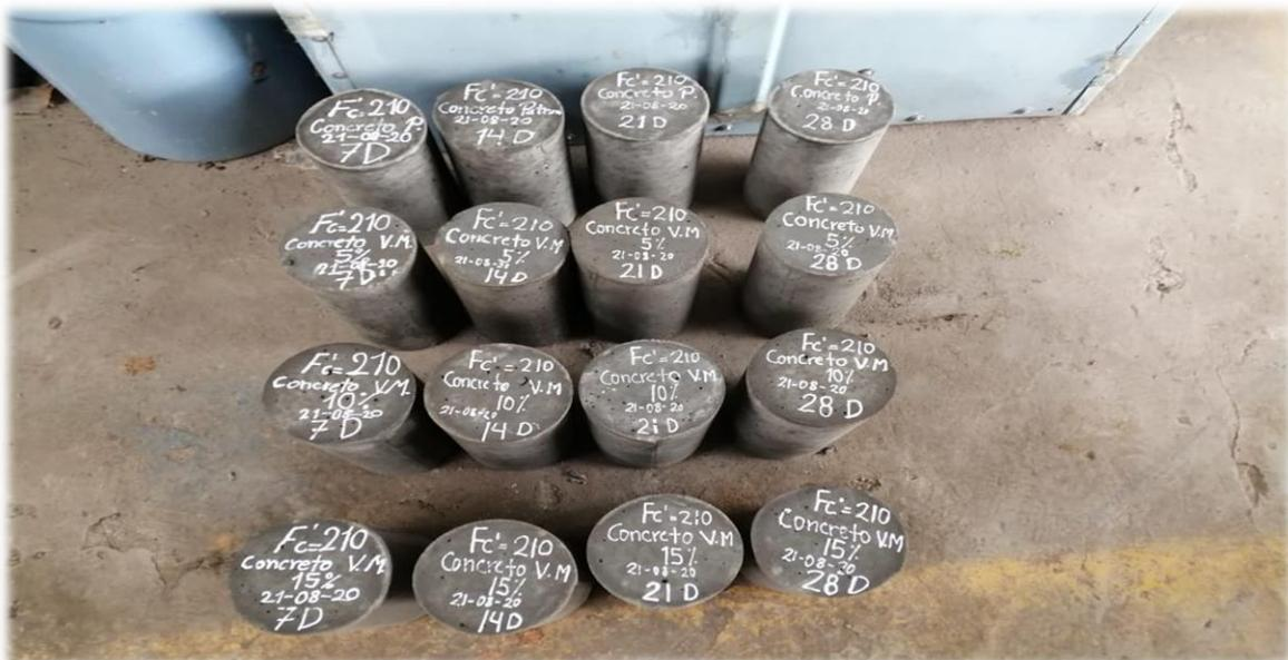
**FOTOGRAFÍA N° 10: SE MUESTRA LOS ESPECIMENES DE CONCRETO LISTOS PARA REALIZAR EL PROCESO DE CURADO.**
