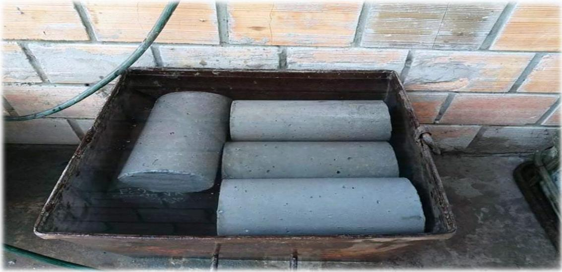
**FOTOGRAFÍA N° 11: SE MUESTRA LOS ESPECIMENES DE CONCRETO EN EL PROCESO DE CURADO.**
