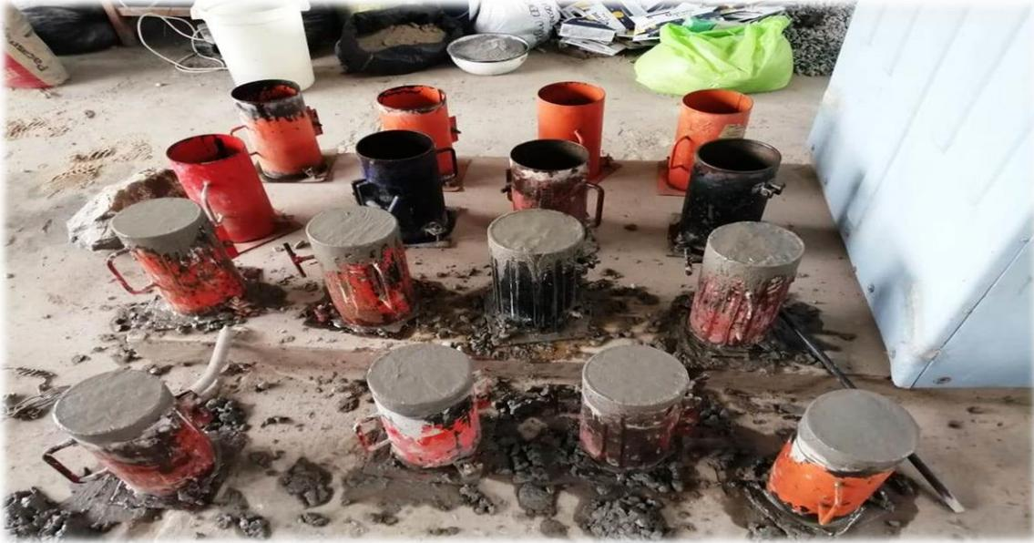
**FOTOGRAFÍA N° 09: SE MUESTRA LA MEZCLA DE CONCRETO SIENDO COLOCADOS EN LA PROBETAS.**
