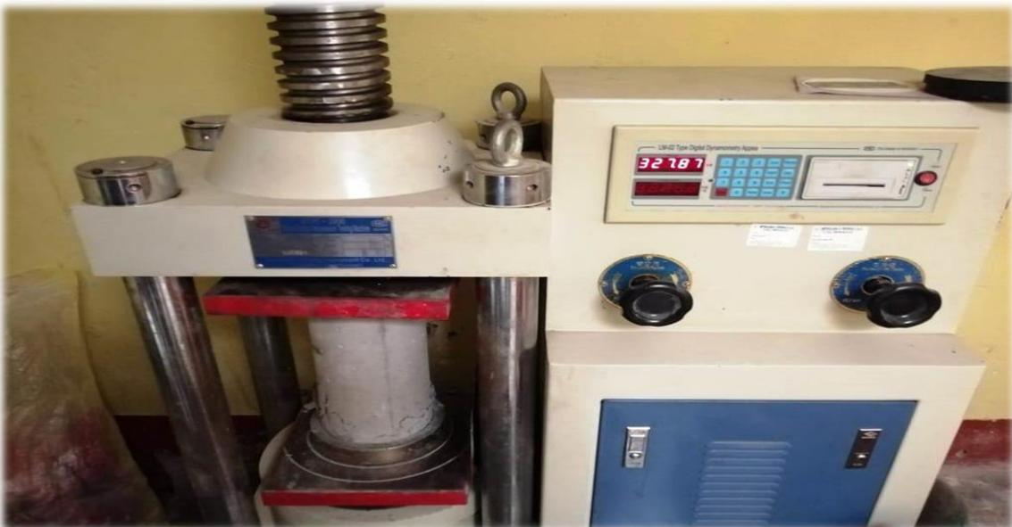
**FOTOGRAFÍA N° 12: SE MUESTRA LOS ESPECIMENES DE CONCRETO EN LA PRENSA PARA PROCEDER A LA PRUEBA DEL ESFUERZO A COMPRESION.**
