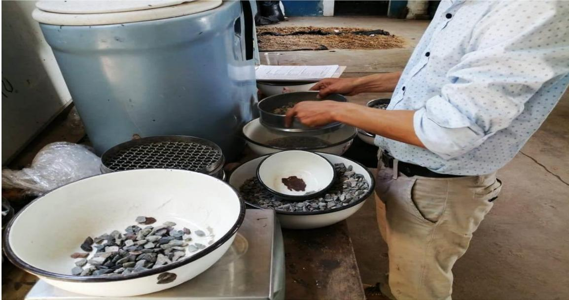
**FOTOGRAFÍA N° 05: REALIZANDO LOS PROCEDIMIENTOS PARA OBTENER EL PESO DE LA PIEDRA CHANCADA EN EL LABORATORIO.**
