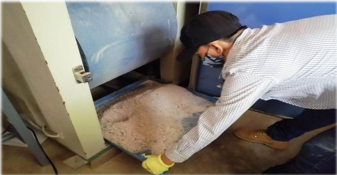
**FOTOGRAFÍA N° 04: RECOGIENDO EL INSUMO DEL VIDRIO DE LA MAQUINA DE LOS ANGELES EN EL LABORATORIO.**
