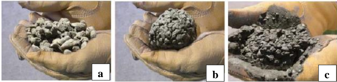
Ilustración 6: Muestras de concreto permeable con diferentes contenidos de agua: (a) falta de agua, (b) cantidad de agua adecuada, (c) mucha agua
