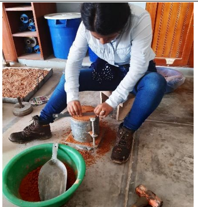
Foto N°18: Preparación de moldes y material natural para ensayo CBR. Calicata 02.
