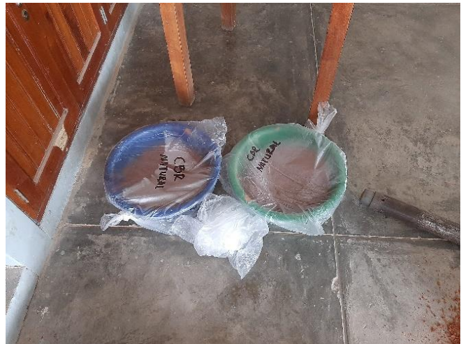
Foto N°16: Preparación de muestra para ensayos CBR. Calicata 02.
