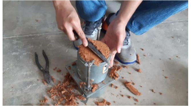
Foto N°48: Ensayo de CBR de material con diferentes % de cal hidratada. Calicata 02.
