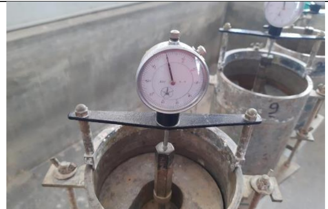
Foto N°30: Moldes de muestra con diferentes % de cal hidrata en inmersión. Calicata 01.
