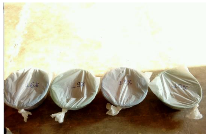
Foto N°10: Preparación de muestras con diferentes % de Humedad para Proctor Modificado
