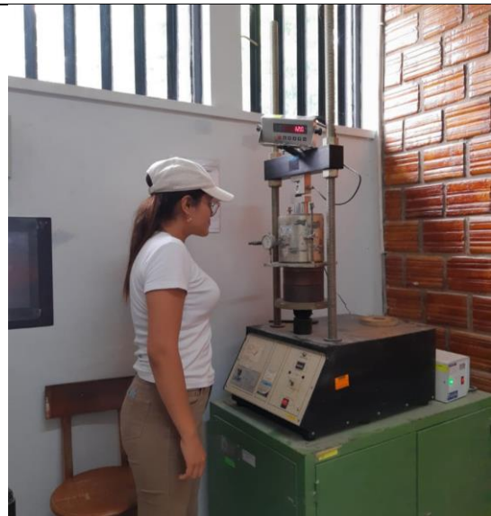
Foto N°34: Lectura del peso de la muestra con diferentes % de cal hidratada. Calicata 01.
