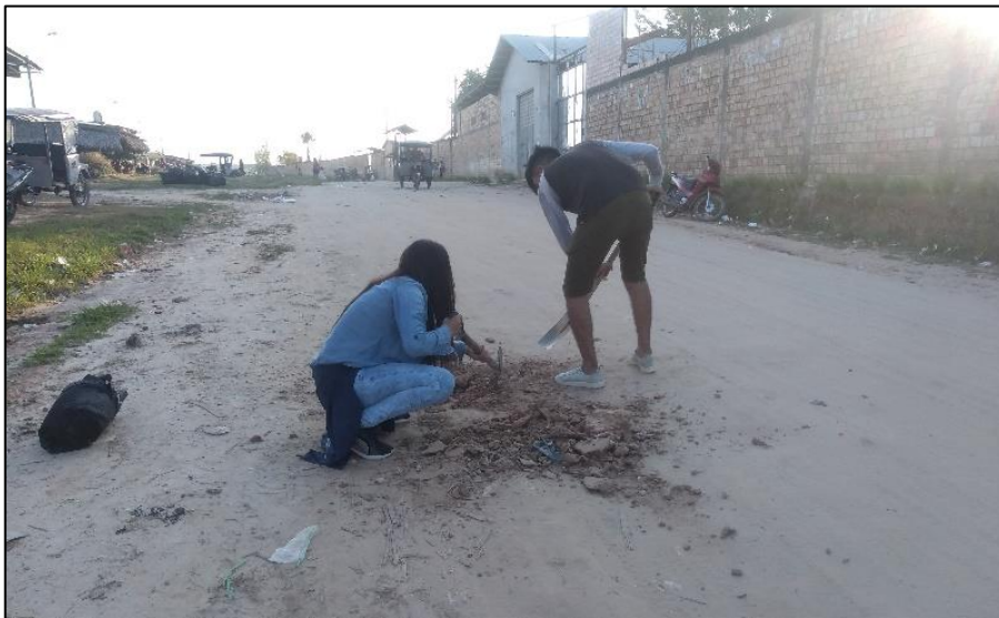
Ilustración 7. Extracción muestra para ensayos de la calicata N°01 - km 00+160
