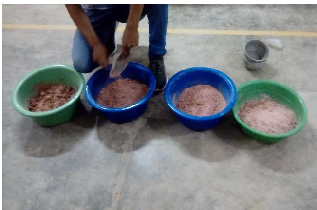
Foto N°09: Preparación de muestras con diferentes % de Humedad para Proctor Modificado
