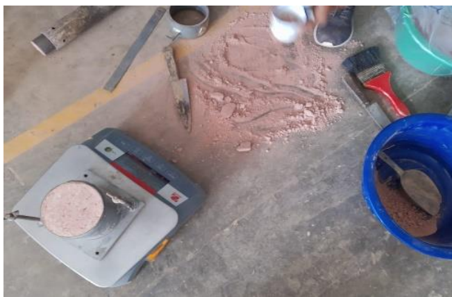
Foto N°25: Pesado de molde Proctor modificado con diferentes % de humedad. Calicata 01
