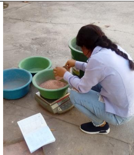
Foto N°40: Pesado de material para preparar con diferentes % de cal viva para CBR. Calicata 01.
