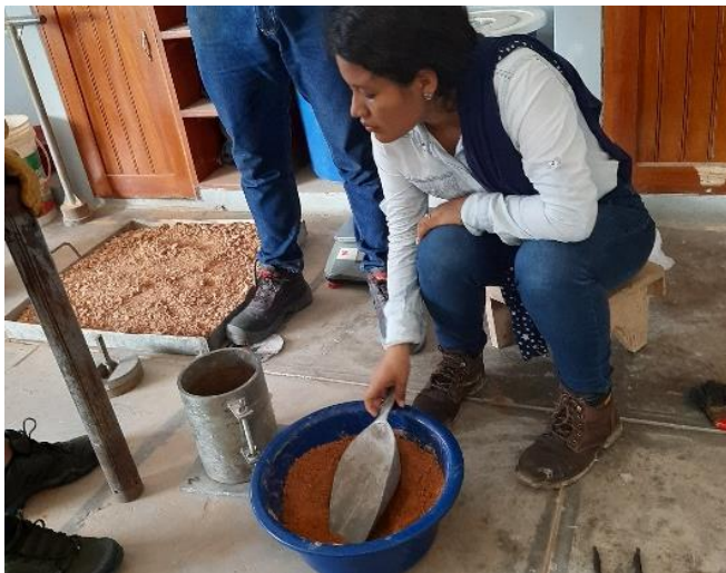
Foto N°15: Preparación de muestra para ensayos CBR. Calicata 02.
