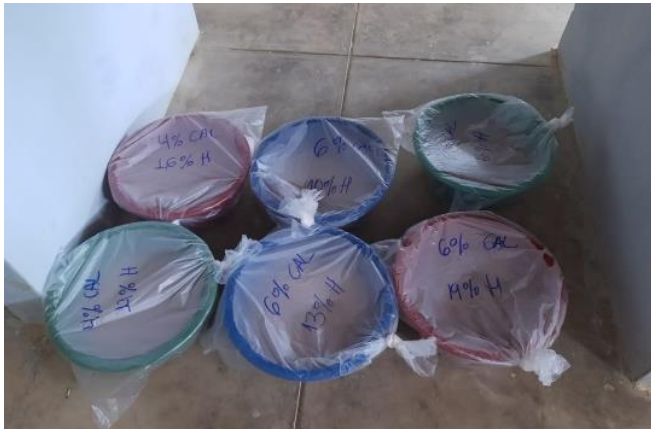
Foto N°23: Material para Proctor modificado con diferentes % de cal hidratada. Calicata 01.
