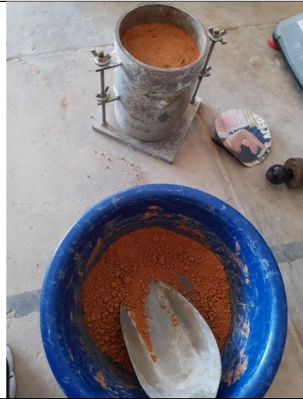
Foto N°28: Preparación de CBR de muestra con diferentes % de cal hidratada. Calicata 01.
