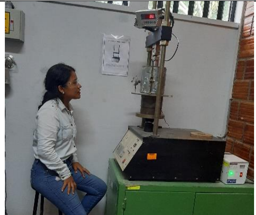
Foto N°50: Moldes de CBR con diferentes % de cal hidratada, después de ensayo. Calicata 02.
