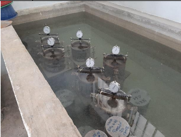
Foto N°49: Moldes de CBR con diferentes % de cal hidratada, sumergido para lectura de expansión. Calicata 02.
