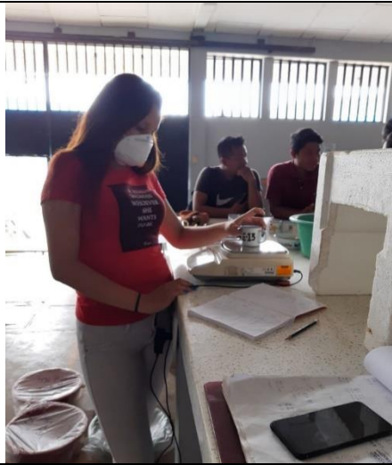
Foto N°21: Preparación de muestras para Límites de Atterberg con cal hidratada. Calicata 01
