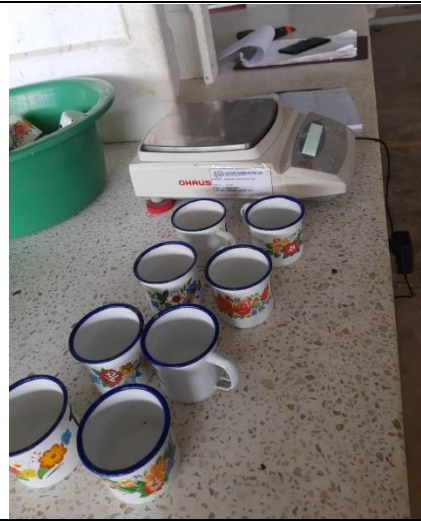
Foto N°22: Preparación de muestras para Límites de Atterberg con cal hidratada. Calicata 01
