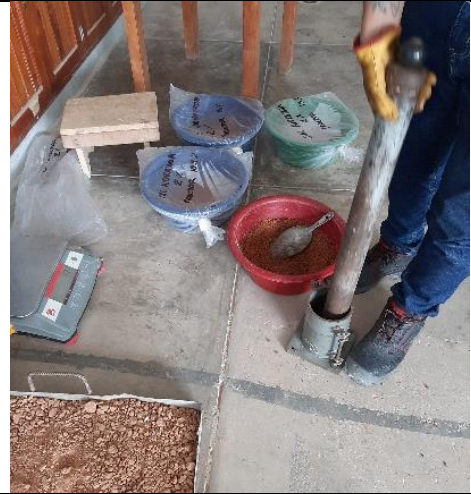
Foto N°46: Proctor modificado del material con diferentes % de cal hidratada. Calicata 02.
