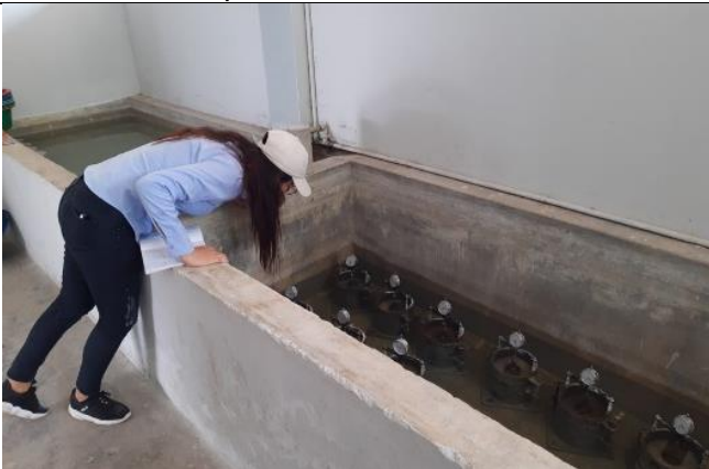
Foto N°29: Moldes de muestra con diferentes % de cal hidrata listo para inmersión. Calicata 01.
