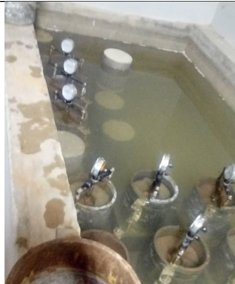
Foto N°43: Moldes de CBR con diferentes % de cal viva, sumergido para lectura de expansión. Calicata 02.
