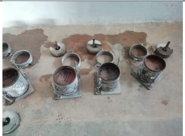
Foto N°42: Lectura de carga de CBR de la muestra con diferentes % de cal viva Calicata 01.
