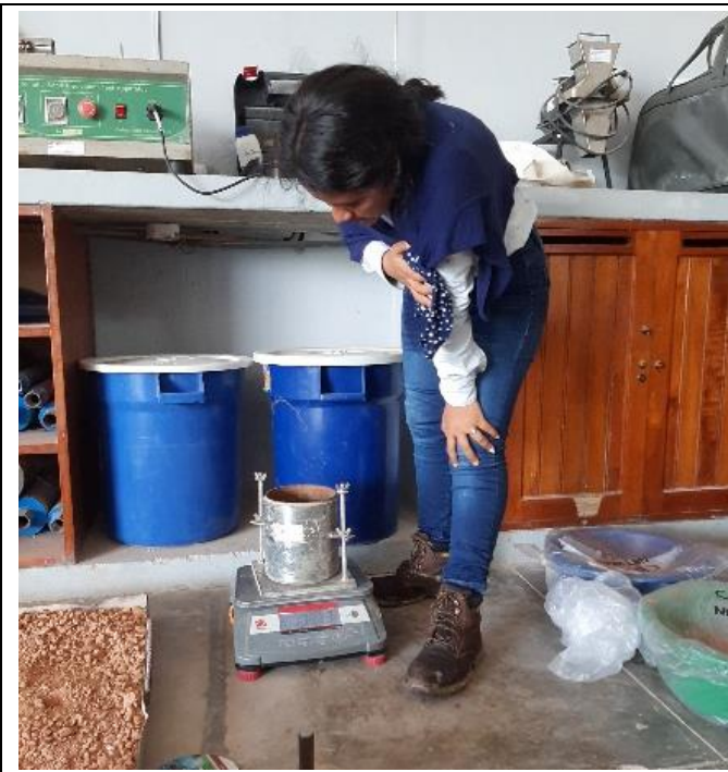
Foto N°17: Pesado de moldes y material natural para ensayo CBR. Calicata 02.
