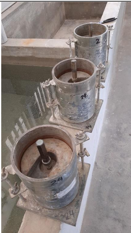
Foto N°17: Pesado de moldes y material natural para ensayo CBR. Calicata 02.
