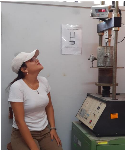
Foto N°35: Lectura de carga de CBR de la muestra con diferentes % de cal hidratada Calicata 01.
