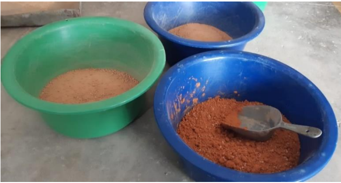
Foto N°47: Preparación de material con diferentes % de cal hidratada para CBR. Calicata 02
