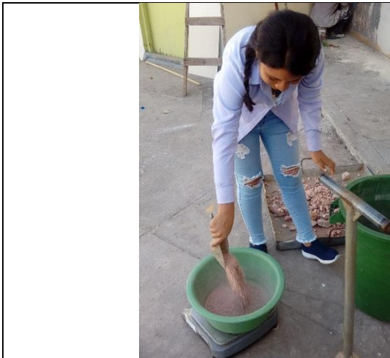
Foto N°39: Pesado de material para preparar con diferentes % de cal viva para CBR. Calicata 01.
