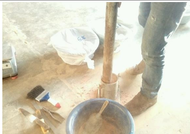
Foto N°11: Ensayo Proctor modificado con diferentes % de humedad. Calicata 01
