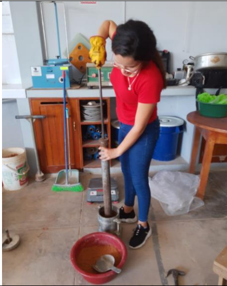
Foto N°27: Preparación de CBR de muestra con diferentes % de cal hidratada. Calicata 01.
