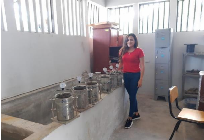
Foto N°27: Preparación de CBR de muestra con diferentes % de cal hidratada. Calicata 01.
