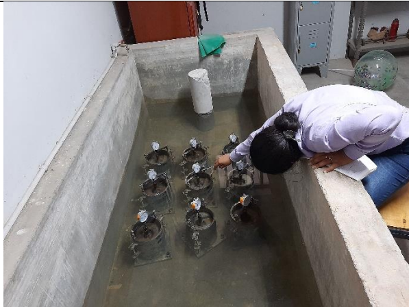
Foto N°53: Lectura de expansión en los moldes de CBR con diferentes % de cal viva. Calicata 02
