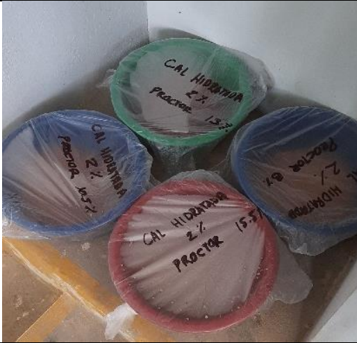
Foto N°45: Preparación de material con diferentes % de cal hidratada para Proctor Modificado. Calicata 02
