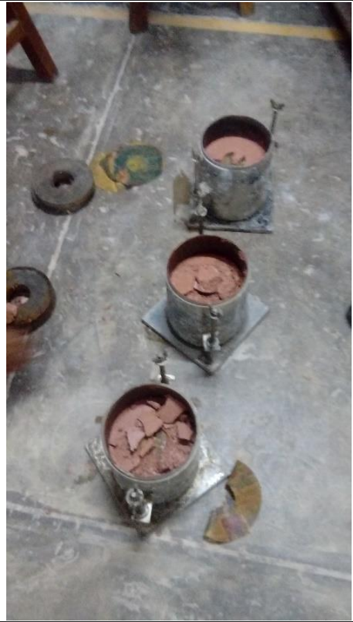
Foto N°14: Ensayo de CBR después de penetración. Calicata 01.
