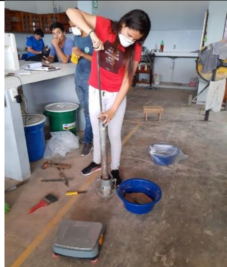
Foto N°24: Ensayo Proctor modificado con diferentes % de humedad. Calicata 01
