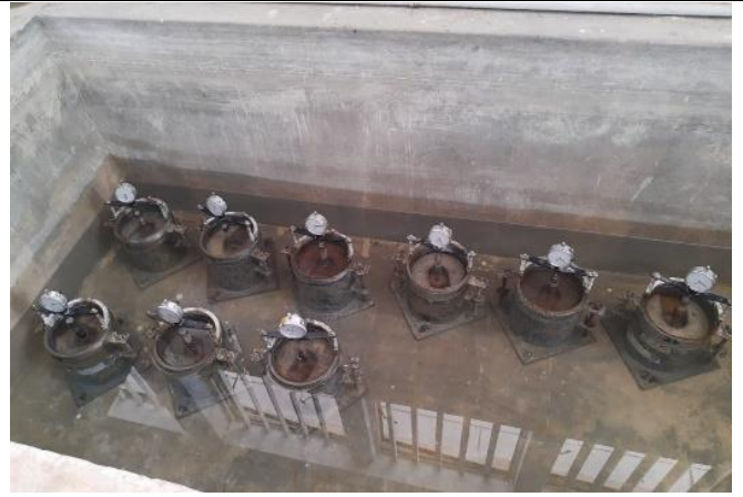
Foto N°28: Preparación de CBR de muestra con diferentes % de cal hidratada. Calicata 01.
