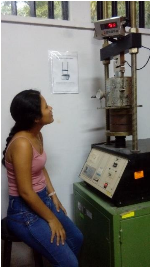
Foto N°13: Ensayo de CBR muestra natural. Calicata 01
