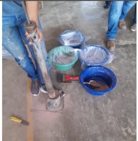
Foto N°26: Ensayo Proctor modificado con diferentes % de humedad. Calicata 01
