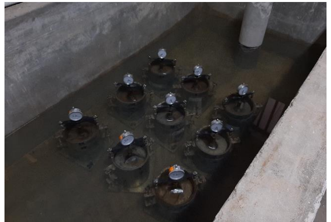
Foto N°52: Moldes de CBR con diferentes % de cal viva, sumergido para lectura de expansión. Calicata 02.
