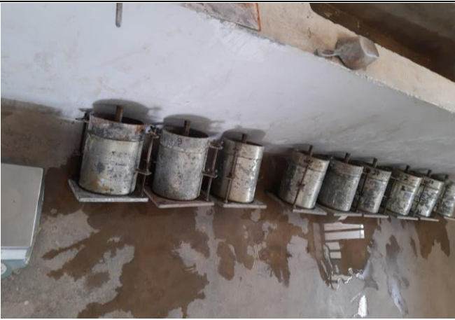
Foto N°33: Se deja reposar el molde de muestra con diferentes % de cal hidratada. Calicata 01.
