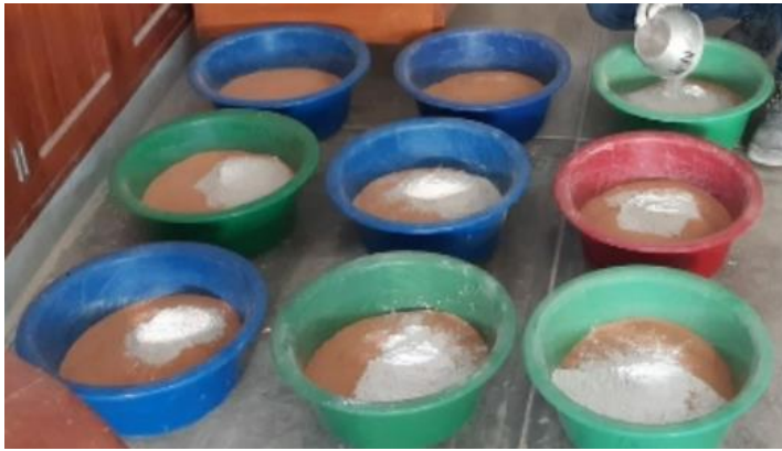
Foto N°51: Preparación de material con diferentes % de cal viva para CBR. Calicata 02
