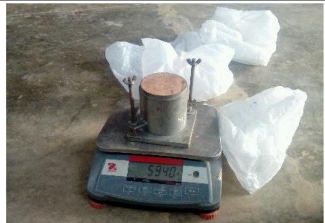
Foto N°12: Ensayo Proctor modificado con diferentes % de humedad. Calicata 01
