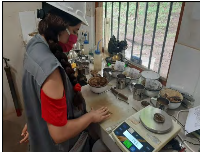
Figura 15: Tomamos una porción de suelo de aproximadamente 1cm 3 , lo amasamos entre las manos y lo hacemos rodar con la palma de la mano en la placa de vidrio.
