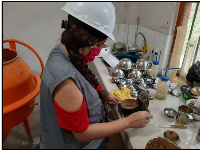
Figura 13: Girando la manivela de la Copa de Casagrande con una frecuencia de 2 golpes por segundo, contando el número de golpes necesarios para que la ranura cierre.
