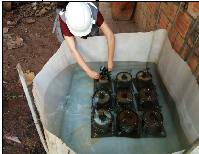
Figura 22: Registrando la lectura inicial con un extensómetro a los especímenes sumergidos en un depósito con agua.
