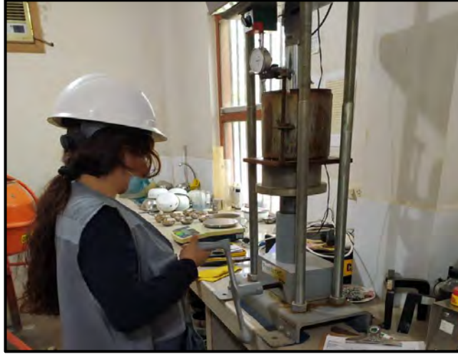
Figura 23: Aplicando una carga equivalente a 4.5 kg sobre el molde con la muestra.
