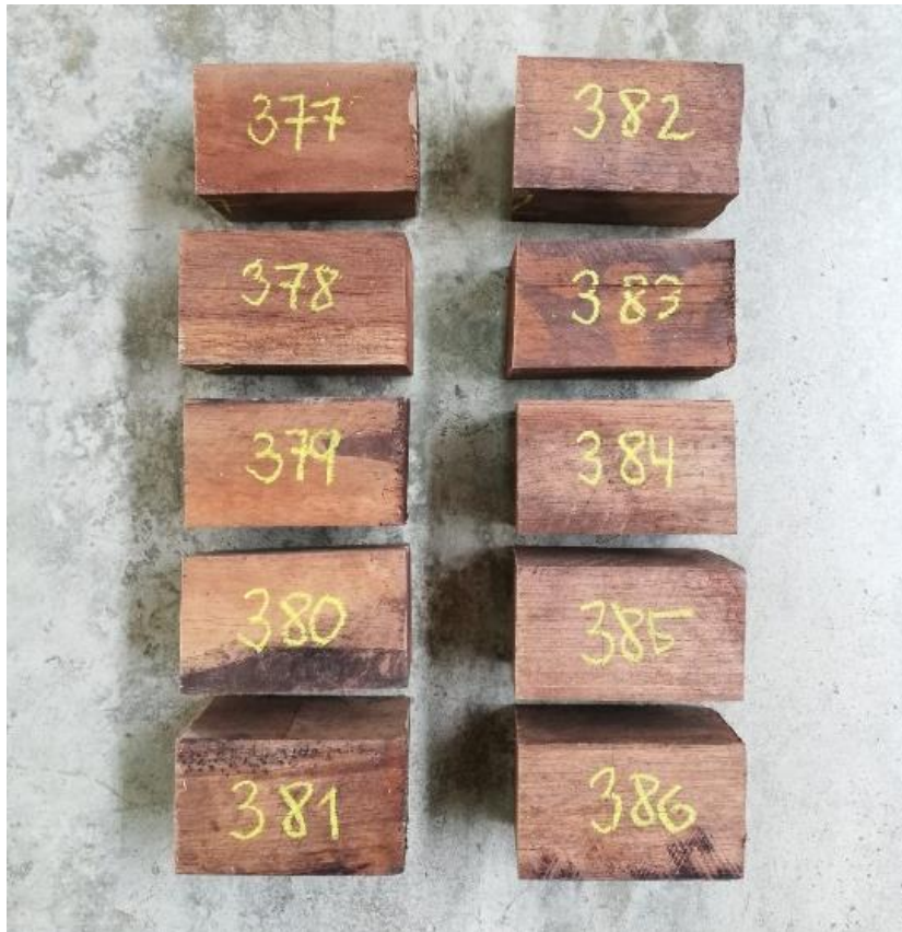
FOTO N° 1. Muestras de para ensayo de Propiedades Físicas, (Humedad, Densidad Básica y Contracción) de medidas de 3cm x 3cm x 10 cm.
