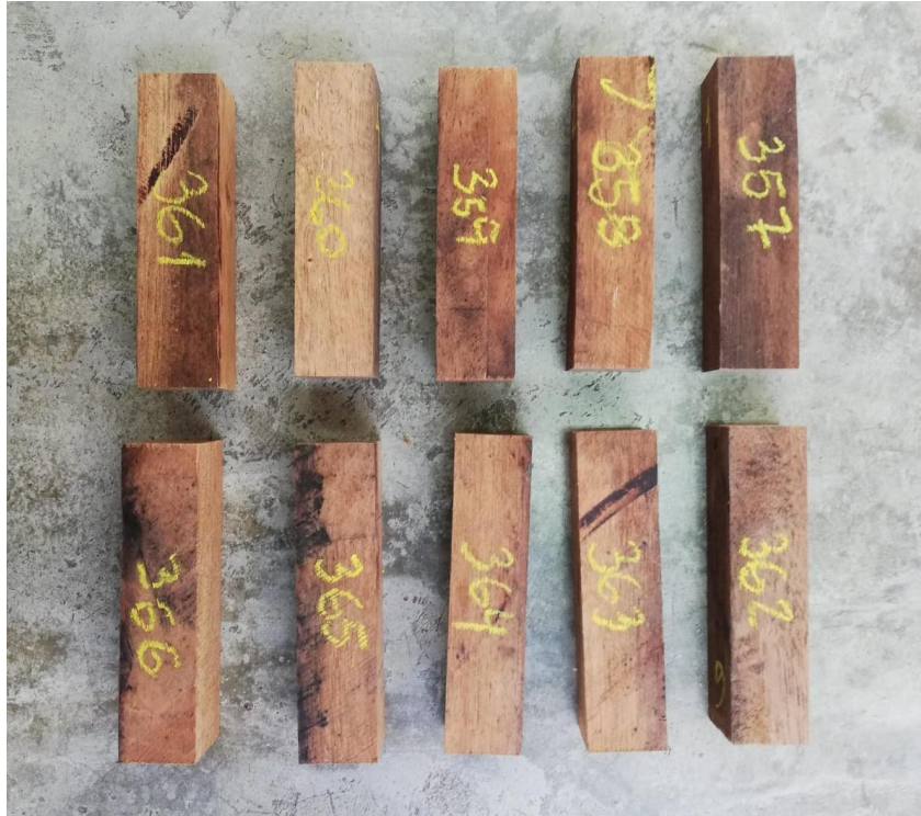
FOTO N° 5. Muestras de para ensayo de Compresión Perpendicular, medidas de 5cm x 5cm x 6.5 cm.
