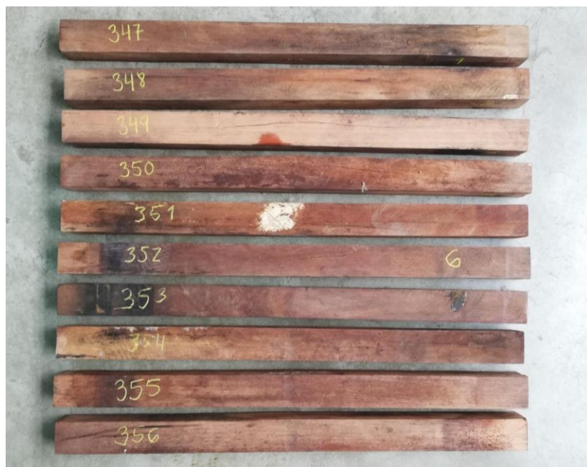
FOTO N° 2. Muestras de para ensayo de Flexión Estática, medidas de 5cm x 5cm x 76 cm
