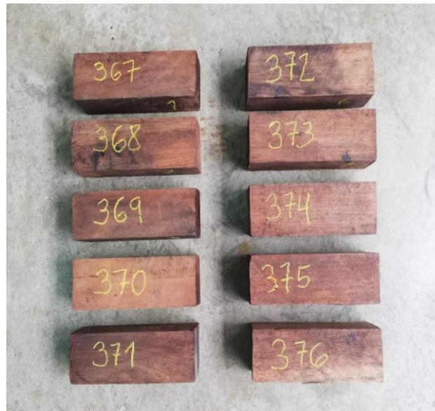
FOTO N° 3. Muestras de para ensayo de Compresión Paralela a la fibra, medidas de 5cm x 5cm x 20 cm.
