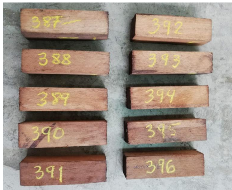
FOTO N° 4. Muestras de para ensayo de Compresión Perpendicular, medidas de 5cm x 5cm x 15 cm.
