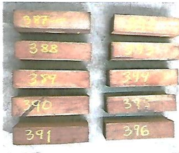
Figura 1. Probetas para ensayos de propiedades físicas (humedad, densidad y contracción).
