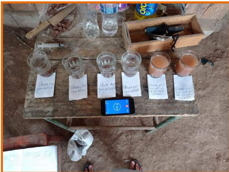
Img. N° 12: Ensayo de Emerson Crumb
