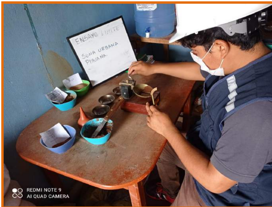
Img. N° 10: Realización de los ensayos de límites de atterberg
