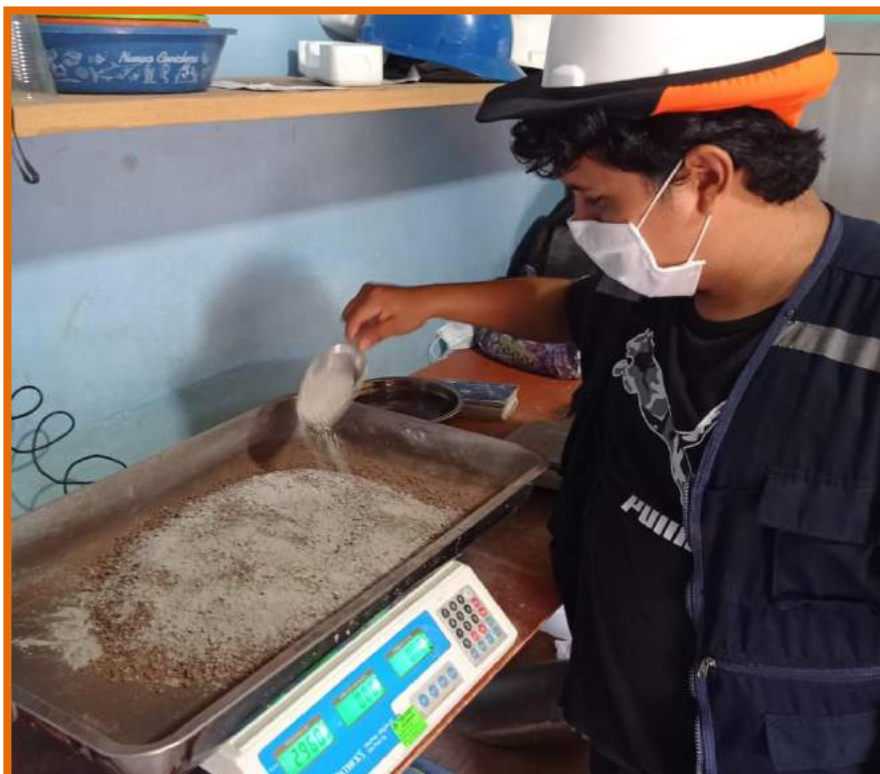
Img. N° 14: Estabilización con adición de cemento
