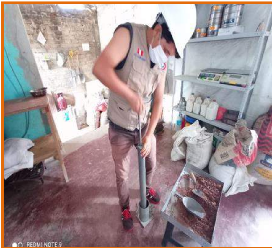
Img. N° 08: Proceso de los ensayos de compactación
