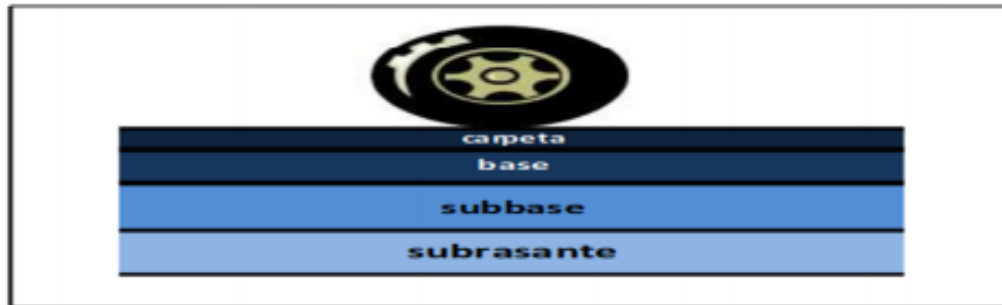
‘Esquema típico de un paquete estructural de un pavimento
