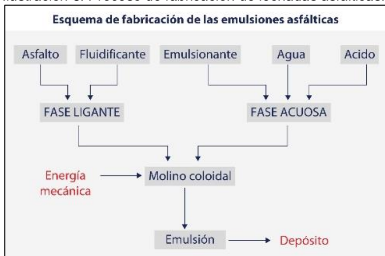
Ilustración 6: Proceso de fabricación de lechadas asfálticas.
