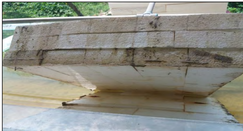
Imagen 37: Prototipo 04 – Terraplén- falla por flotabilidad Fuente: Propia
