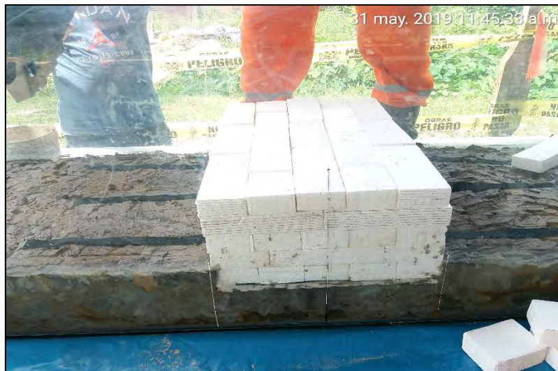
Imagen 35: Prototipo terminado antes del ensayo de inundación Fuente: Propia
