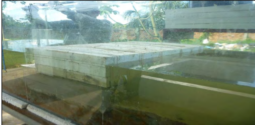
Imagen 38: Segundo ensayo de inundación del Prototipo 04 Fuente: Propia
