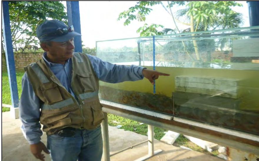
Imagen 40: Prototipo 04 sumergido con la simulación de la inundación Fuente: Propia
