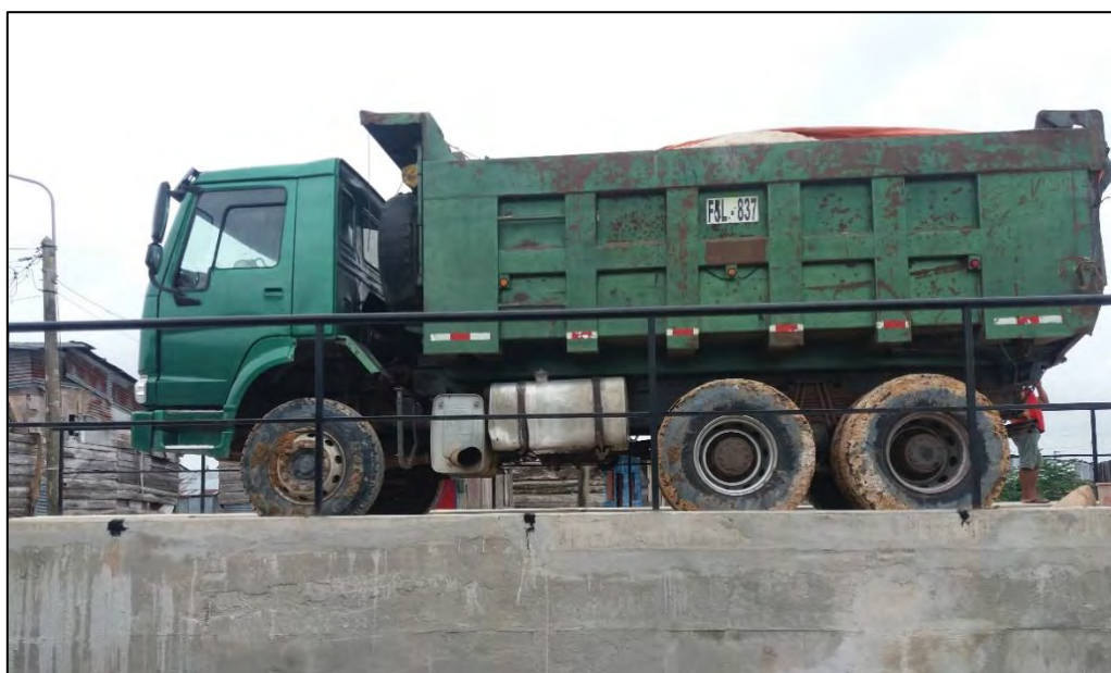
Imagen 96: Vehículo usado para la prueba de carga Fuente: Propia
