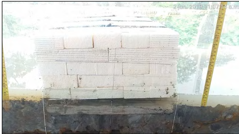
Imagen 36: Prototipo 04 - ensayo de inundación Fuente: Propia
