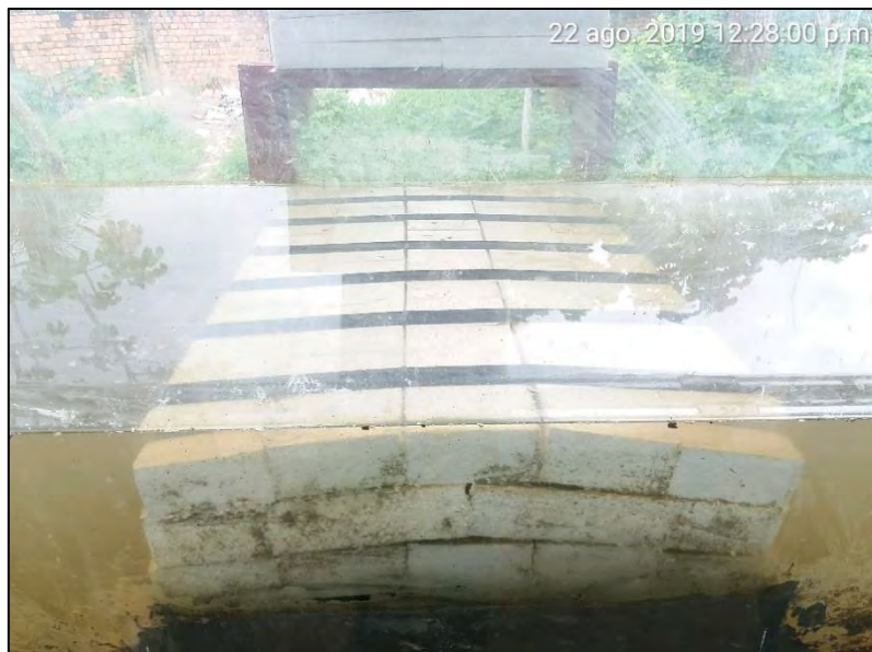
Imagen 41: Deflexión céntrica producido por la flotabilidad del material Fuente: Propia
