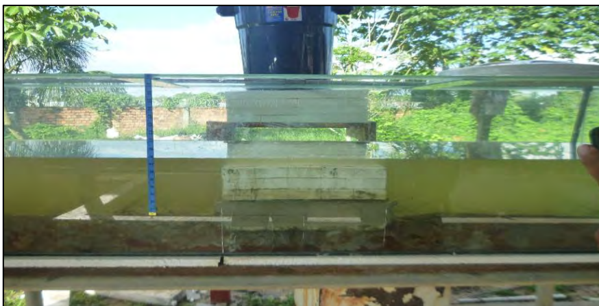
Imagen 39: Prototipo 04 sumergido con la simulación de la inundación Fuente: Propia
