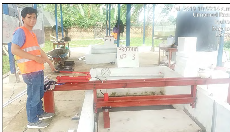
Imagen 44: Control de esfuerzo en la prensa hidráulica antes del inicio de las pruebas Fuente: Propia
