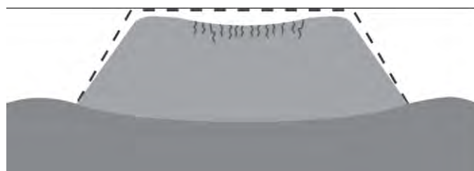
Imagen 3: Falla por Capacidad Portante
