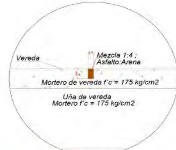
CORTE 1-1 DETALLE JUNTA
