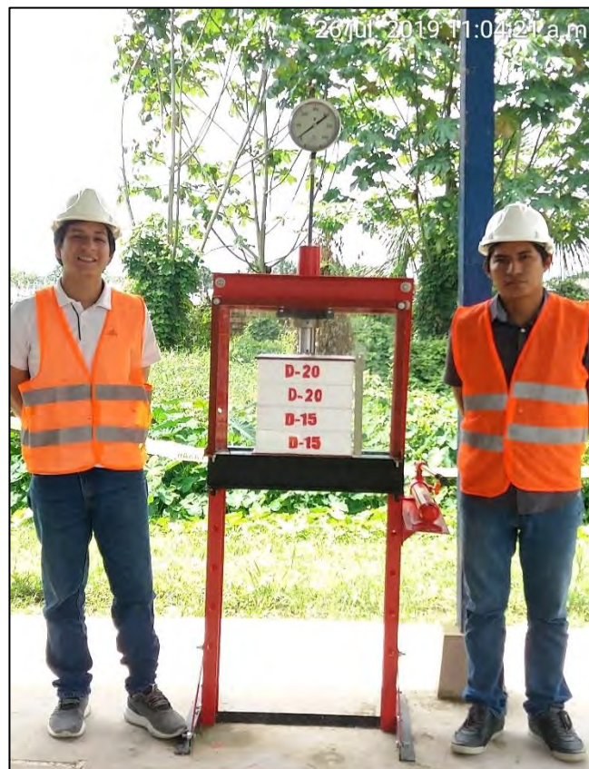
Imagen 46: Ensayo de compresión para bloques de geospuma Fuente: Propia
