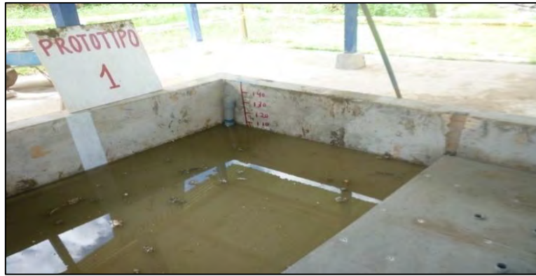
Imagen 30: Ensayo de inundación del Prototipo 01 Fuente: Propia
