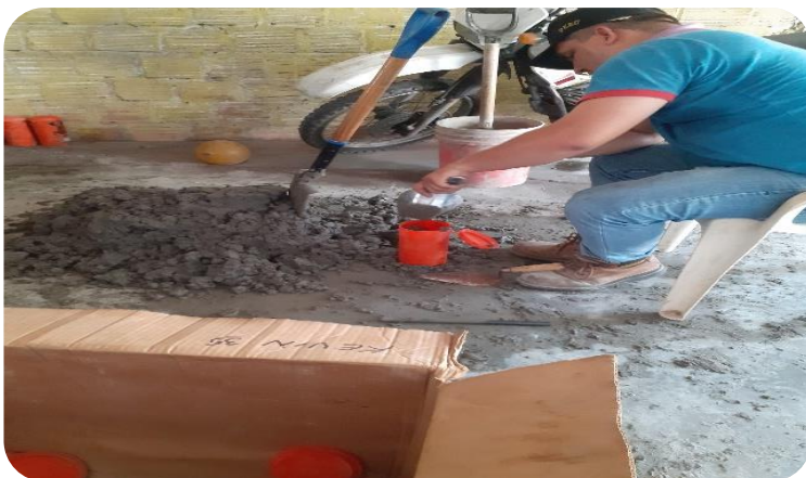
Foto 18: vaceo de material mezclado a probetas
