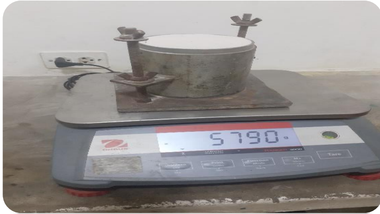
Foto 3: Peso de agregado fino seco compactado 1
