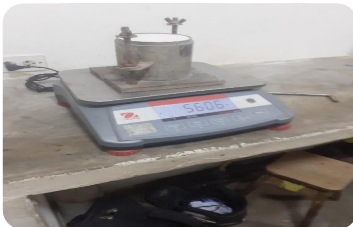
Foto 5: Peso de agregado fino seco compactado 3
