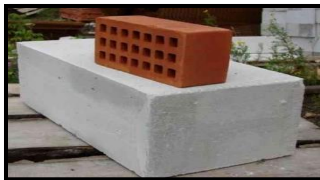
Ilustración 2: Comparativo Dimensiones del Concreto Celular
