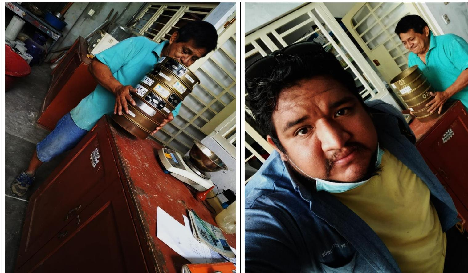
**Foto 3 y 4:** De Izquierda a Derecha, tamizado de agregado fino
