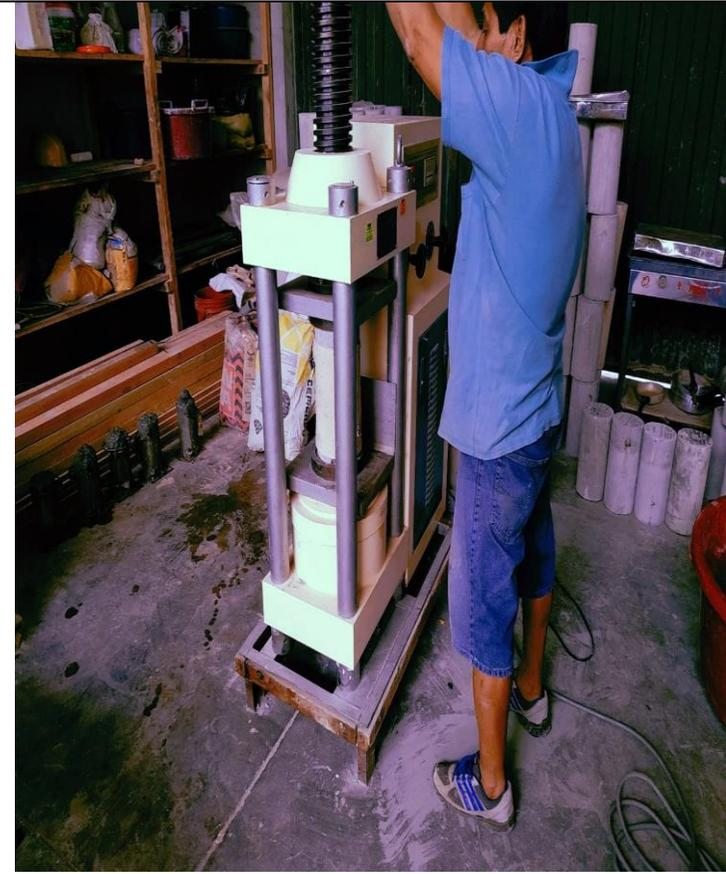
**Foto 9:** Rotura de probetas, este ensayo consistió en aplicar una carga axial en compresión a los moldes cilíndricos.
