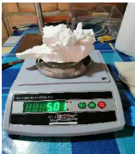
Fig. 3.3. Solubilización de poliestireno expandido en aceite esencial de naranja.
