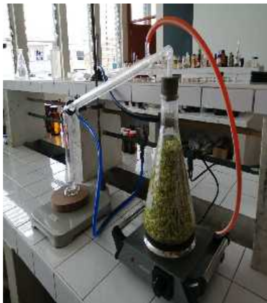
Fig. 2.3. Extracción del aceite esencial mediante destilación por arrastre de vapor tipo Clevenger.
