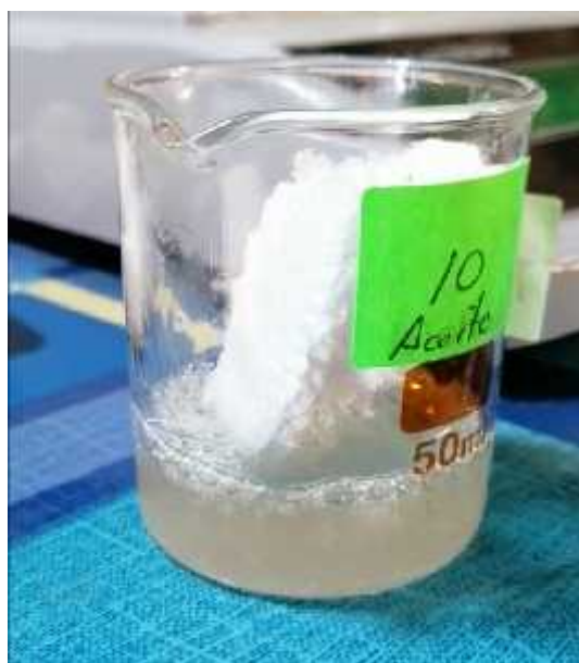
Fig. 3.3. Solubilización de poliestireno expandido en aceite esencial de naranja.
