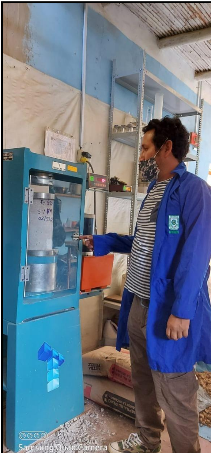
Fotografía 09: Pruebas a la compresión de las probetas
