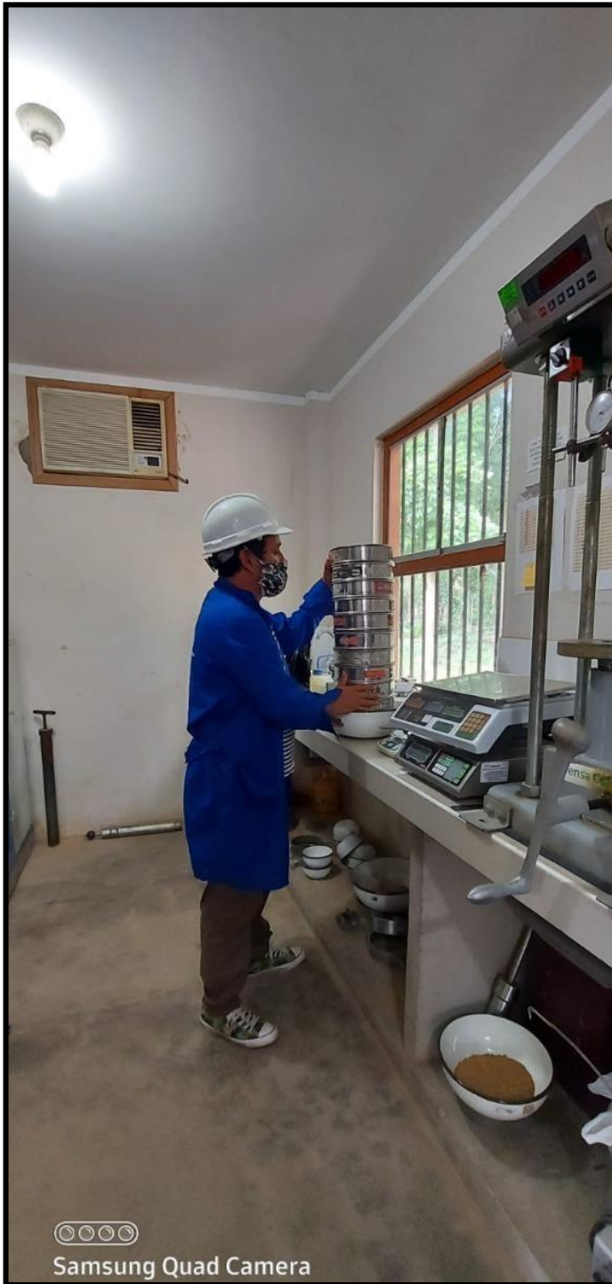
Fotografía 05: Ensayo de granulometría del agregado fino
