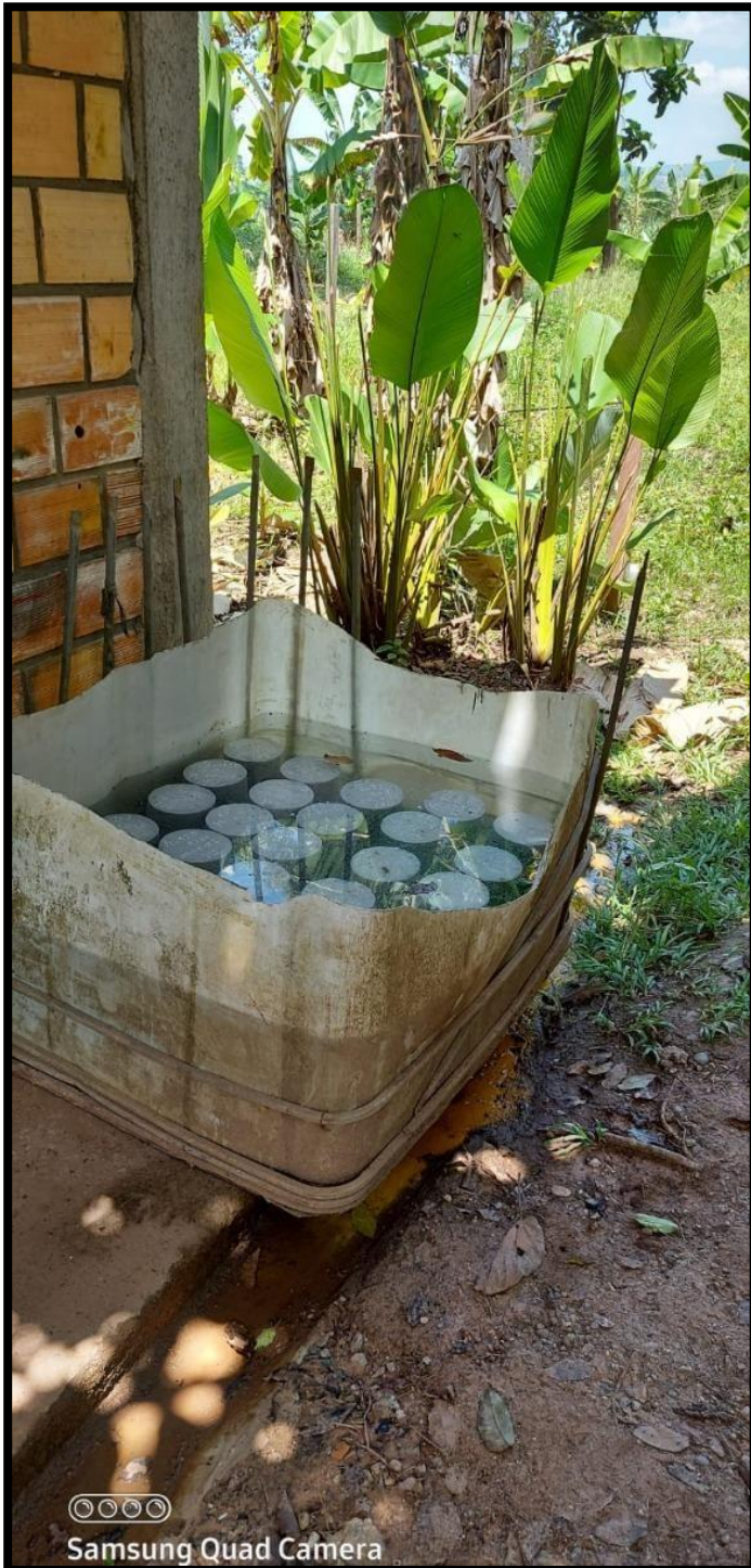
Fotografía 07: Fraguado de las probetas
