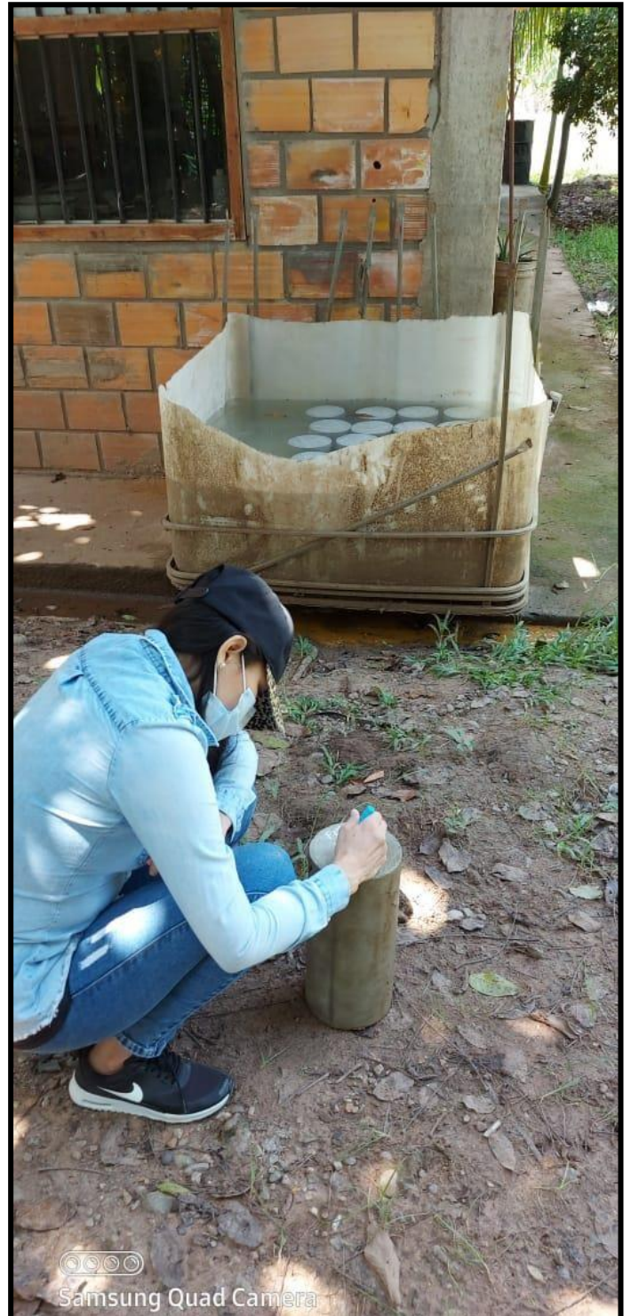
Fotografía 10: Etiquetado de las probetas
