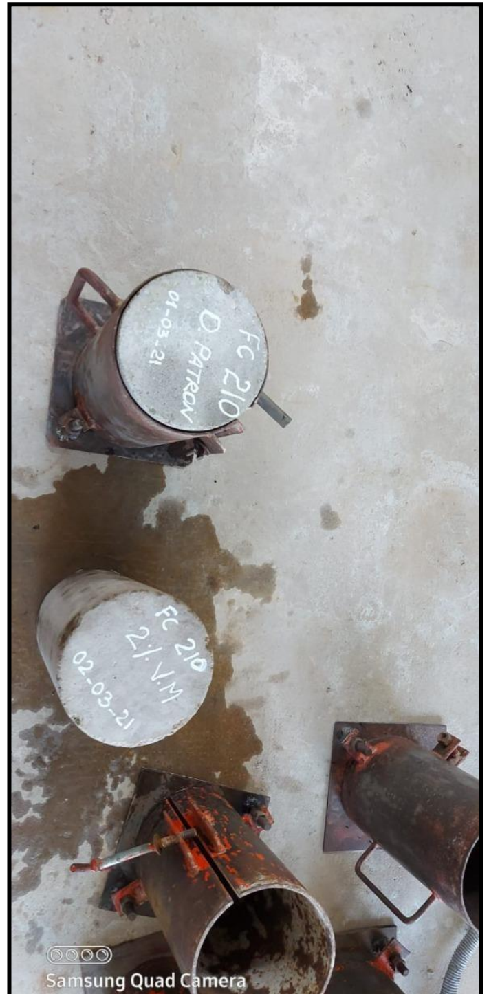
Fotografía 08: Retiro de probetas de sus respectivos moldes
