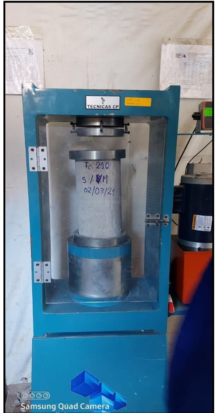
Fotografía 02: Colocación de probetas para su rotura
