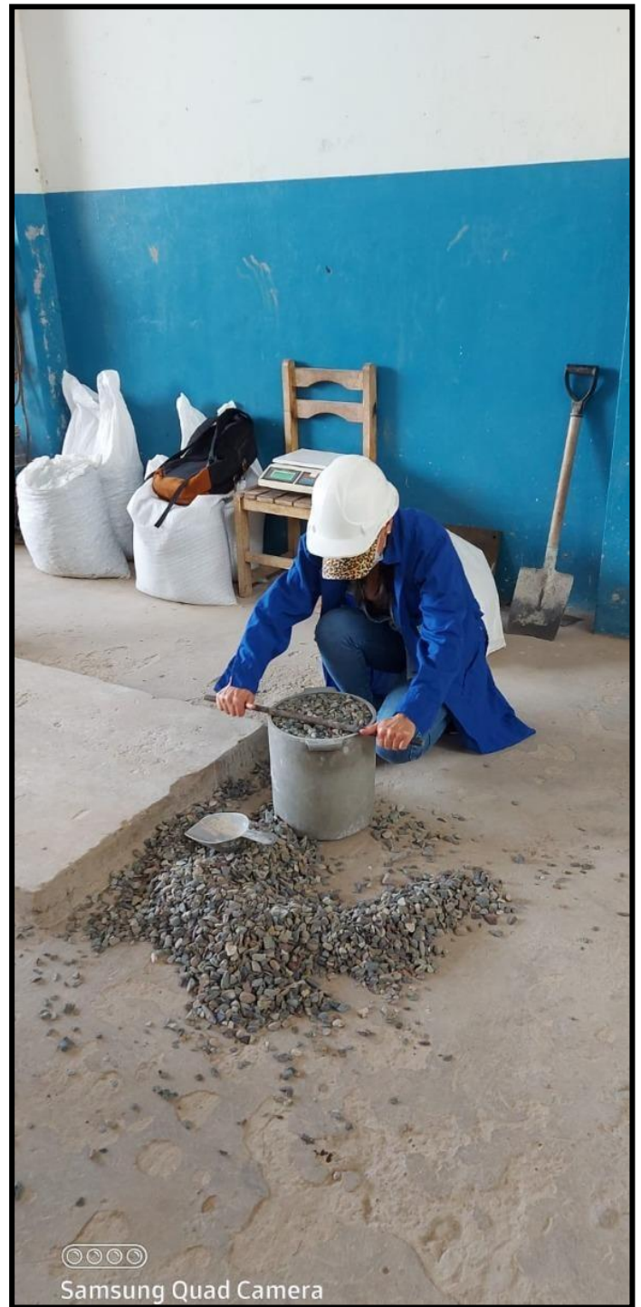
Fotografía 06: Ensayo de peso unitario Suelto del agregado grueso
