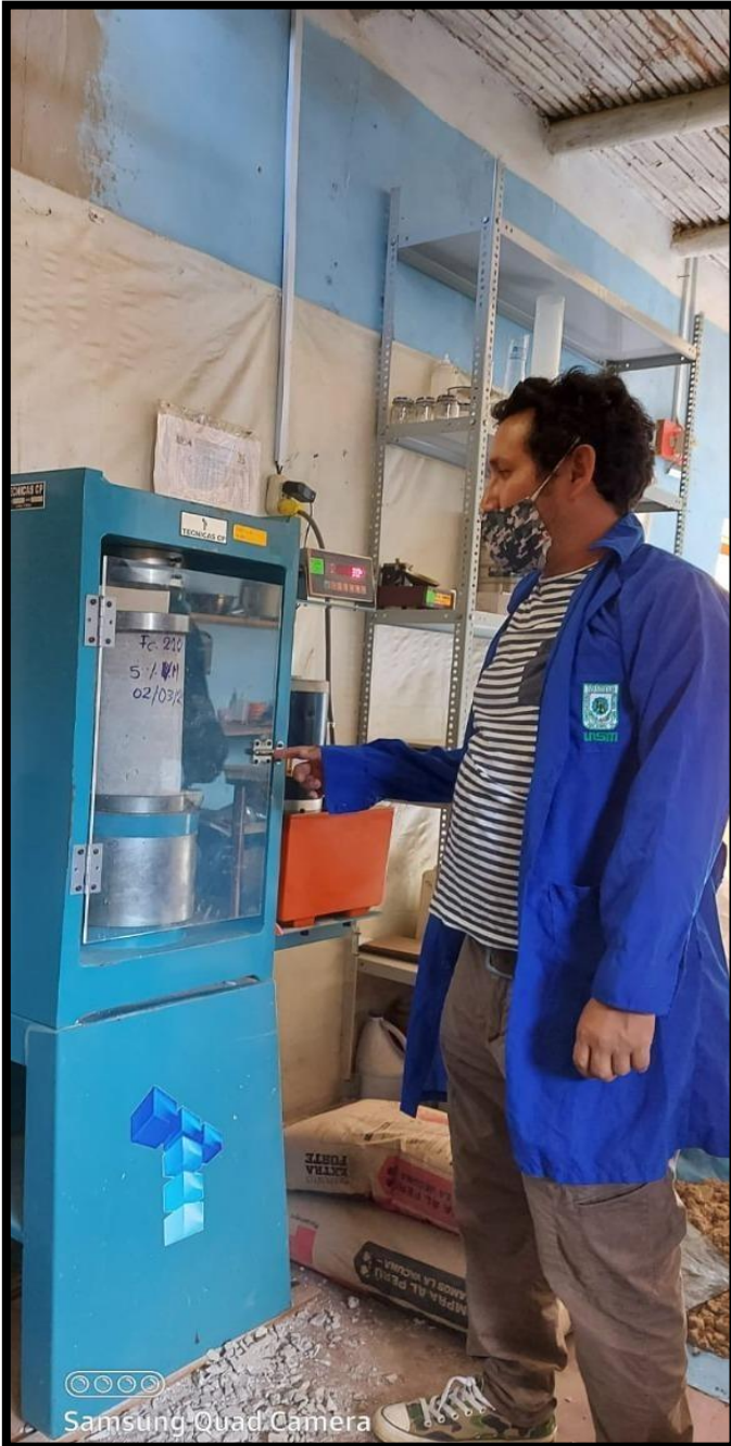
Fotografía 01: Rotura de probetas
