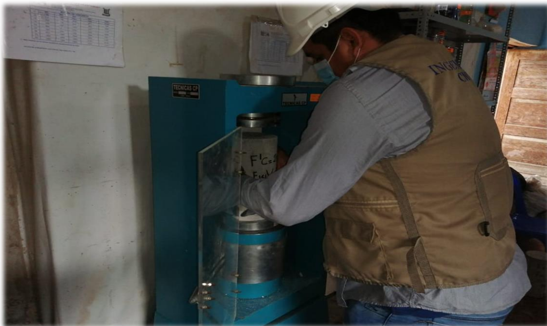
FOTOGRAFÍA N° 14: ensayo de resistencia a la compresión del concreto
