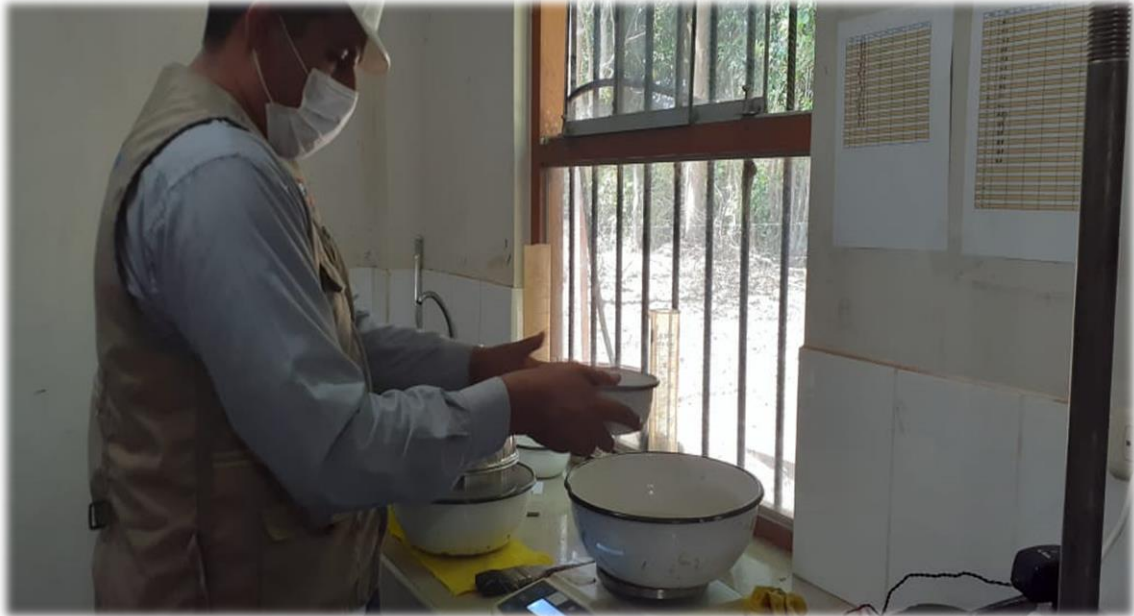
FOTOGRAFÍA N° 03: Ensayo de granulometría del agregado fino.
