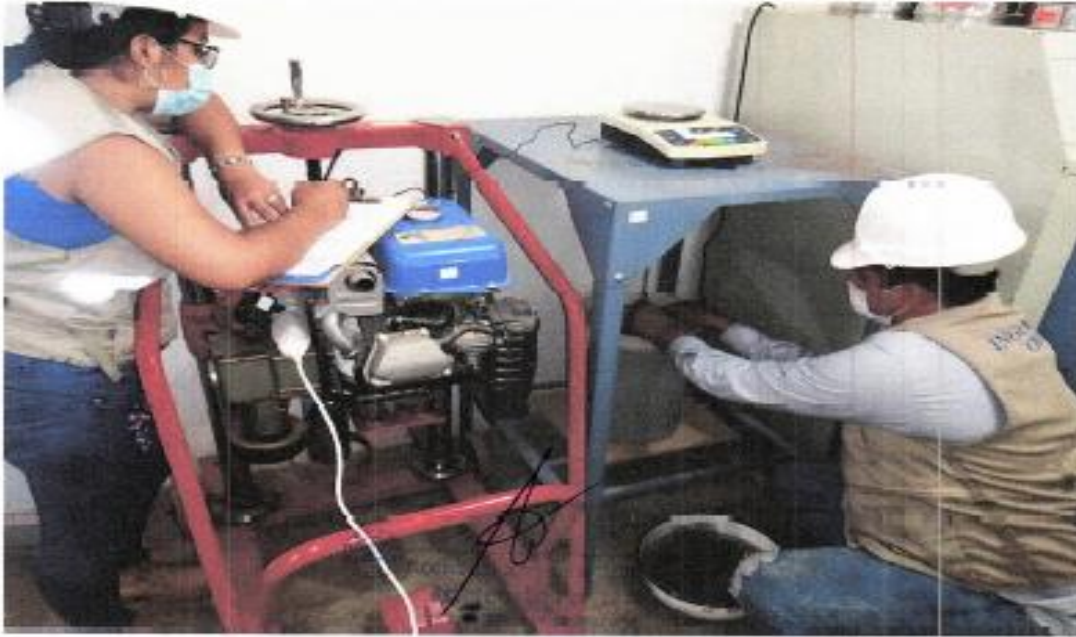
FOTOGRAFÍA N° 07: ensayo de peso específico del agregado grueso
