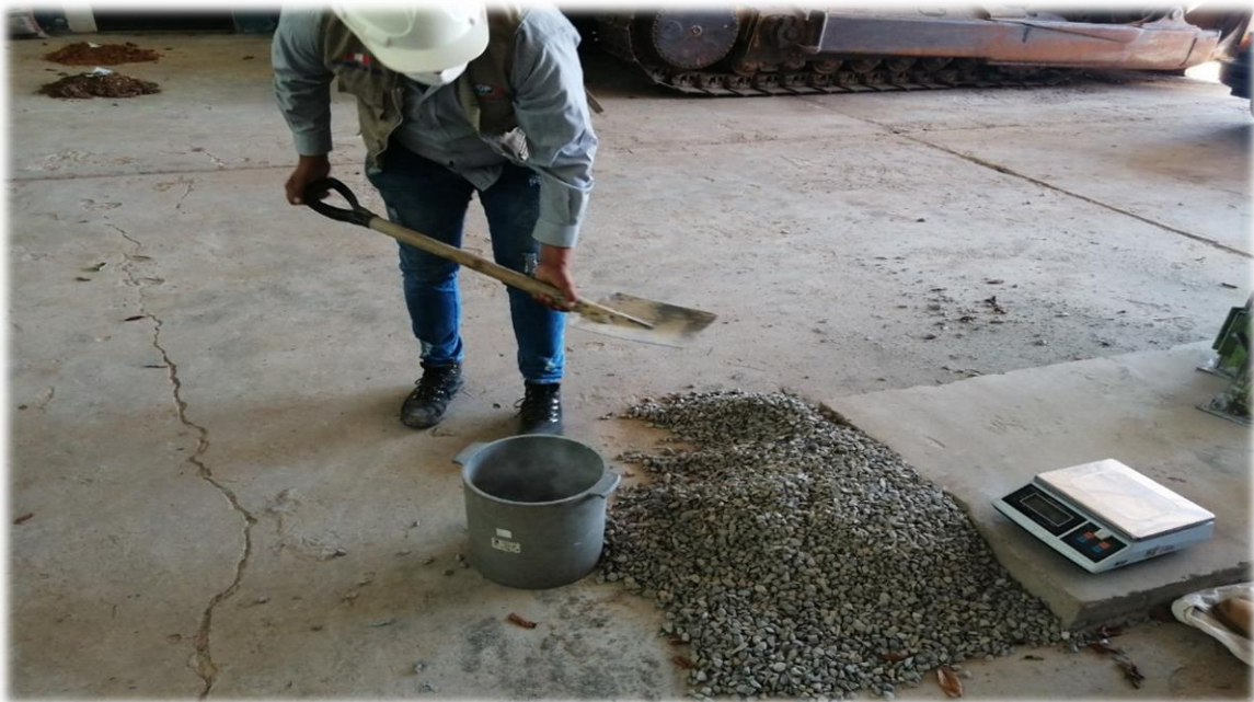
FOTOGRAFÍA N° 04: Ensayo de pesos unitarios suelto.
