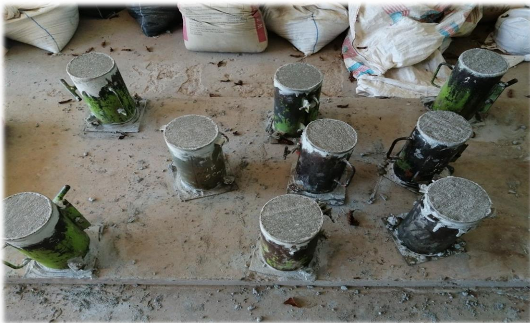
FOTOGRAFÍA N° 10: elaboración de los testigos de concreto
