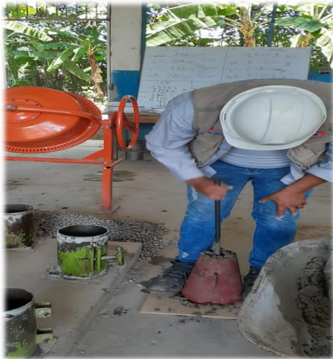
FOTOGRAFÍA N° 09: Ensayo de Slamp con el cono de Abrams
