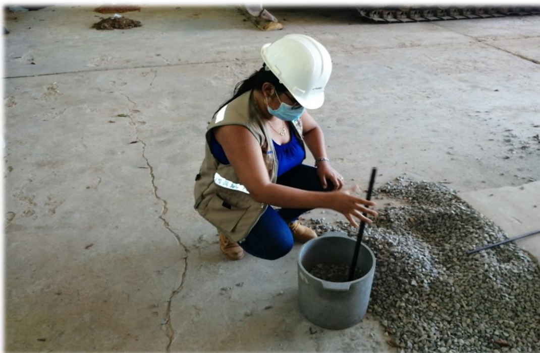
FOTOGRAFÍA N° 05: Ensayo de pesos unitarios compactado
