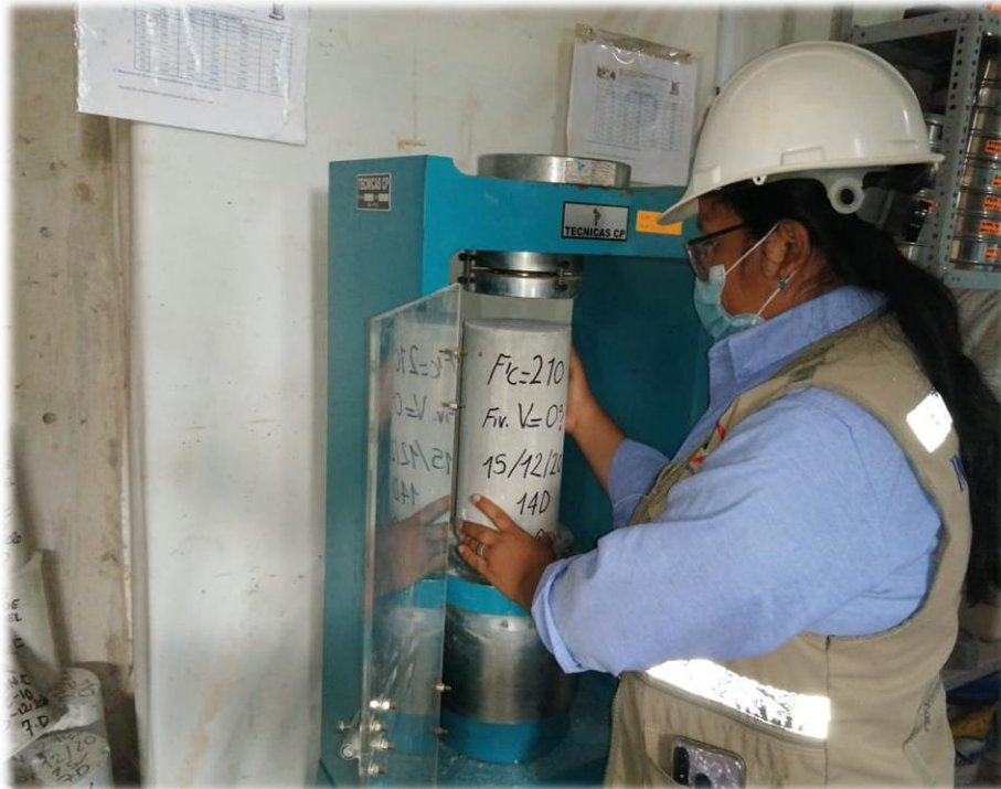
FOTOGRAFÍA N° 13: ensayo de resistencia a la compresión del concreto.
