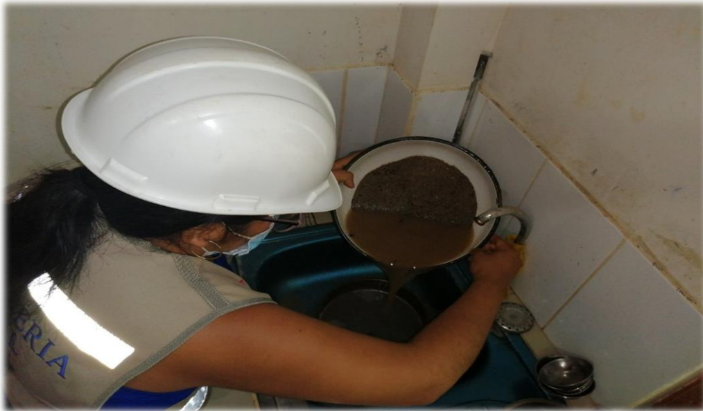
FOTOGRAFÍA N° 02: Ensayo de lavado de muestra para granulometría del agregado fino.
