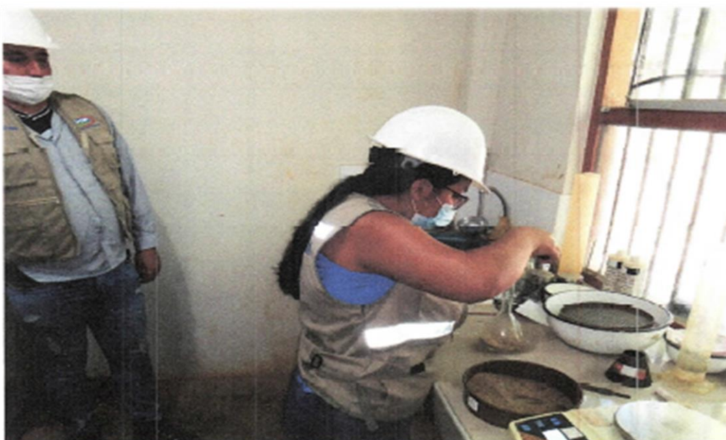
FOTOGRAFÍA N° 06: Ensayo de peso específico del agregado fino
