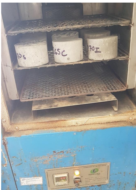
Figura N° 06: Secado al horno a una temperatura de 110 \pm 5^{\circ}\text{C} por no menos de 24h.
