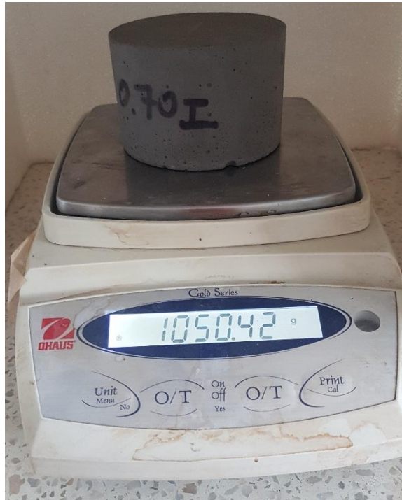
Figura N° 08: Determinación del peso después de estar sumergido 48h en agua
