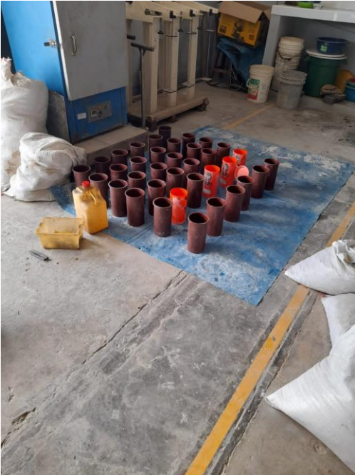
15. Vaciado del concreto cemento – arena en los moldes de 4"x8"
