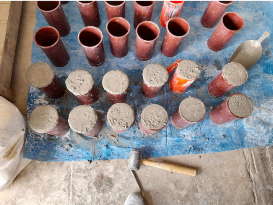
15. Vaciado del concreto cemento – arena en los moldes de 4"x8"
