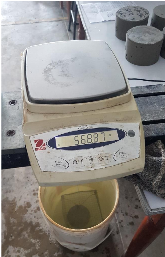
Figura N° 12: Masa sumergida aparente de las muestras
