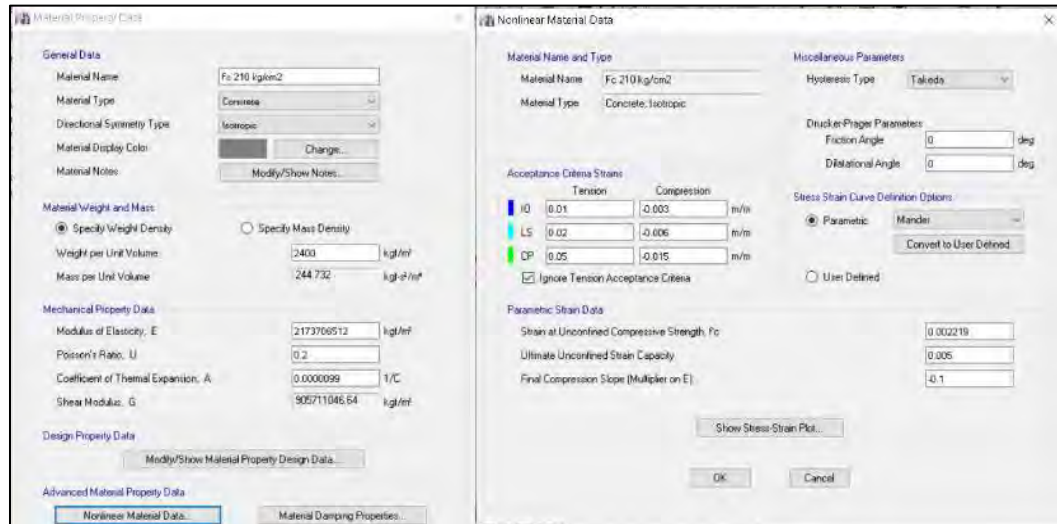
Figura N° 34: Propiedad No lineal de concreto Fc 210 Kg/cm2.
