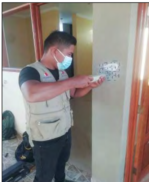
Figura N° 07: Ensayo de Esclerometría.
