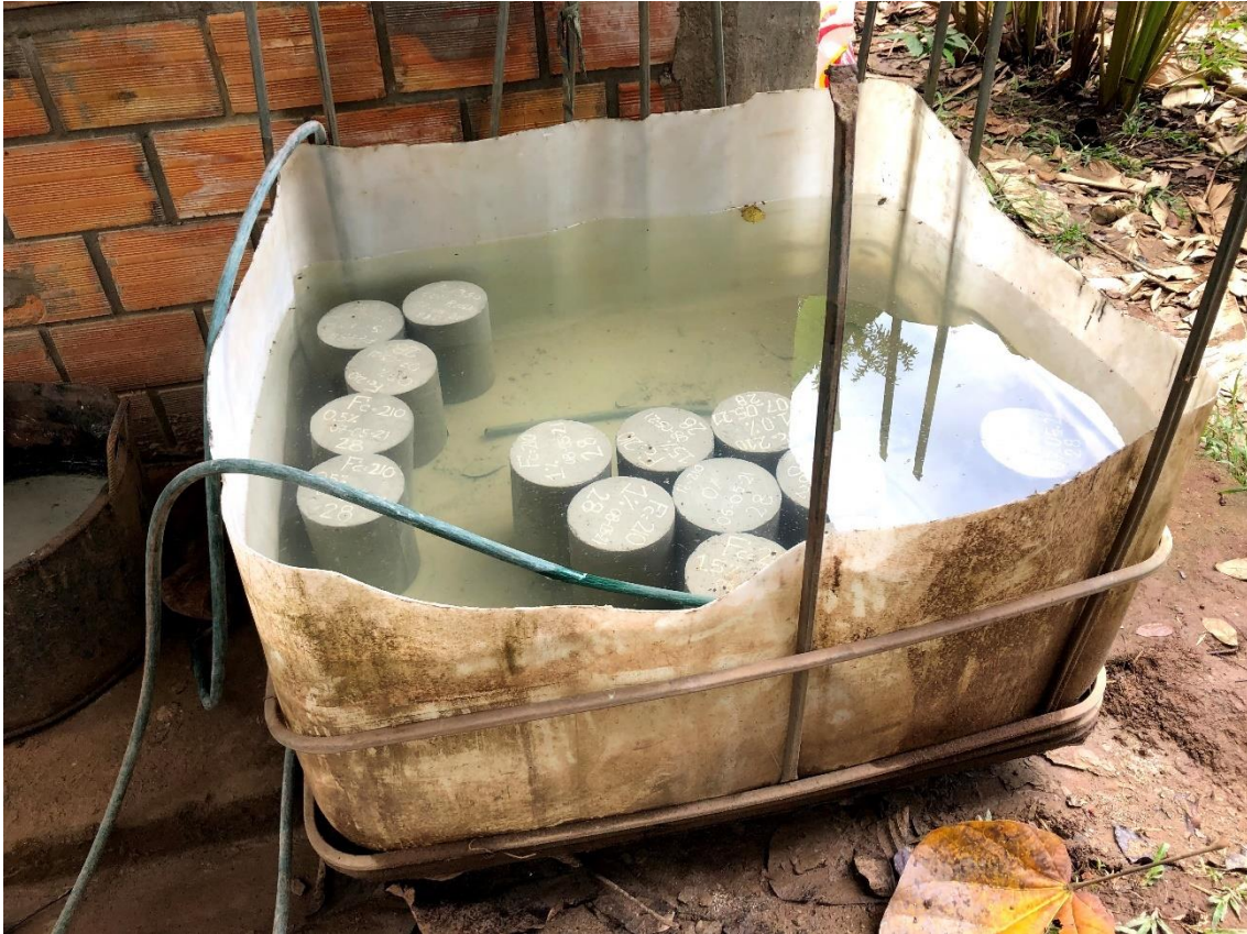
Fotografía 13. Curado de especímenes a edades de 7 y 28 días.
