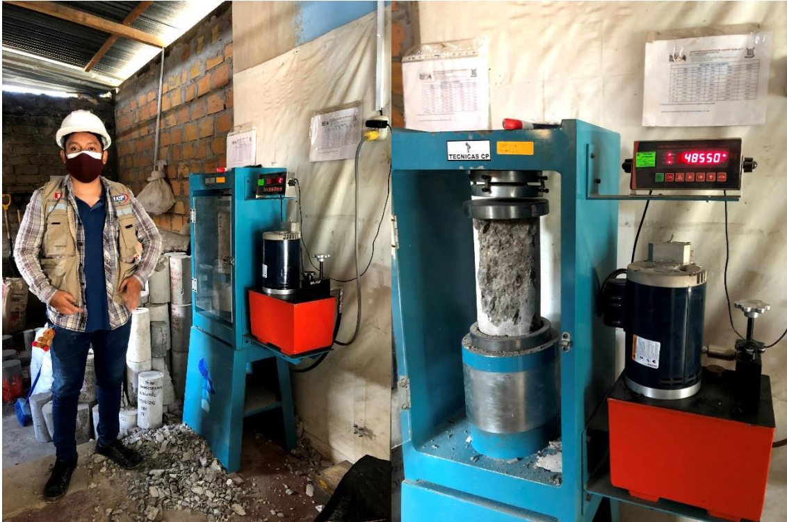
Fotografía 15. Realización de ensayos a compresión y análisis del tipo de falla de la mezcla 1.0% de aditivo
