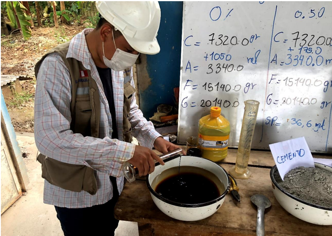
Fotografía 07. Preparación del aditivo Sika CEM Plastificante mezclado con agua de diseño para cada proporción de mezcla experimental.
