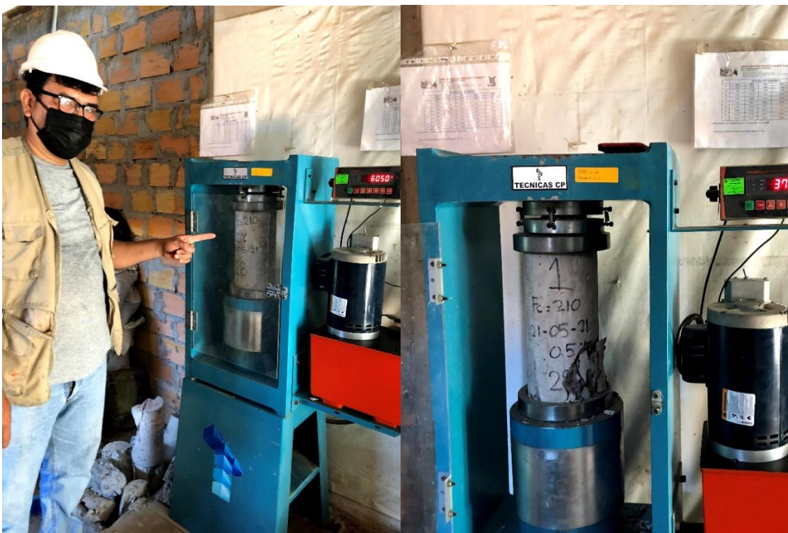
Fotografía 14. Realización de ensayos a compresión y análisis del tipo de falla de la mezcla 0.5% de aditivo.
