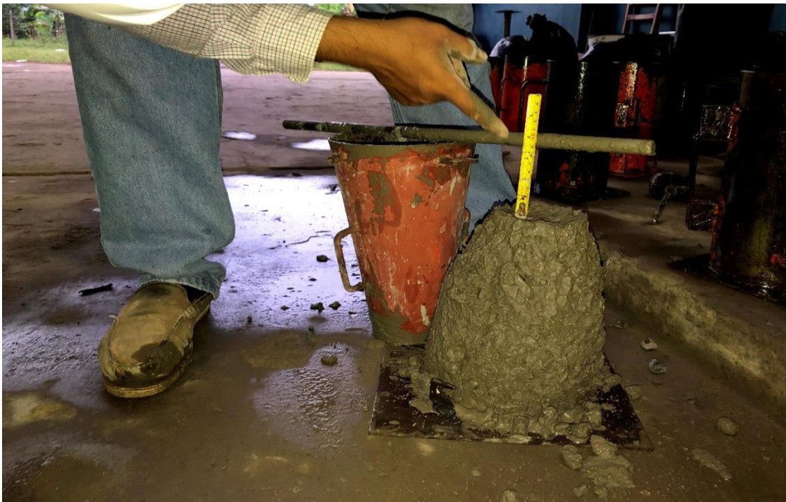
Fotografía 10. Ensayos de revenimiento del concreto para cada grupo de mezcla.
