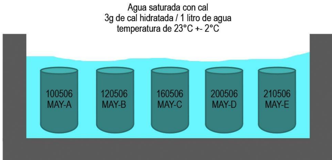
Figura 07. Curada de especímenes de concreto.
