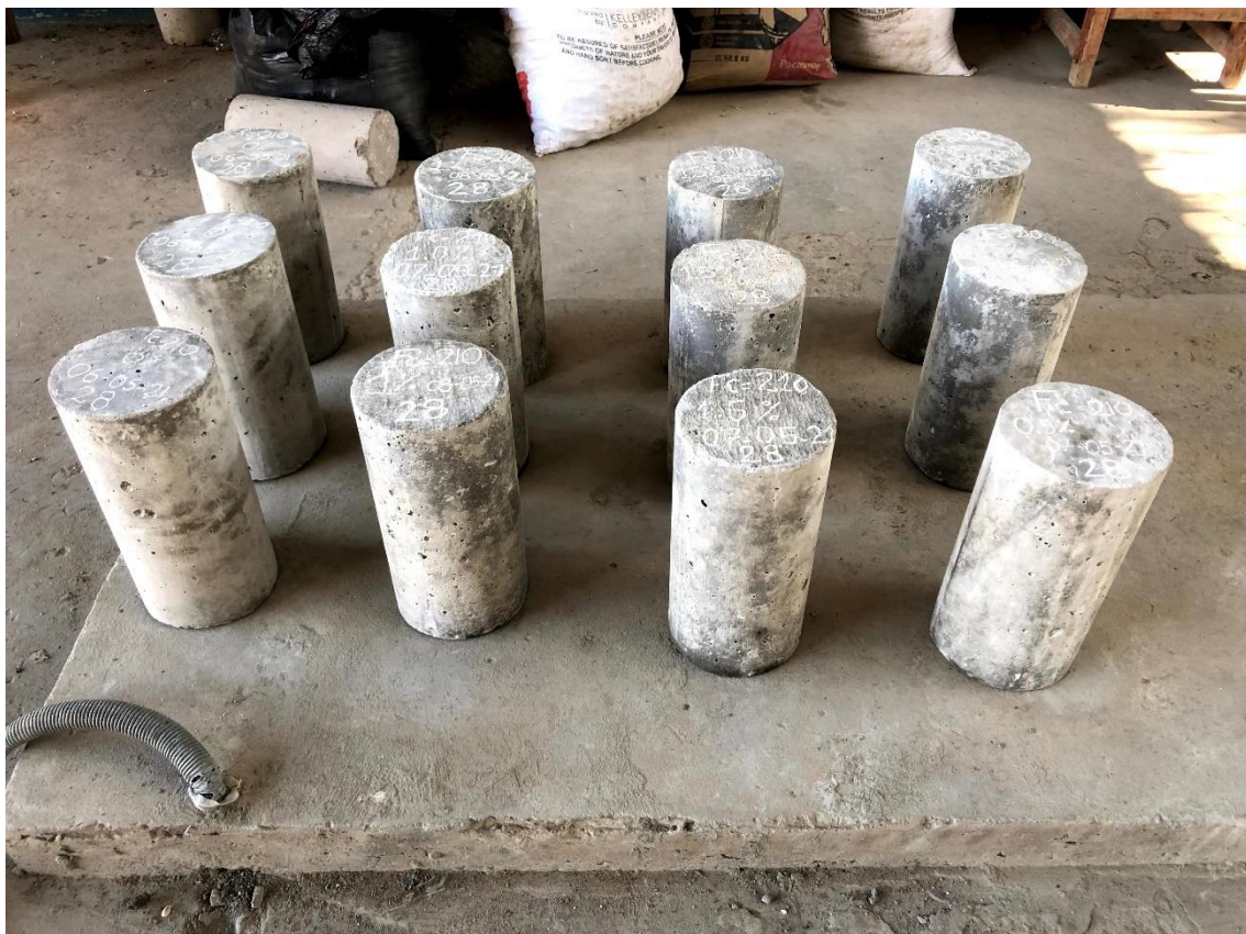
Fotografía 12. Especímenes de concreto desencofrados y secados, listos para ser curados por 7 y 28 días.
