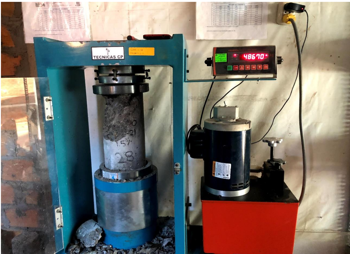
Fotografía 16. Realización de ensayos a compresión y análisis del tipo de falla de la mezcla 1.5% de aditivo.
