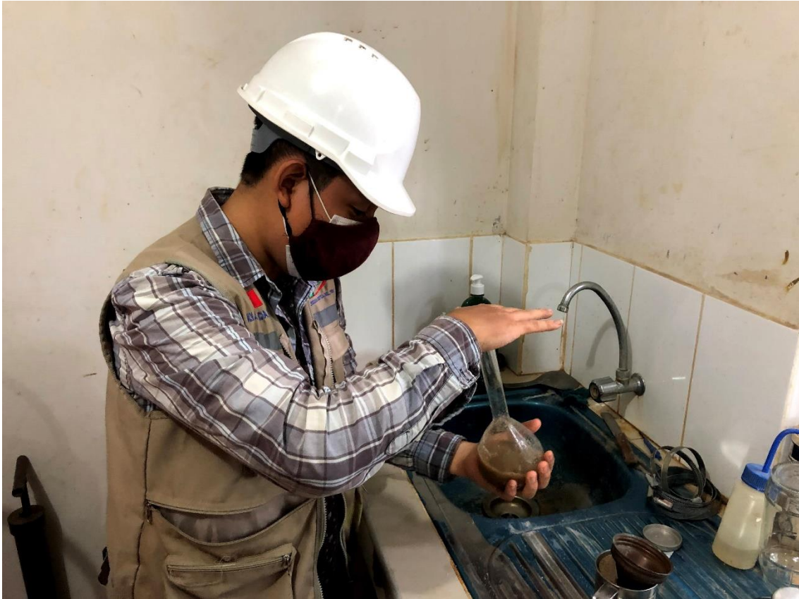
Fotografía 05. Ensayos para la determinación de las características físicas y mecánicas del agregado fino: Peso unitario y peso específico.
