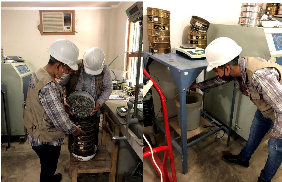
Fotografía 04. Ensayos para la determinación de las características físicas y mecánicas del agregado grueso: granulometría y peso específico.
