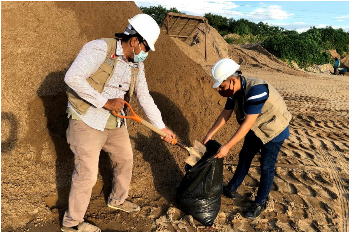
Fotografía 02. Visita y análisis de la cantera del Rio Cumbaza para la selección de agregados finos.
