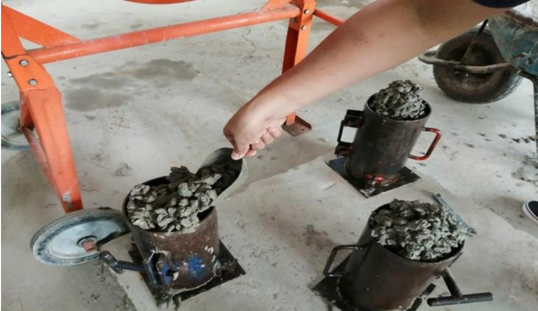
Gráfico N°24: Moldeado de testigos de concreto
