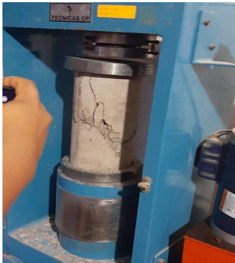
Gráfico N°25: Rotura de testigos de concreto
