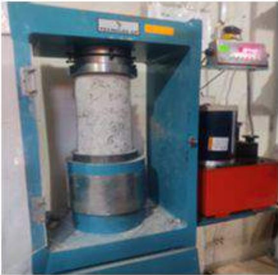
Foto N° 32: Ensayo de roturas de probetas de concreto a edad de 28 días
