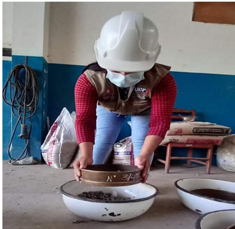
**Foto N° 25:** Pesos Unitarios compactado, ensayo de agregado grueso.
