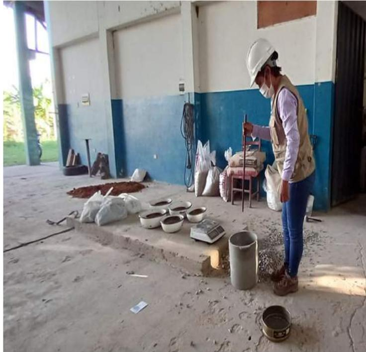
**Foto N° 26:** Ensayo del peso específico de la grava
