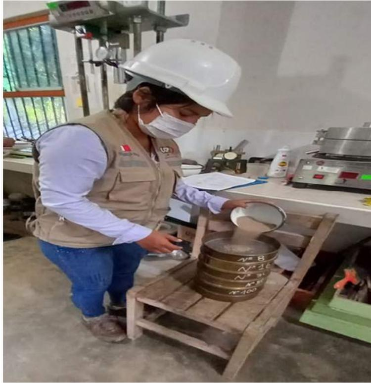
**Foto N° 24:** Granulometría de ensayo de agregado grueso
