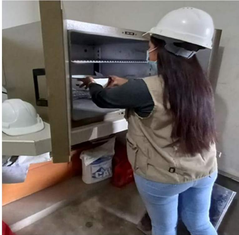
**Foto N° 28:** Absorción de humedad del agregado grueso
