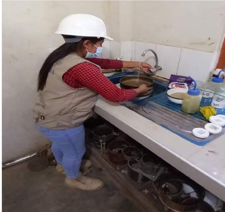
**Foto N° 22: Ensayo de peso específico y Absorción del agregado fino.**
