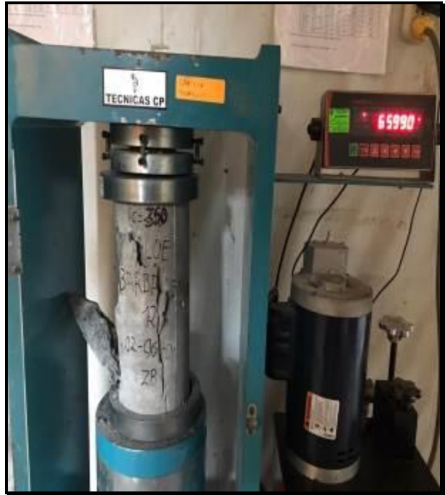
Fuente: Fotografías propias de laboratorio: Concreto f'_c=350\text{kg/cm}^2 , con incremento de Aloe Barbadensis 9% y 12%.
