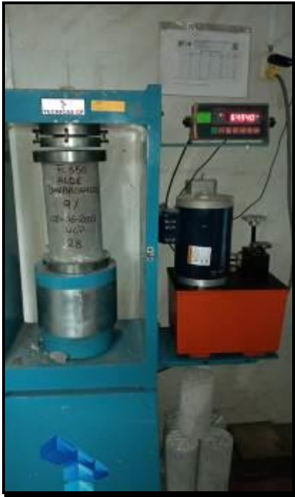
Fuente: Fotografías propias de laboratorio: Concreto f'_c=350\text{kg/cm}^2 , con incremento de Aloe Barbadensis 9% y 12%.
