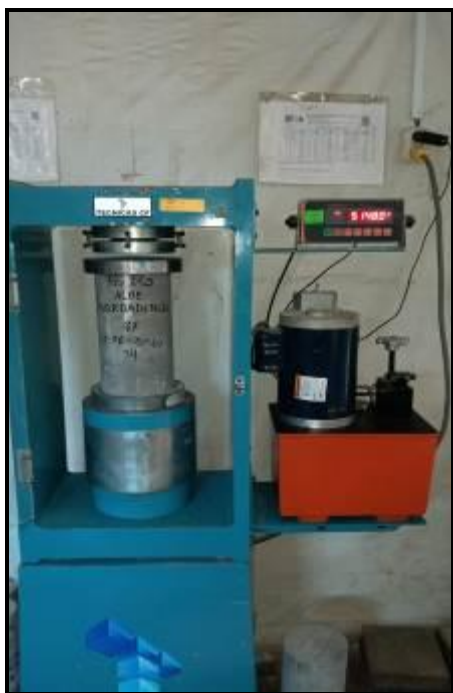
Fuente: Fotografías propias de laboratorio: Concreto f'c=350\text{kg/cm}^2 , con incremento de Aloe Barbadensis 9% y 12%.
