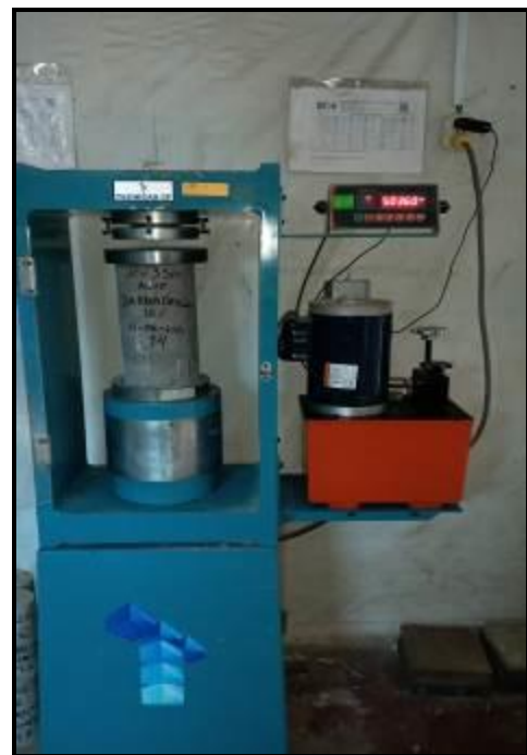
Fuente: Fotografías propias de laboratorio: Concreto f'c=350\text{kg/cm}^2 , con incremento de Aloe Barbadensis 9% y 12%.
