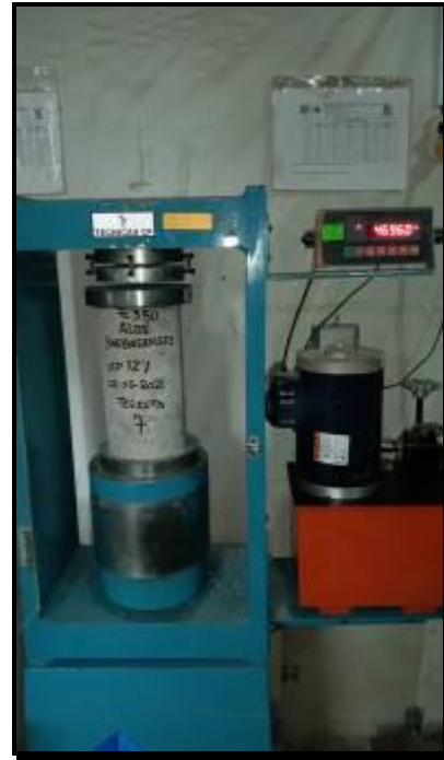
Fuente: Fotografías propias de laboratorio: Concreto f'c=350\text{kg/cm}^2 , con incremento de Aloe Barbadensis 9% y 12%.
