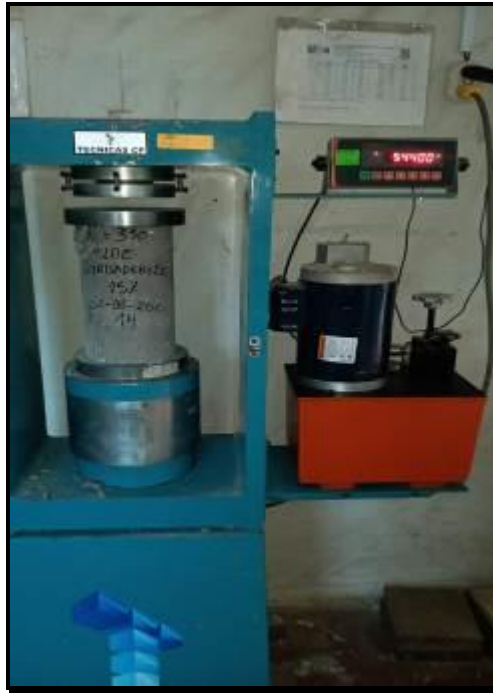
Fuente: Fotografías propias de laboratorio: Concreto f'c=350\text{kg/cm}^2 , con incremento de Aloe Barbadensis 15%
