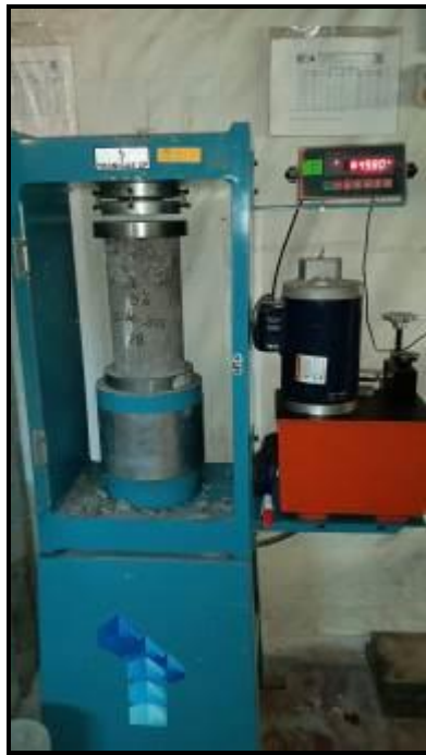
Fuente: Fotografías propias de laboratorio: Concreto f'_c=350\text{kg/cm}^2 , con incremento de Aloe Vera Barbadensis 15%.
