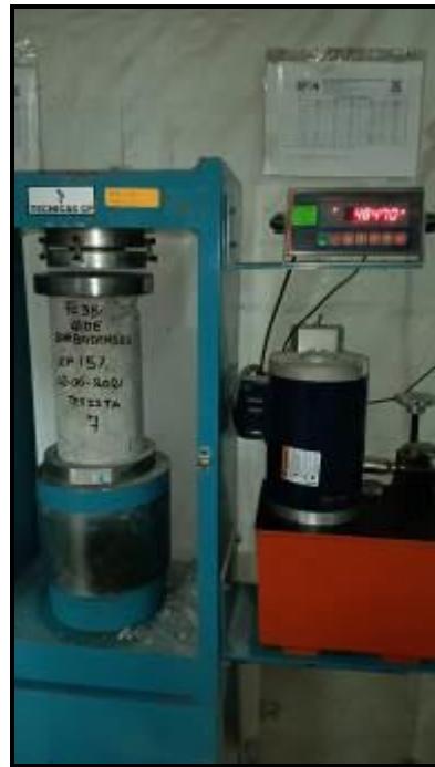
Fuente: Fotografías propias de laboratorio: Concreto f'c=350\text{kg/cm}^2 , con incremento de Aloe Barbadensis 15%.
