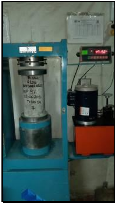
Fuente: Fotografías propias de laboratorio: Concreto f'c=350\text{kg/cm}^2 , con incremento de Aloe Barbadensis 9% y 12%.
