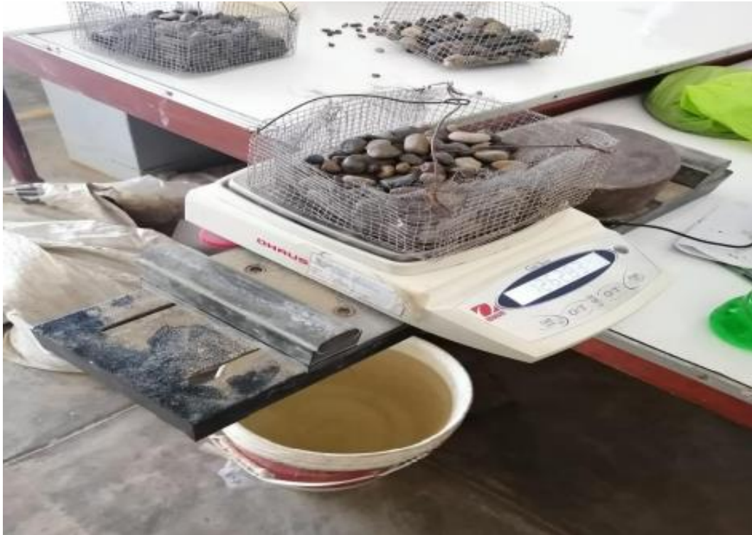
Peso específico, gravedad específica o densidad real; y, absorción de agregado grueso.
