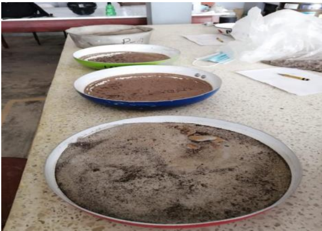
Peso específico, gravedad específica o densidad real; y, absorción de agregado fino.
