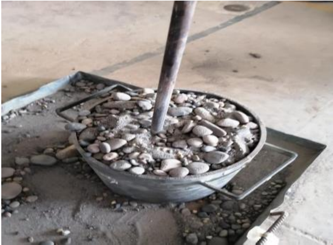
Peso Unitario Compactado del Agregado Global.
