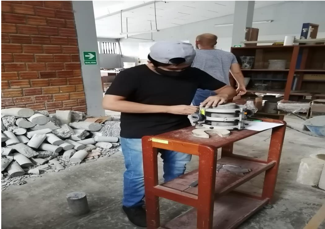
Colocación de probeta en anillos de extensómetro para Módulo de Elasticidad Estático.
