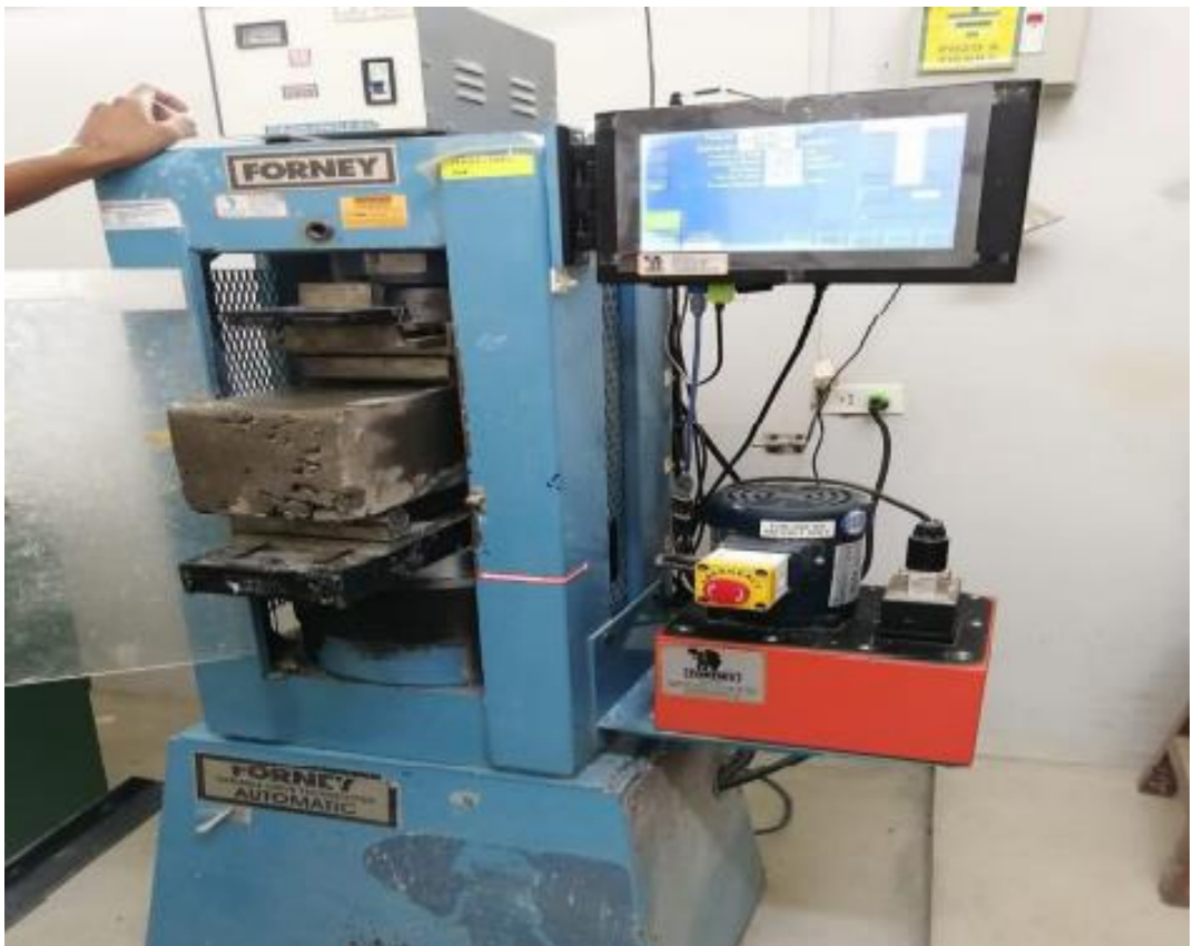
Prueba de Resistencia a la Flexión en Viga.
