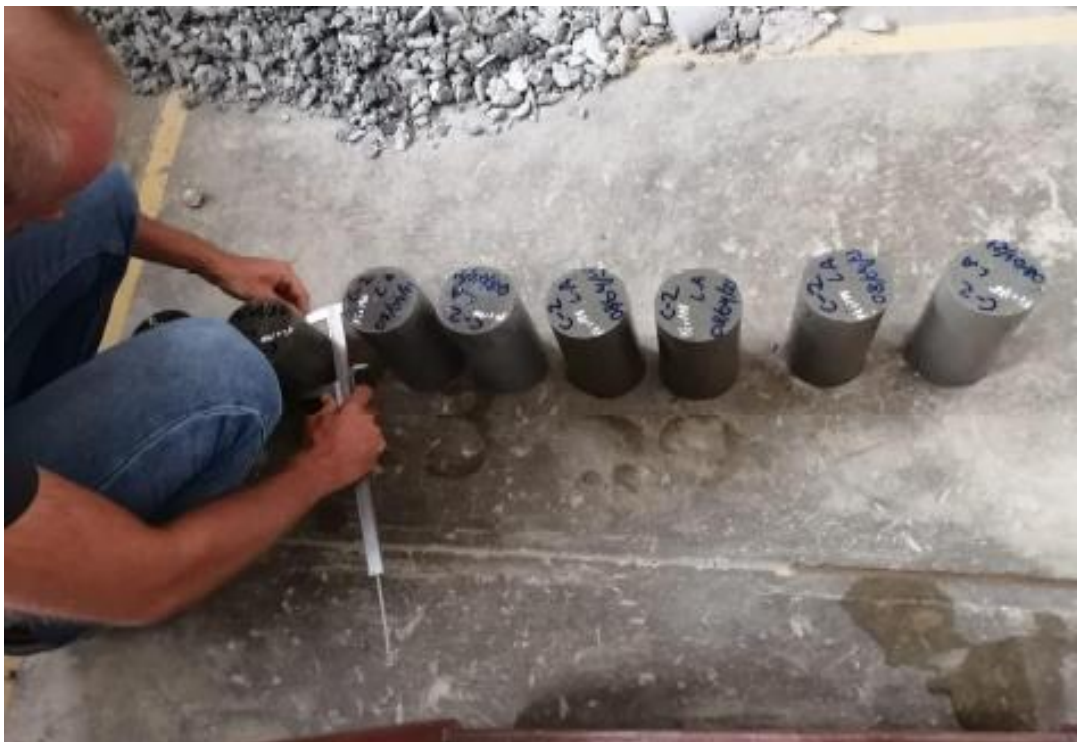
Preparación para la rotura de probetas.
