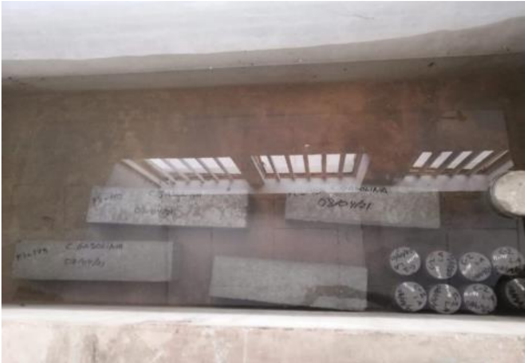
Curado de los testigos de concreto.
