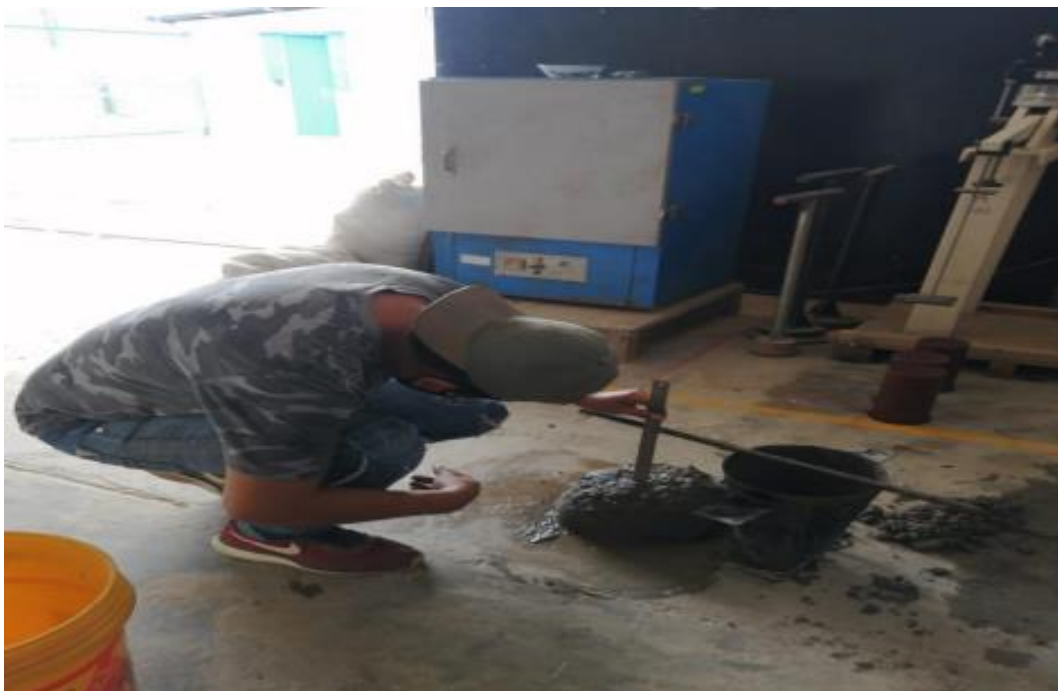
Prueba de Asentamiento.
