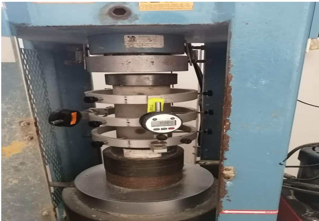
Prueba de Módulo de Elasticidad Estático.
