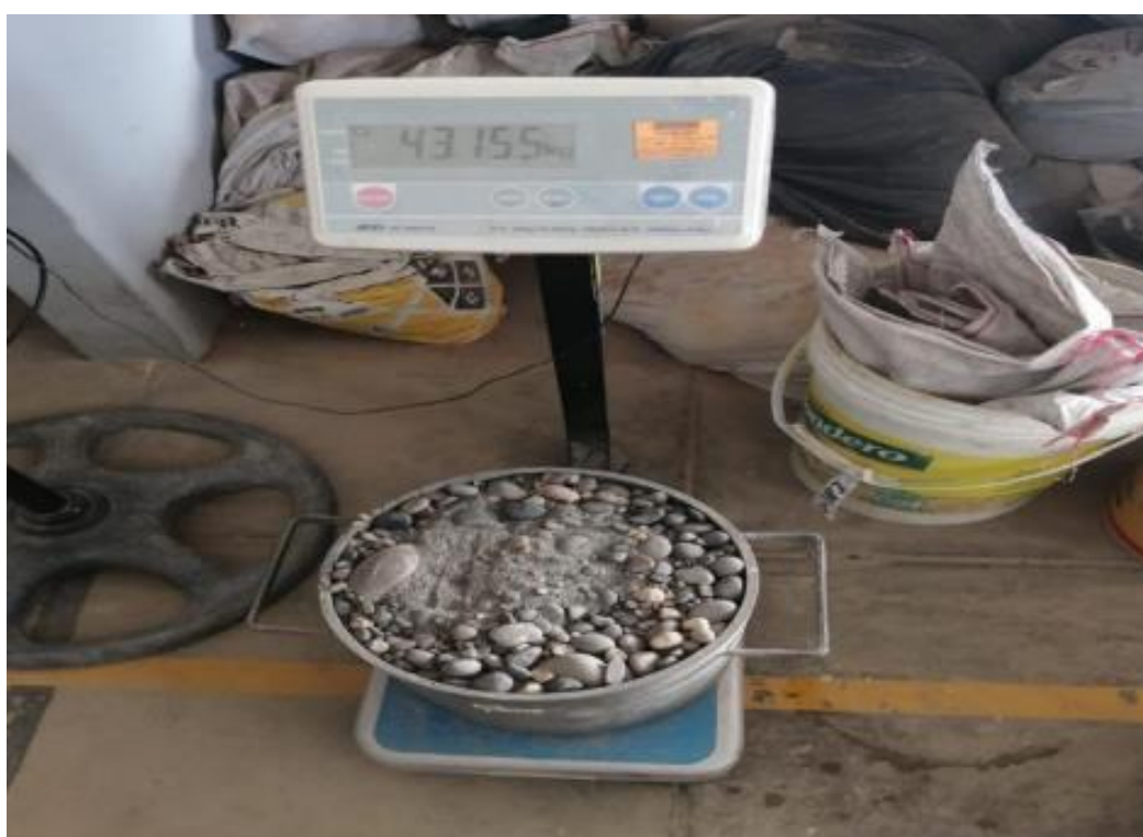
Peso Unitario Suelto del Agregado Global.
