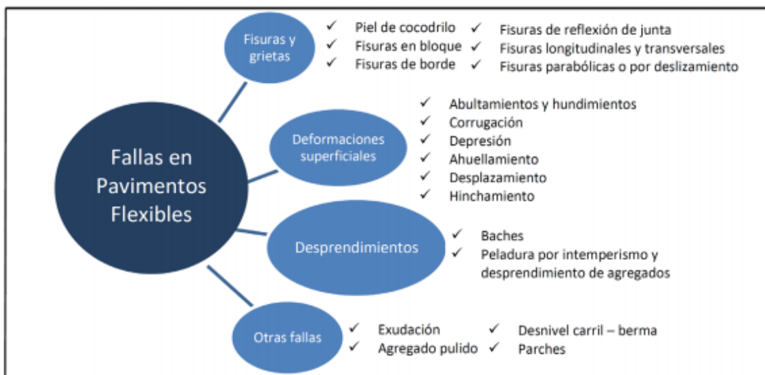
Ilustración 11: Resumen de fallas en pavimento flexible
