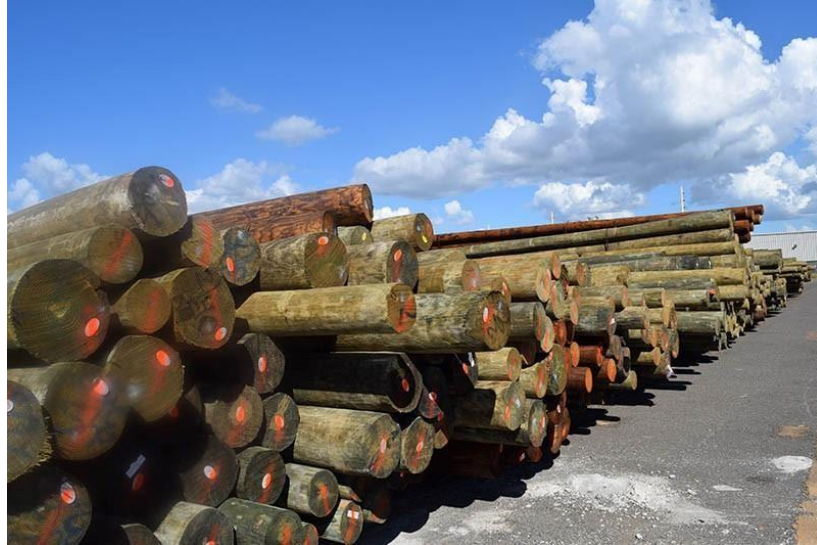
Figura 4. Pilotes de madera.
