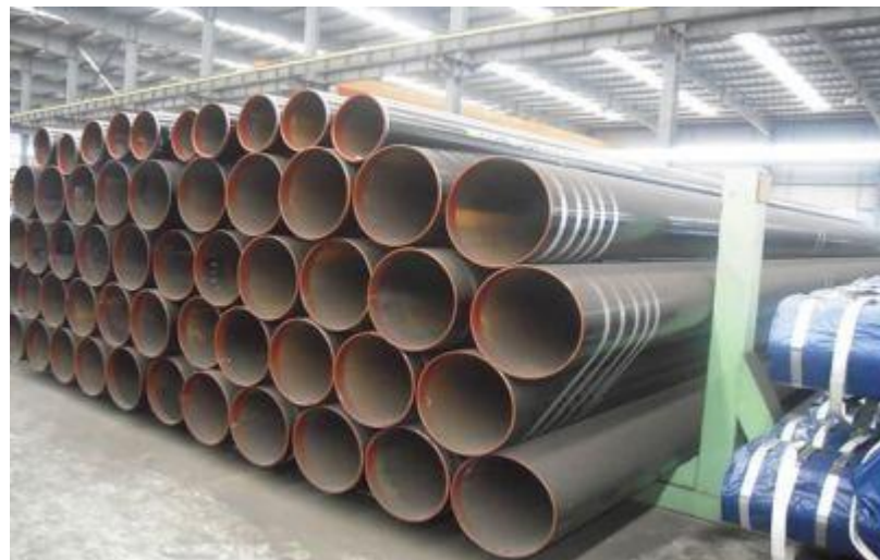
Figura 2. Pilotes de acero de perfiles tubulares.
