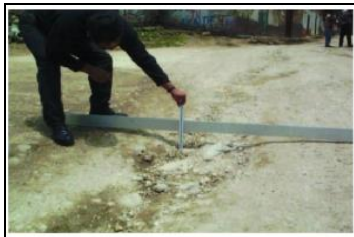
Ilustración 6: Profundidad \geq 10 cm
