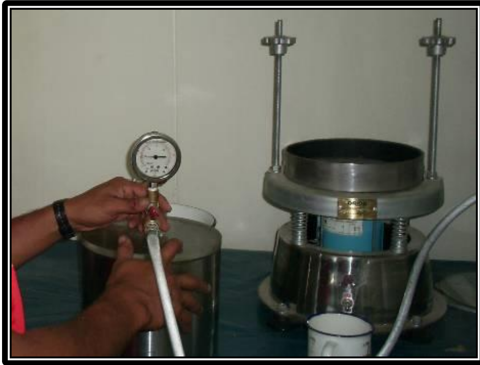
Imagen 3: Ensayo Rice (Máxima Densidad Teórica).
