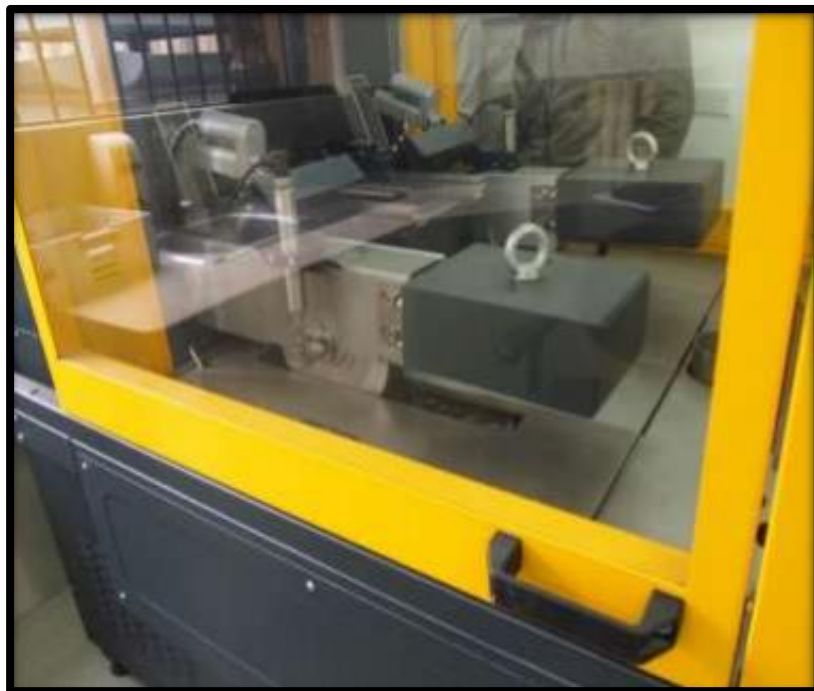
Ilustración 13: Máquina de Ensayo Hamburg Wheel-Tracking Device (HWTD)
