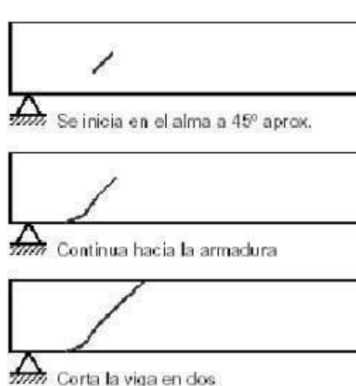
Figura 9: Detalles de la evolución de una fisura de esfuerzo cortante
