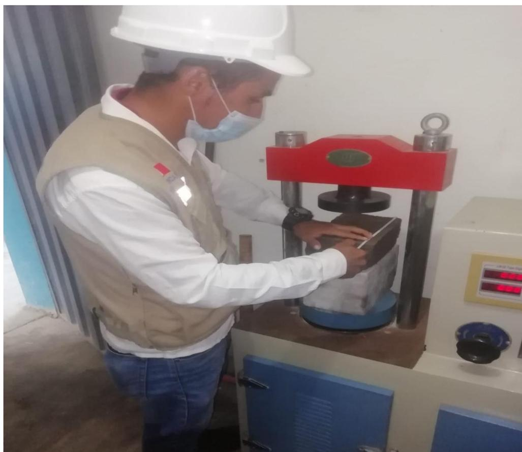
Foto 06: Colocación del adobe en el equipo de rotura
