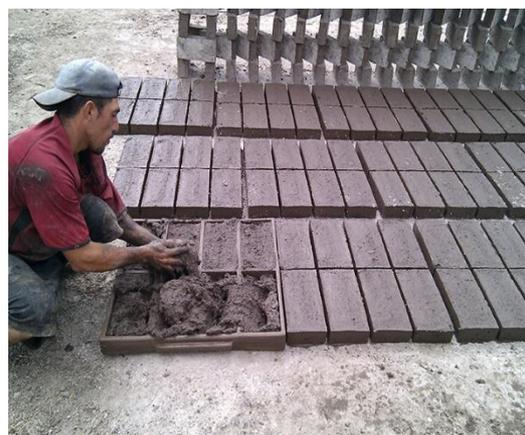
Figura 2. Fabricación de adobes con material paja y material plástico
