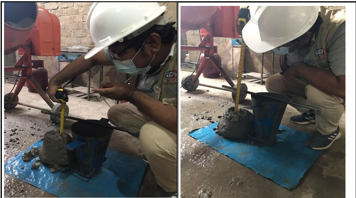
Fotos nº 11-12: En las imágenes podemos observar al personal realizando la prueba de asentamiento para los diseños de Mezclas.
