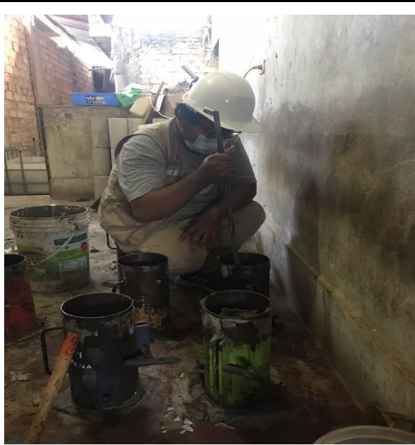
Fotos nº 13-14: En las imágenes podemos observar al personal realizando el moldeo de los testigos de concreto.
