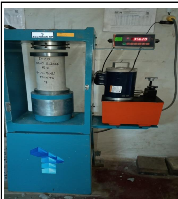
Fotos nº 15-16: En las imágenes podemos observar la resistencia a la compresión axial de los testigos de concreto
