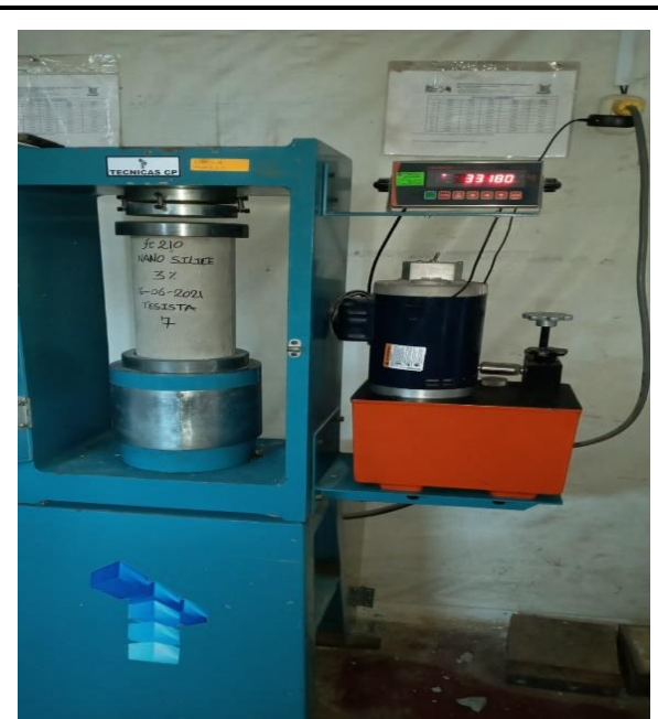
Fotos nº 15-16: En las imágenes podemos observar la resistencia a la compresión axial de los testigos de concreto
