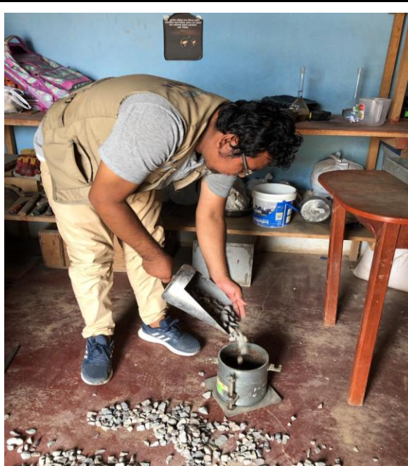
Fotos nº 05-06: En las imágenes podemos observar realización del ensayo de peso unitario.
