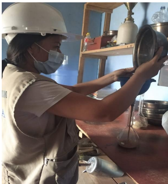
Fotos nº 07-08: En las imágenes podemos observar realización del ensayo de peso específico.
