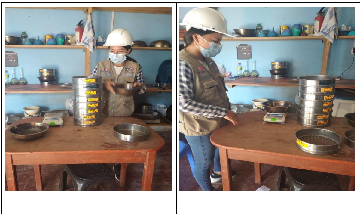
Fotos n° 03-04: En las imágenes se puede apreciar el ensayo de análisis granulométricos.
