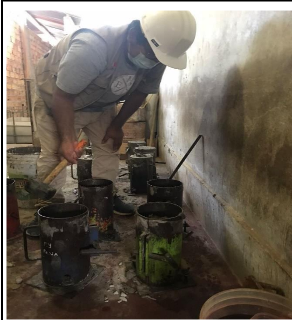
Fotos nº 13-14: En las imágenes podemos observar al personal realizando el moldeo de los testigos de concreto.
