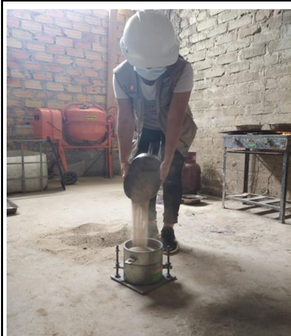
Fotos nº 05-06: En las imágenes podemos observar realización del ensayo de peso unitario.
