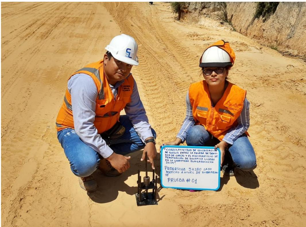
**FOTO. 13 REALIZACION DE LA PRUEBA 1 CON EL EQUIPO DE MMPDL**
