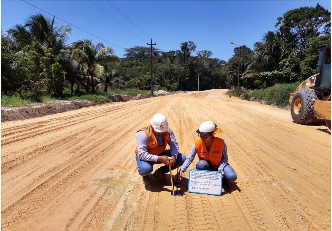
**FOTO. 3 TOMA DE LA PRIMERA MUESTRA DEL ENSAYO**
