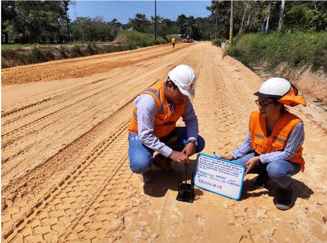
**FOTO. 8 PRUEBA DE ENSAYO CON EL MMPDL**
