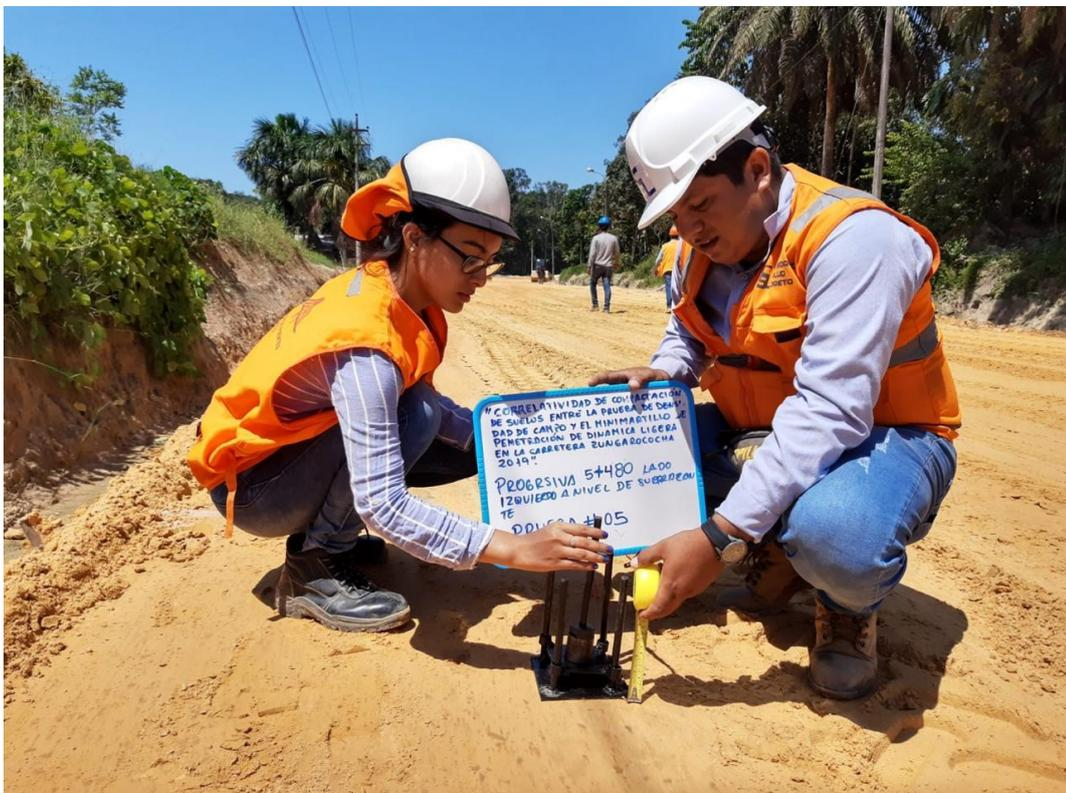
**FOTO. 15 REALIZACION DE LA PRUEBA CON EL EQUIPO DE MMPDL Y SU RESPECTIVA MEDICION DE CUANTO FUE LA PENETRYRACION DE LA VARILLA**
