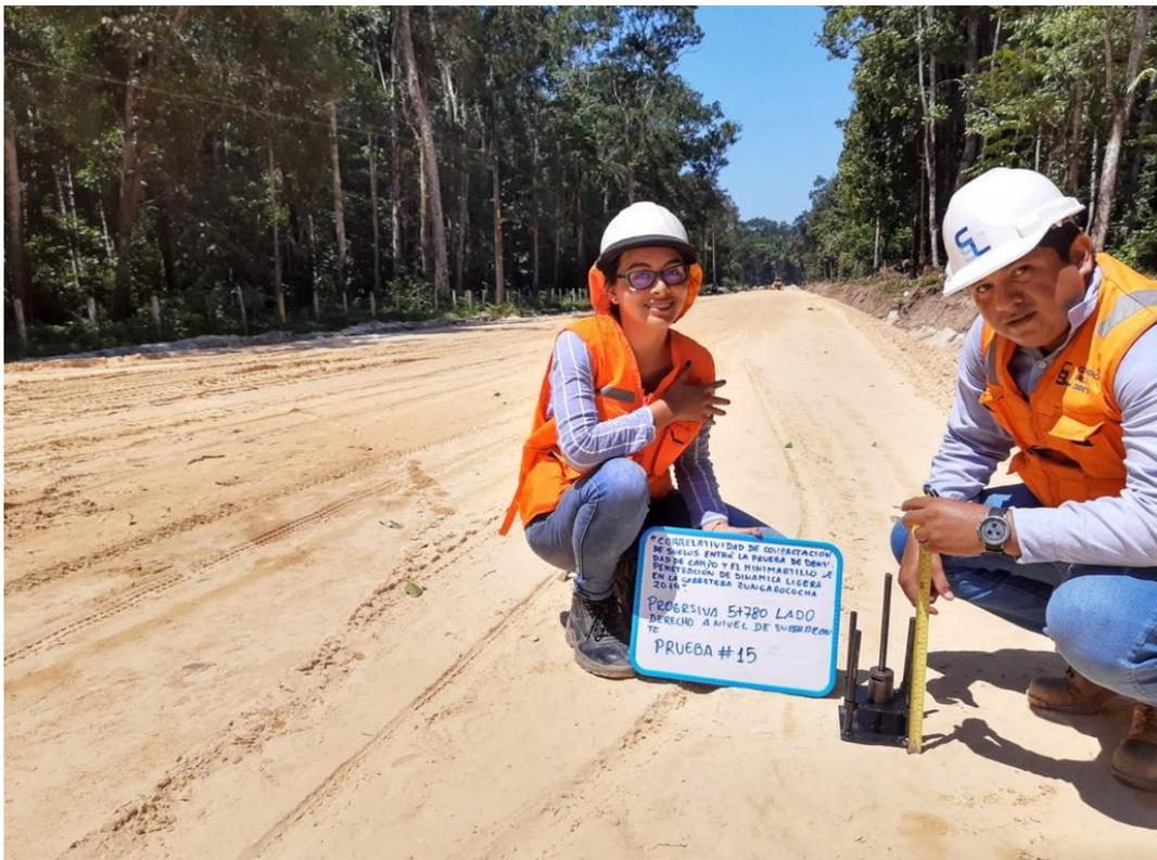
**FOTO. 9 LOS TESISISTAS REALIZANDO EL NUMERO DE PRUEBA 15 CON EL MMPDL**
