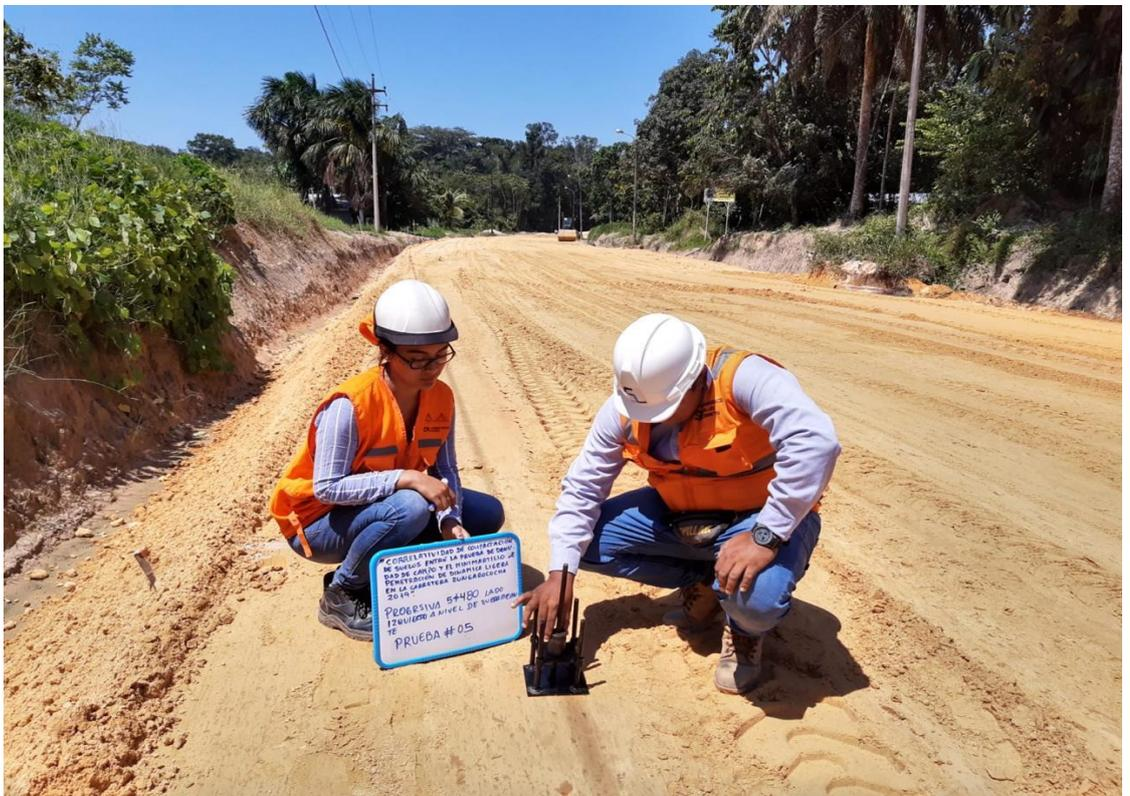
**FOTO. 4 PRUEBA DE ENSAYO N°5 CON EL MMPDL**
