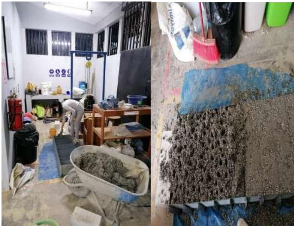
Foto 6. De Izquierda a derecha y abajo: Colocación de la mezcla en los moldes.
