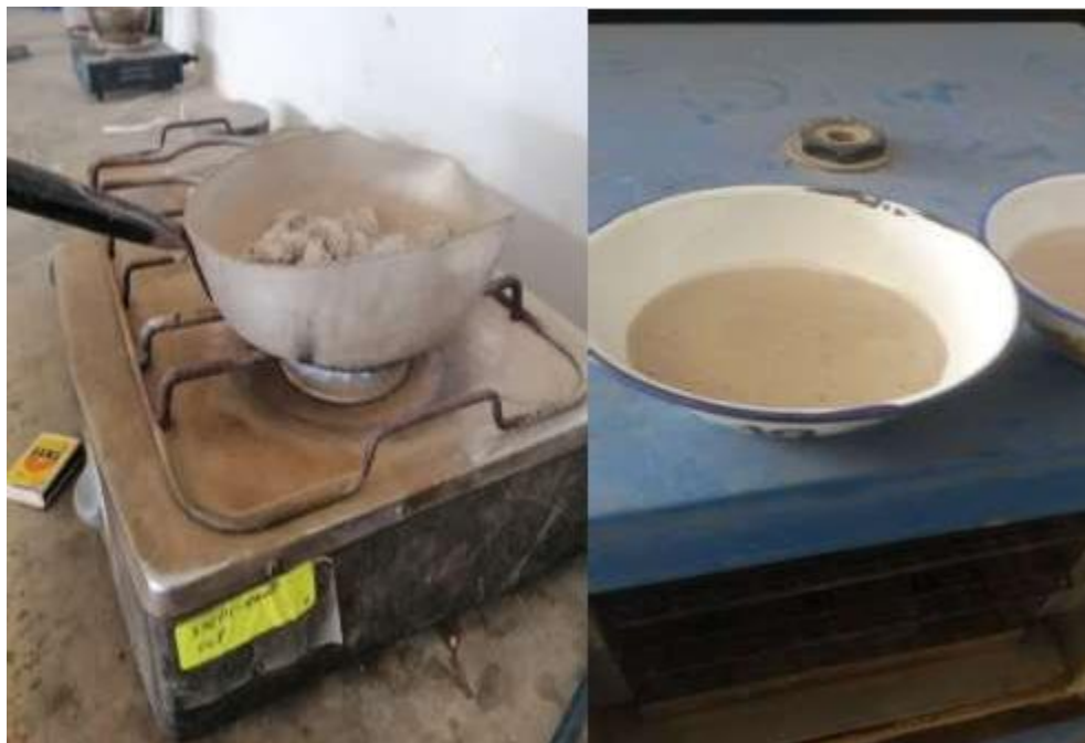
Foto 2. Se procede a calentar la arena para poder encontrar el % del contenido de humedad de la arena y de esa manera poder hacer las correcciones por humedad.
