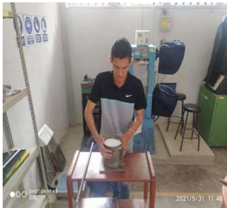
Foto 9. Ensayo PUS de los agregados utilizados
