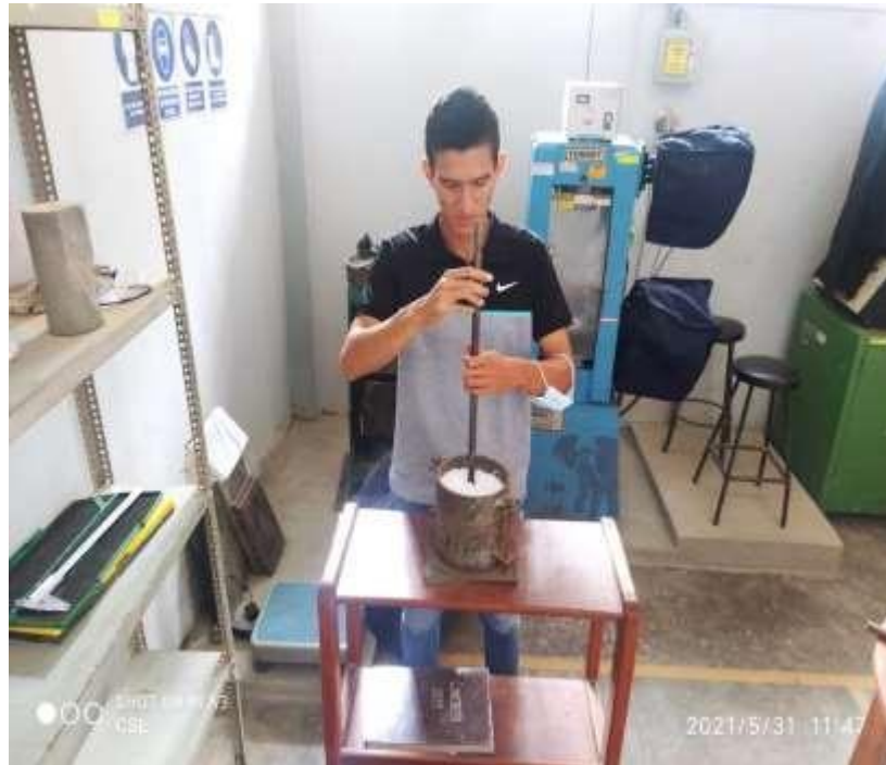
Foto 10. Ensayo de PUC de los agregados utilizados
