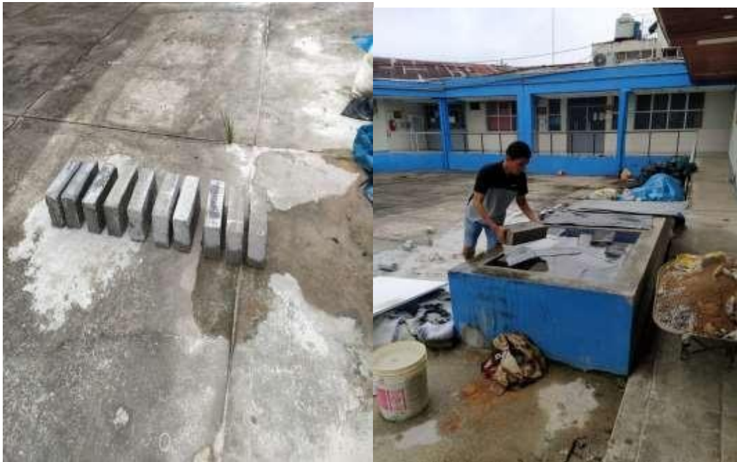
Foto 8. Terminando los 7 días se sacaron los bloques de la fosa y se esperó un tiempo de 24 horas para poder medir sus dimensiones.
