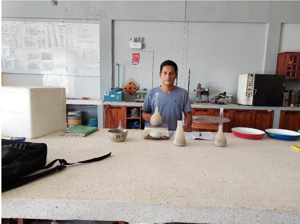
FOTO N° 08: Vaciado de muestras saturas para el ensayo de absorción del agregado fino
