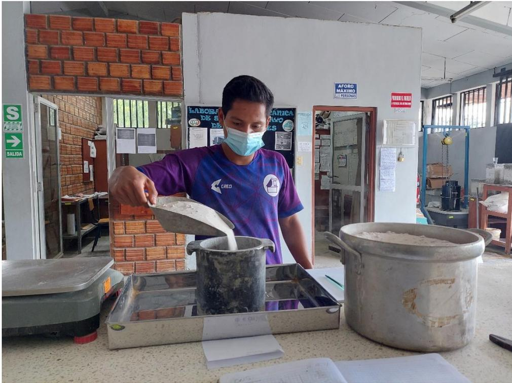
FOTO N° 16: Ensayo de peso unitario compactado
