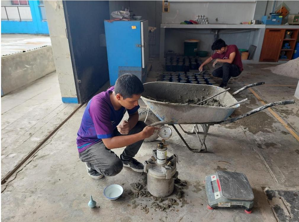
FOTO N° 28: Registro de la temperatura de la mezcla de concreto cemento – arena.
