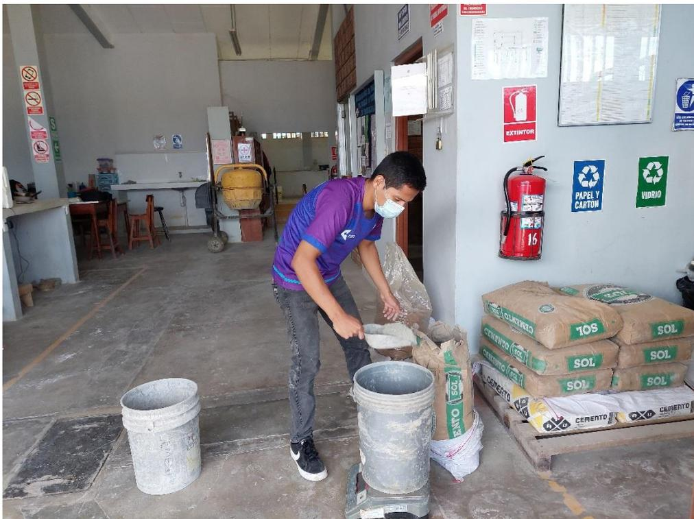
FOTO N° 21: Pesado del agregado fino (arena color blanco) para el diseño de mezcla
