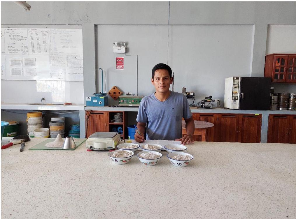
FOTO N° 03: Preparación de muestra para el ensayo de peso específico y absorción
