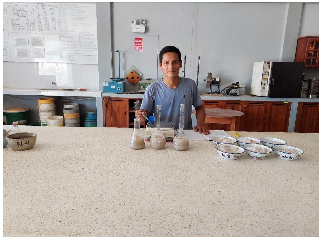
FOTO N° 07: Pesado de muestras después del reposo y llenado de agua hasta el punto de calibración de los frascos.
