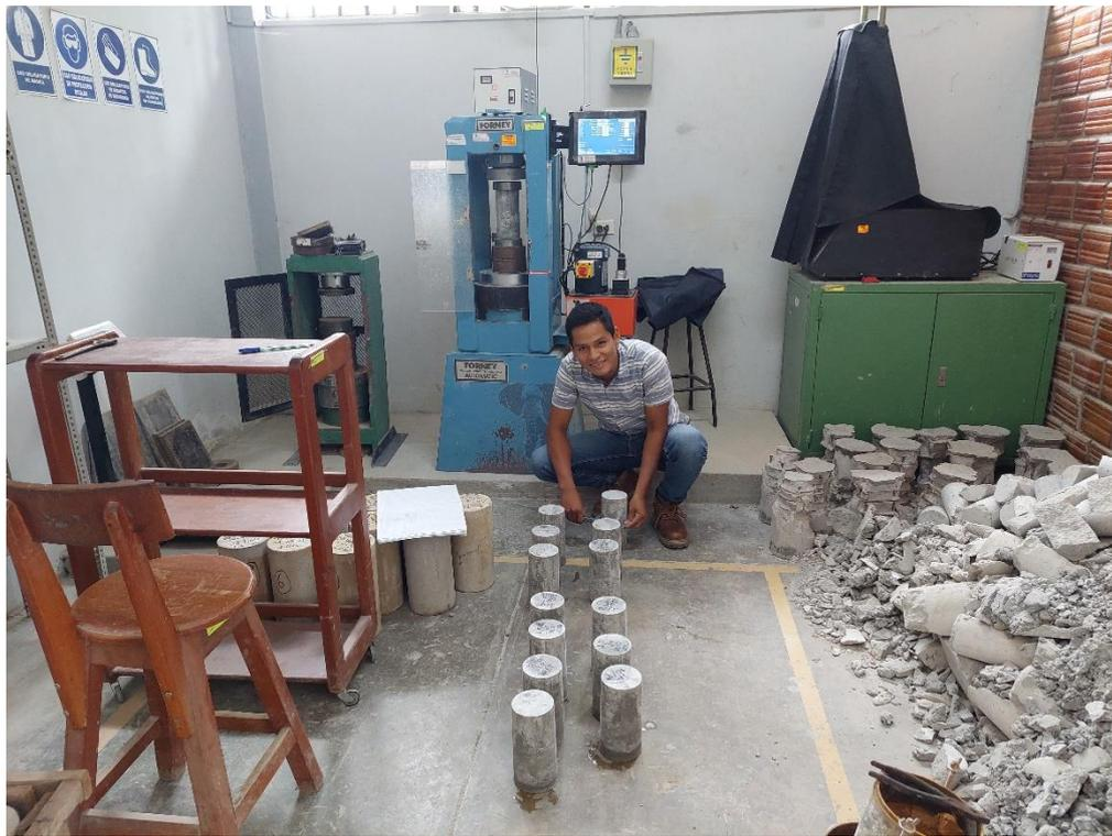
FOTO N° 38: Ensayo de resistencia a la compresión de la probeta de 4 x 8 pulg.
