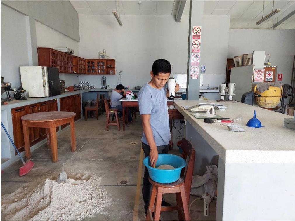
FOTO N° 04: Punto óptimo del agregado fino para el ensayo de peso específico en su condición Saturado Superficialmente Seco (SSS)
