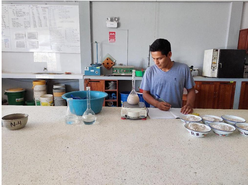
FOTO N° 06: Muestras ensayadas para el peso específico
