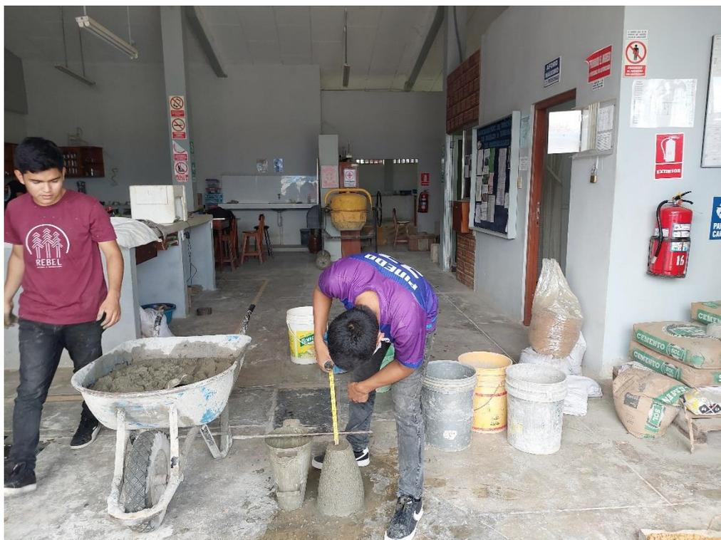
FOTO N° 25: Ensayo de peso unitario de la mezcla de concreto cemento – arena.
