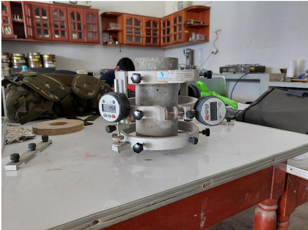
FOTO N° 42: Ensayo de módulo de elasticidad
