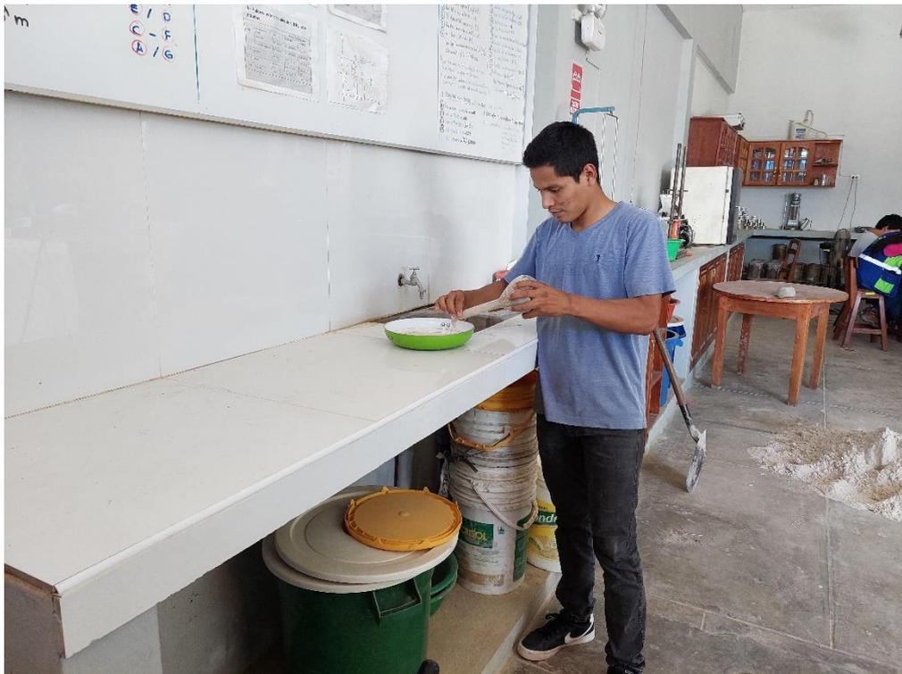
FOTO N° 09: Pesado y registro de datos para el ensayo de absorción.
