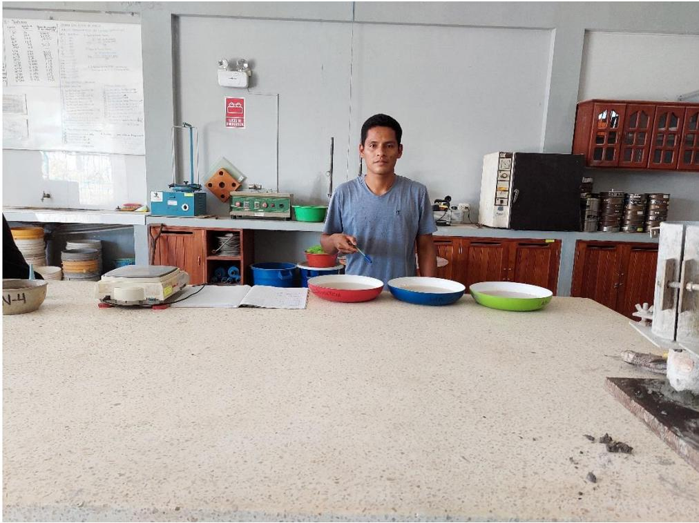
FOTO N° 10: Colocación de muestras para el respectivo secado del ensayo de absorción
