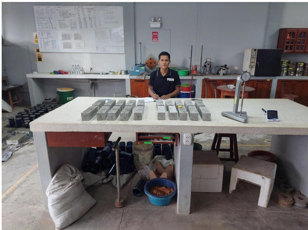
FOTO N° 37: Registro de diámetros de las probetas para su posterior ensayo
