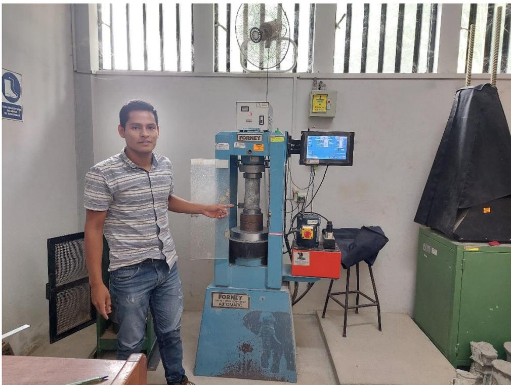
FOTO N° 39: Ensayo de tracción por compresión diametral.
