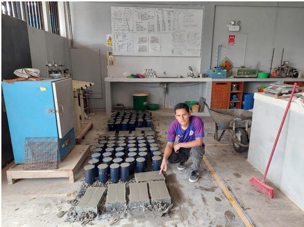
FOTO N° 31: Desencofrado de los moldes cilíndricos y prismáticos después de las 24 horas de vaciado.
