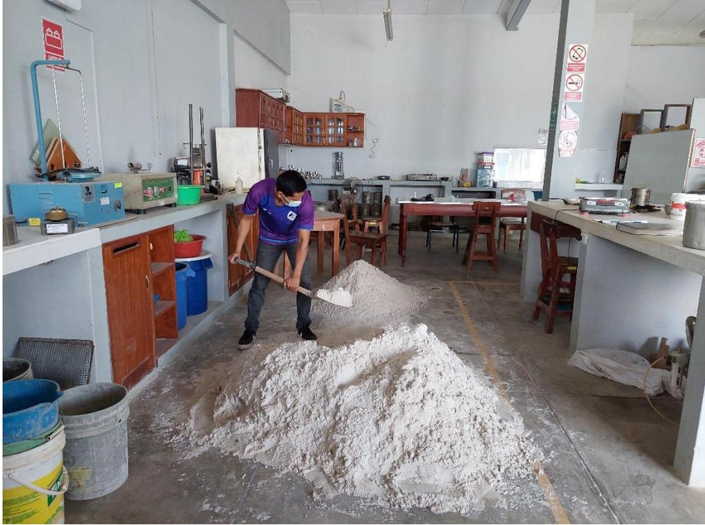
FOTO N° 02: Pesado y separación de muestra para el ensayo de granulometría, lavado y peso específico.
