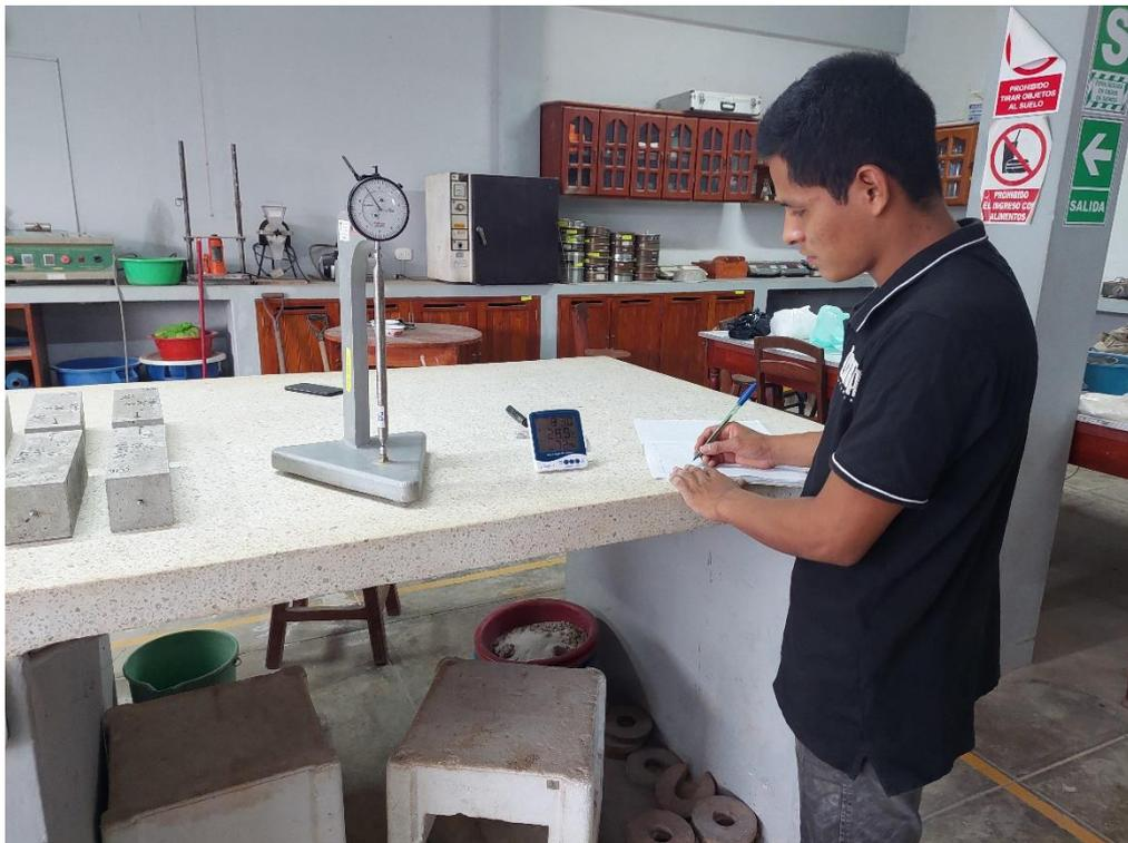
FOTO N° 35: Lectura y registro del cambio de longitud en los prismas de concreto cemento – arena.
