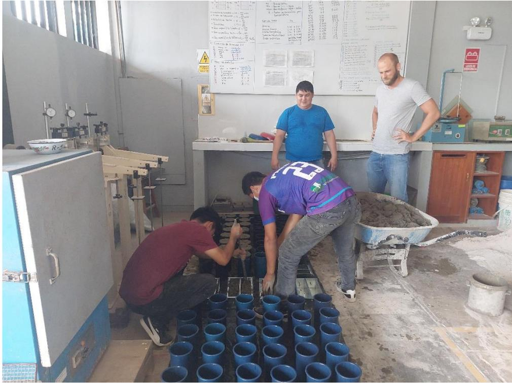
FOTO N° 30: Enrasado de la mezcla para su posterior fraguado.
