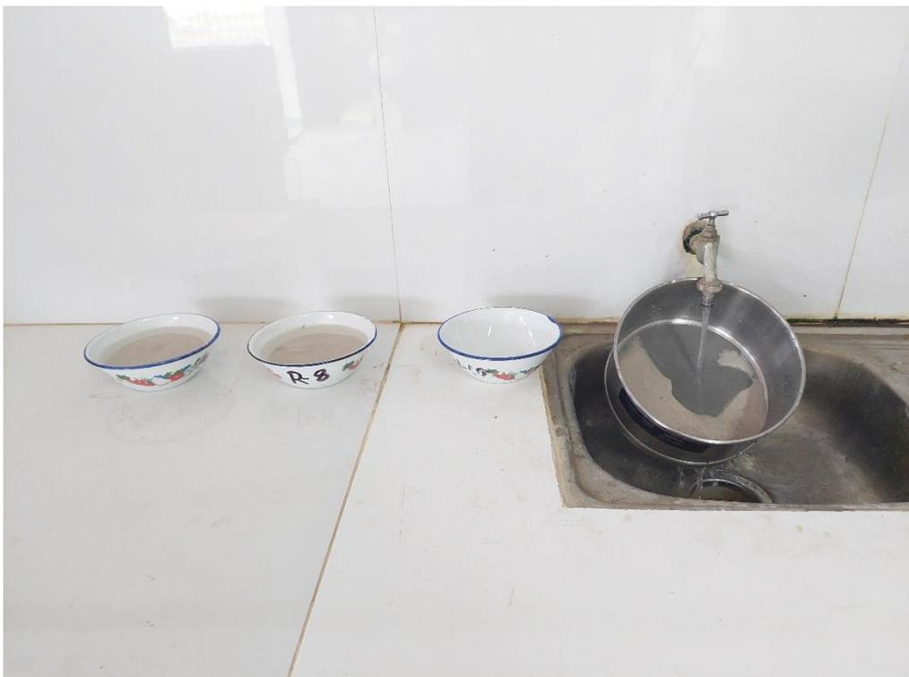
FOTO N° 13: Lavado de muestras para el ensayo de análisis granulométrico
