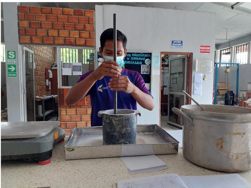
FOTO N° 17: Registro de datos para los ensayos de peso unitario suelto y compactado.
