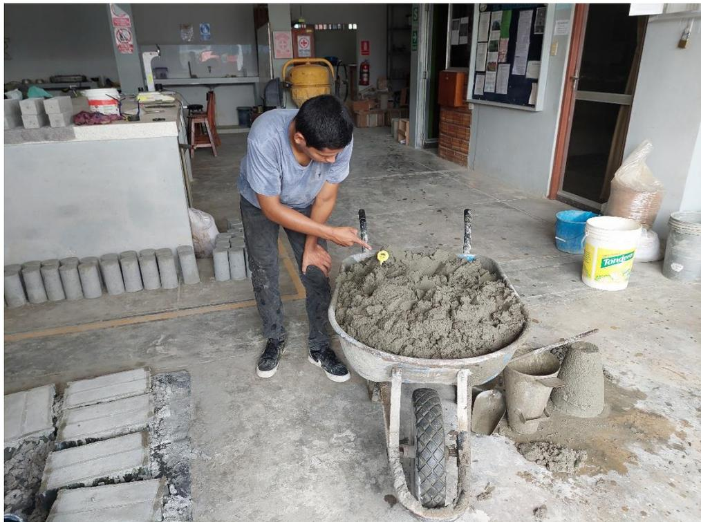
FOTO N° 29: Vaciado de la mezcla de concreto cemento – arena, en los moldes cilíndricos y prismáticos
