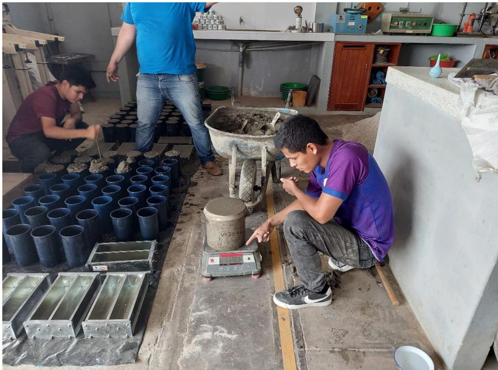
FOTO N° 27: Ensayo de contenido de aire en la mezcla de concreto cemento – arena.
