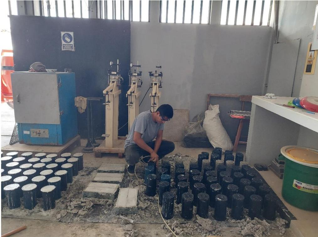
FOTO N° 32: Curado de las probetas para sus respectivos ensayos
