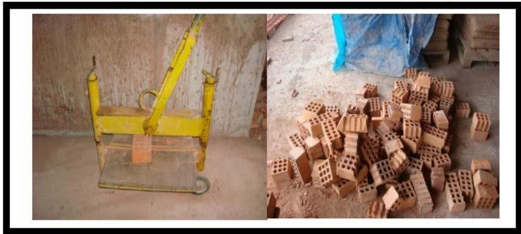
Figura 12. Proceso de corte de unidades de ladrillo
