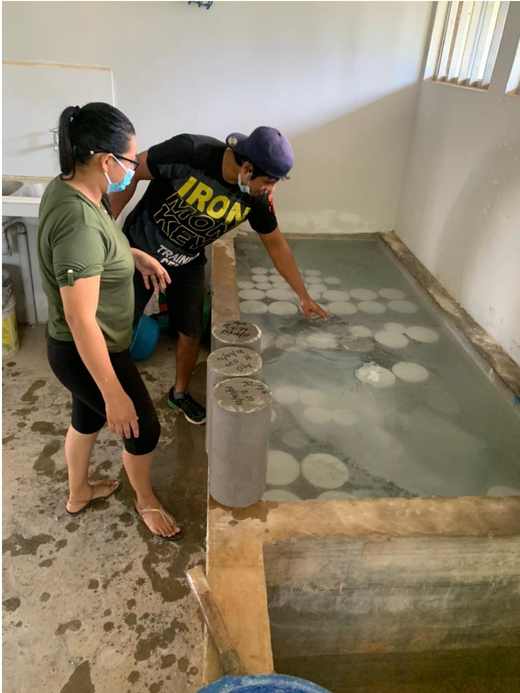
Curado de los testigos del concreto.
