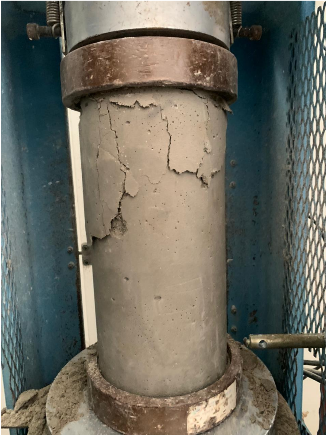
Resistencia a la compresión – molde de 15 cm de diámetro.
