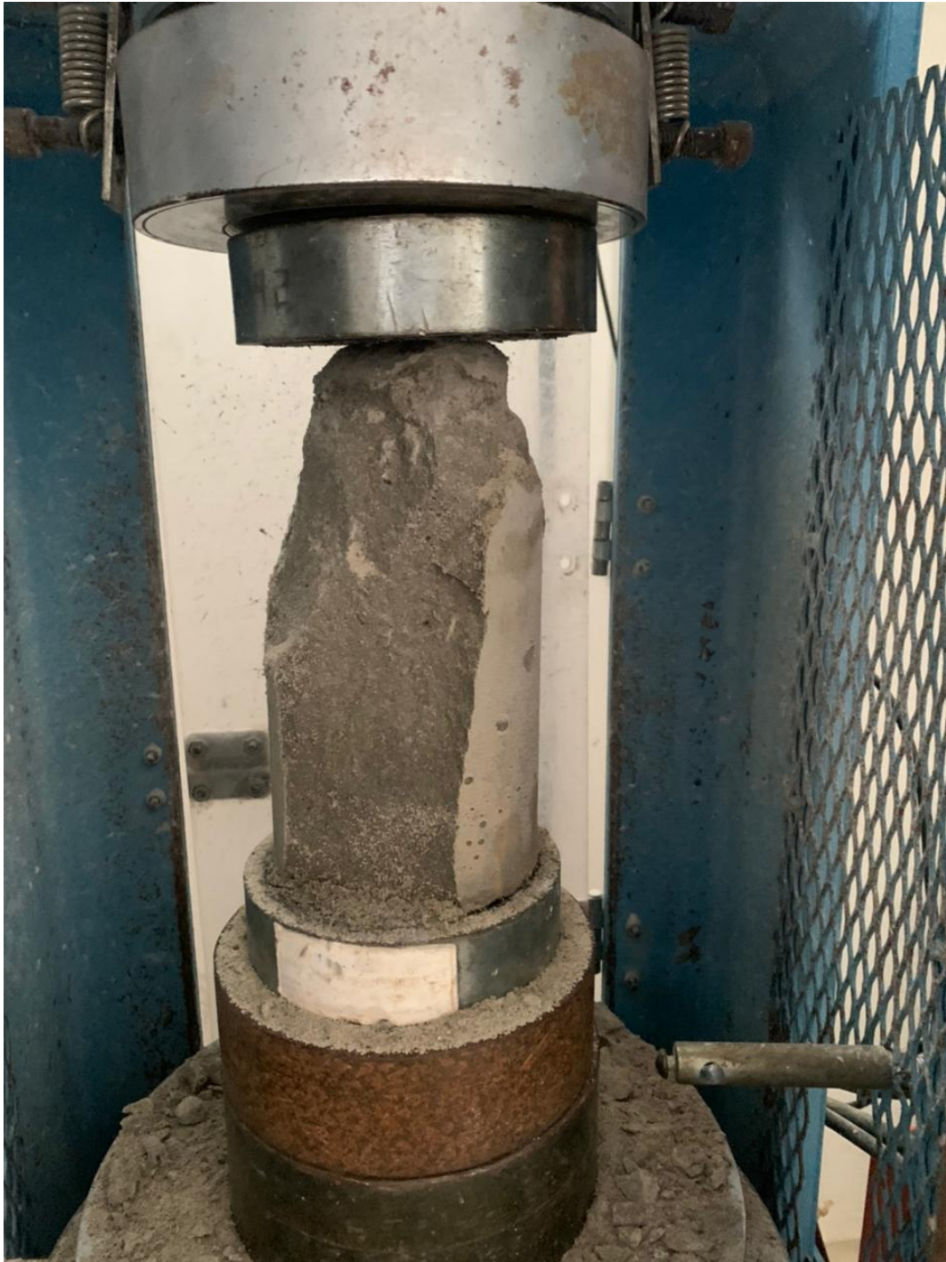
Resistencia a la compresión – molde de 10 cm de diámetro.
