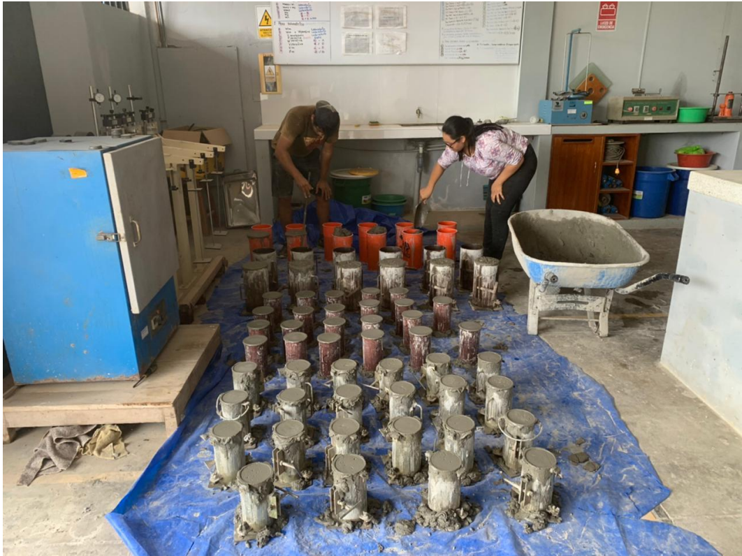
Preparación de los testigos dentro de los moldes de acero y plástico.
