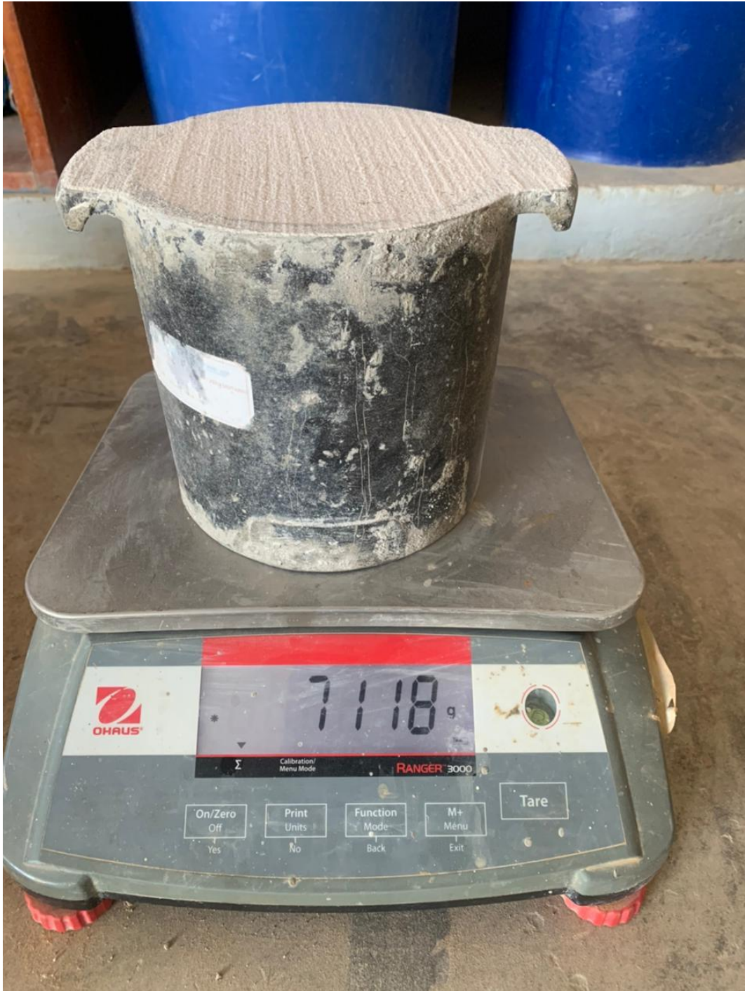
Ensayo de peso unitario del agregado fino.
