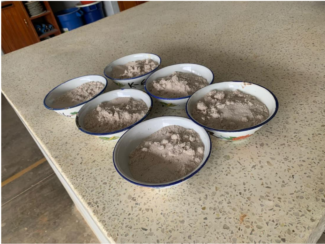
Muestras del agregado fino para los ensayos de análisis granulométrico y pasante de la malla n°200
