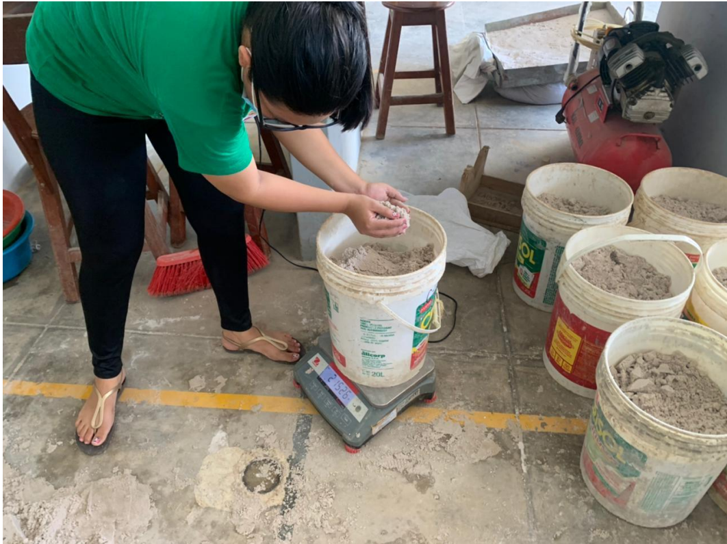
Pesaje del agregado fino para realización de la mezcla.
