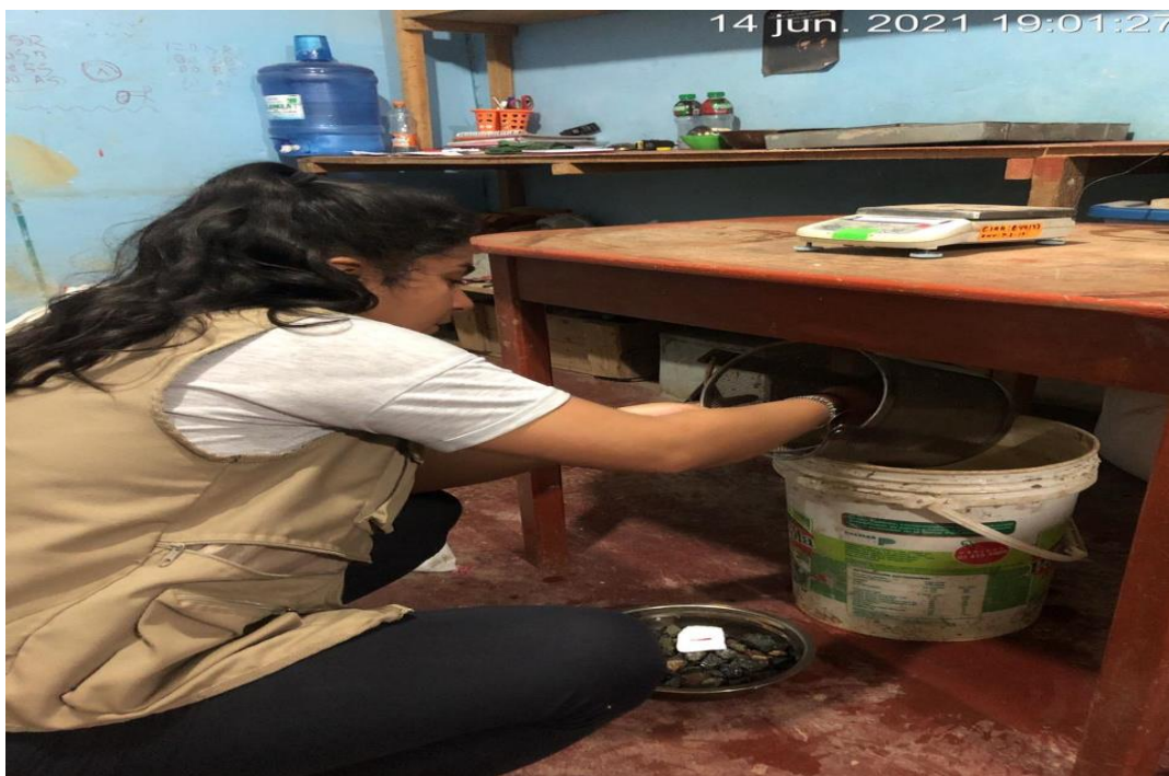
Fotografía N°10: Se puede apreciar el ensayo de peso específico.
