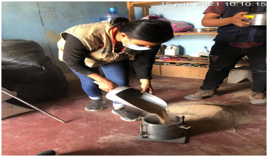
Fotografía N°7: Se puede apreciar el ensayo de peso unitario.
