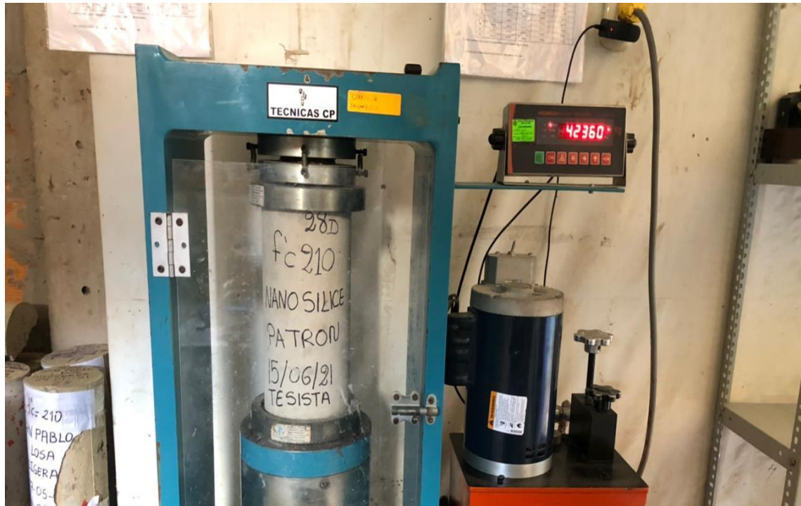
Fotografía N°21: Rotura de resistencia de concreto.
