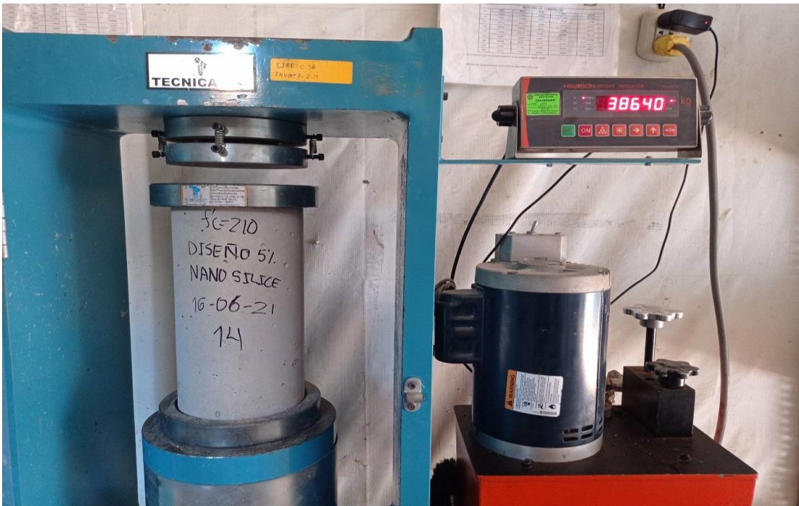
Fotografía N°20: Rotura de resistencia de concreto.
