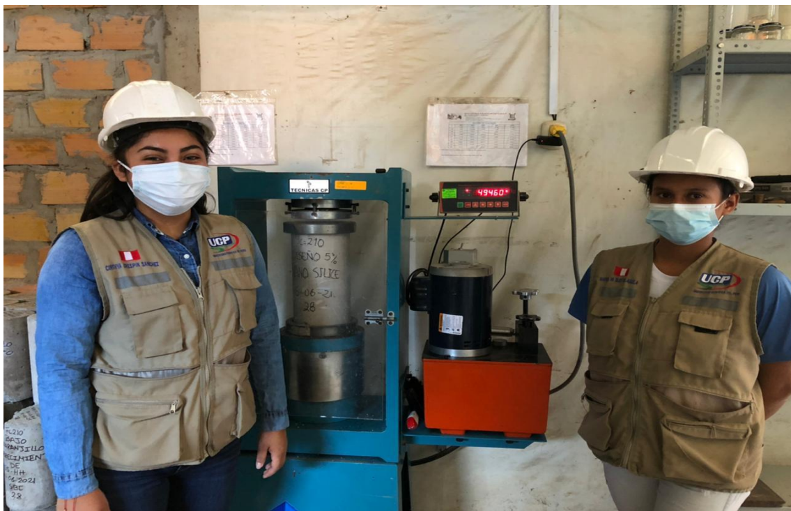
Fotografía N°22: Rotura de resistencia de concreto.
