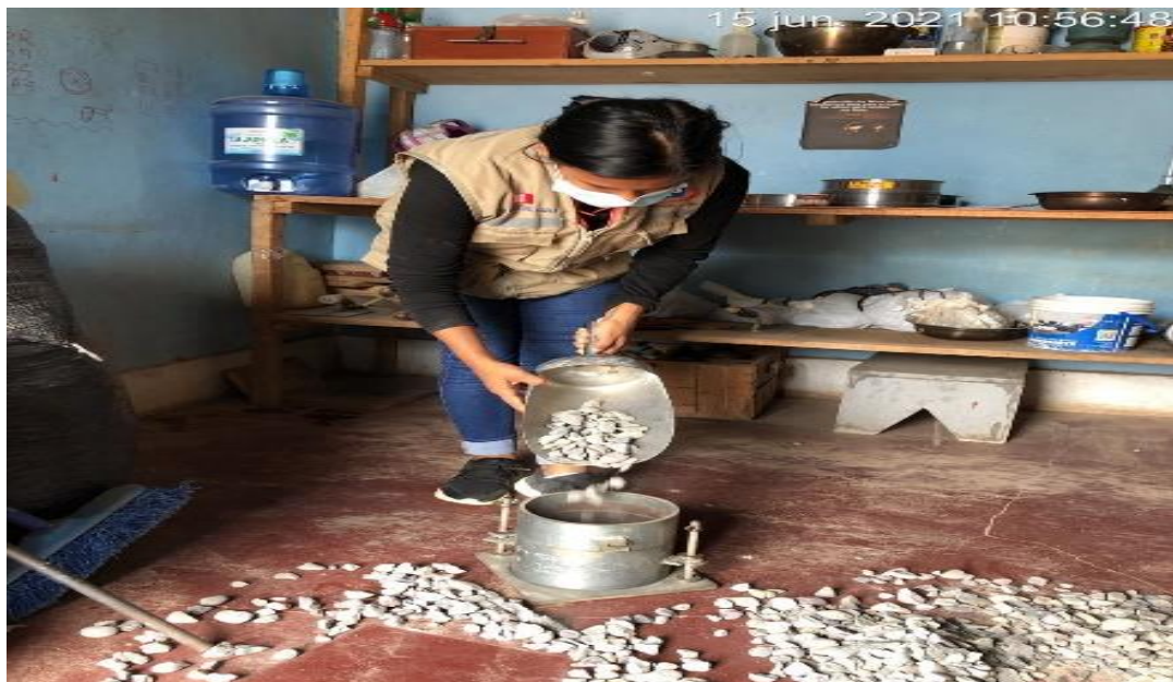
Fotografía N°8: Se puede apreciar el ensayo de peso unitario.
