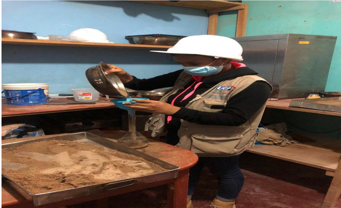
Fotografía N°9: Se puede apreciar el ensayo de peso específico.
