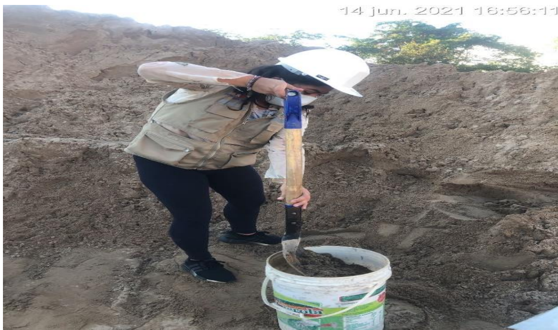
Fotografía N°2: Se puede apreciar el muestreo en cantera de los agregados para la realización del diseño.
