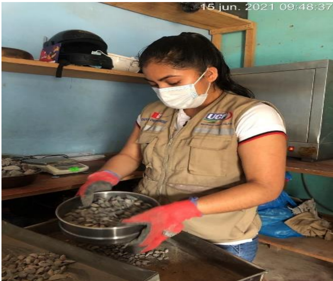
Fotografía N°6: Se puede apreciar el ensayo de análisis granulométrico
