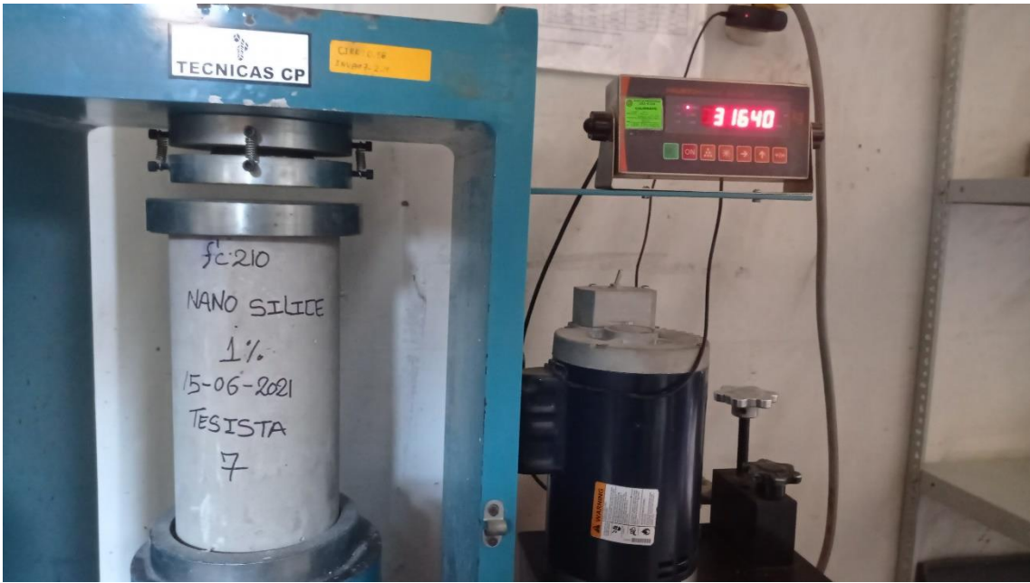
Fotografía N°17: Rotura de resistencia de concreto.
