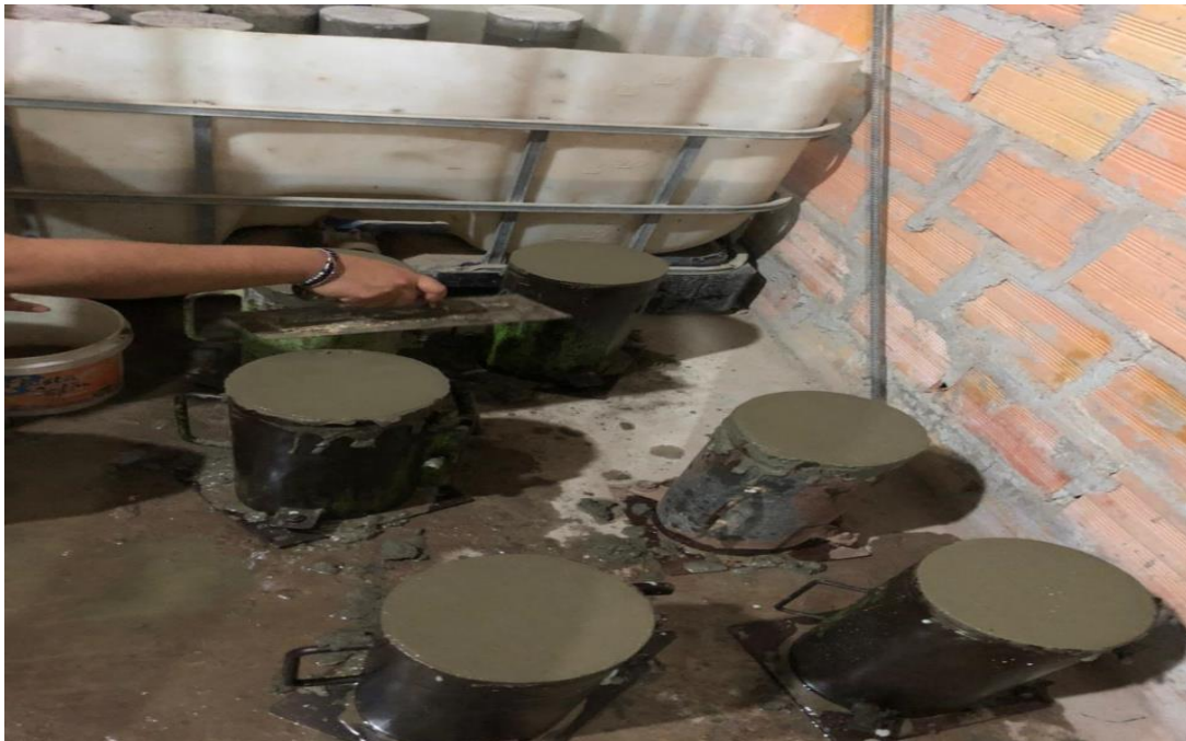
Fotografía N°16: Testigos de concretos moldeados.
