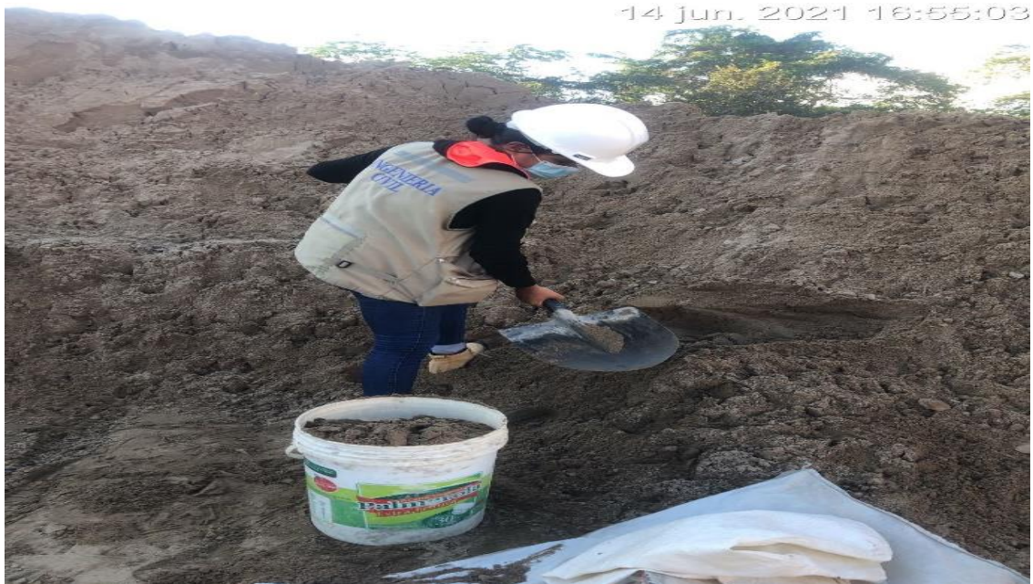
Fotografía N°1: Se puede apreciar el muestreo en cantera de los agregados para la realización del diseño.
