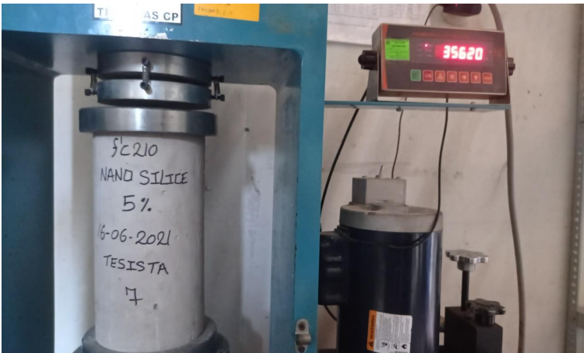
Fotografía N°18: Rotura de resistencia de concreto.
