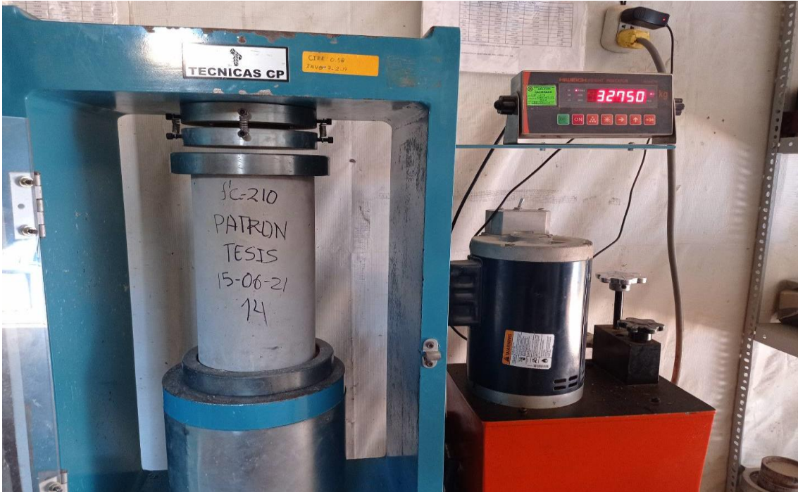
Fotografía N°19: Rotura de resistencia de concreto.
