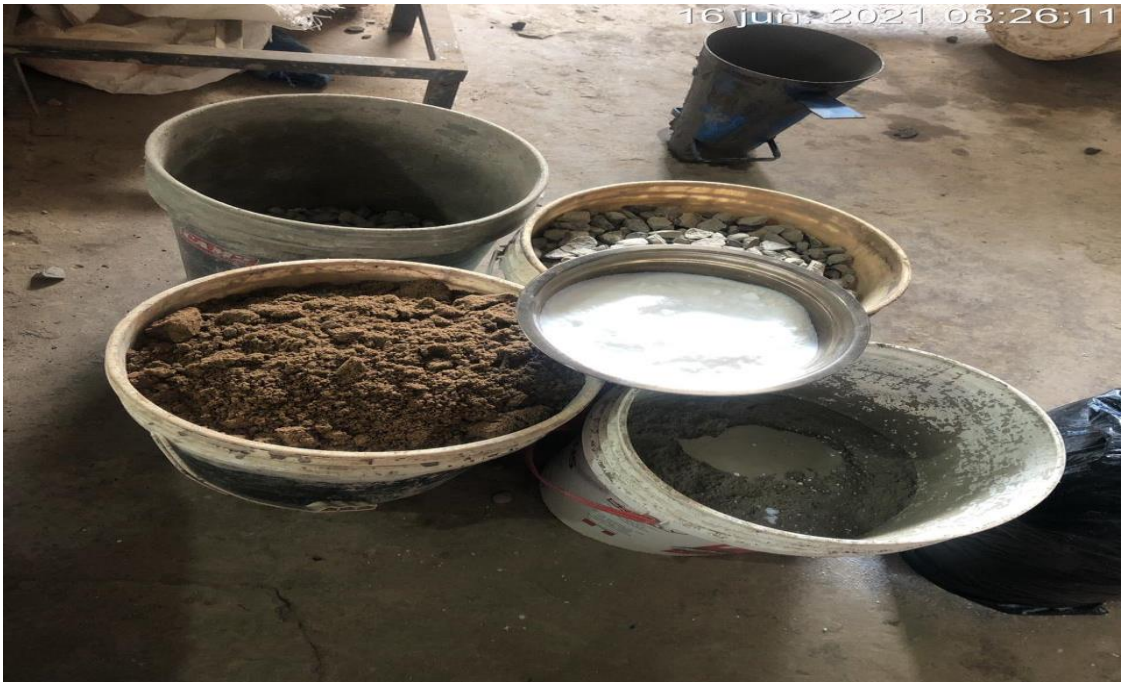
Fotografía N°11: Materiales utilizados para la realización de los diseños de concretos con adición de nanosílice.
