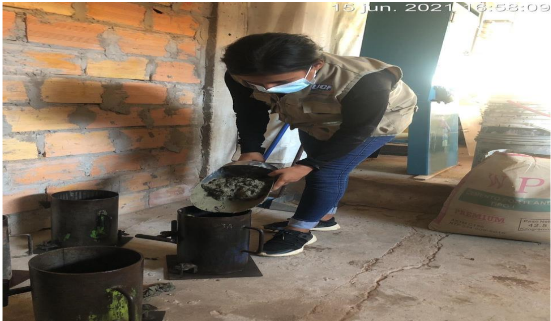
Fotografía N°15: Moldeos de los testigos de concreto.
